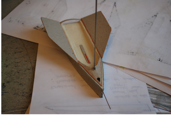
Konsoll i midten av båten med senkekjøl og mulig spor til rosete og fotstøtte.
