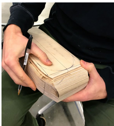
Arbeid med en skalamodel av skroget i treverk, laget for å vaku- umtrekke plastisk over
