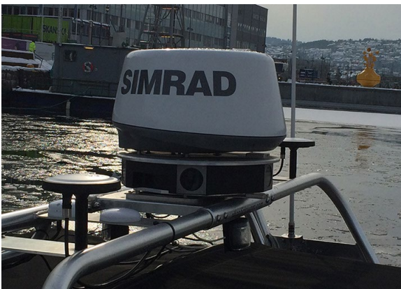
Sensorriggeren på et tidlig utgave av ReVolt, et annet autonomt NTNU-prosjekt. Fem IR-kameraer danner et 360° bilde fra toppen av targabøylen.
