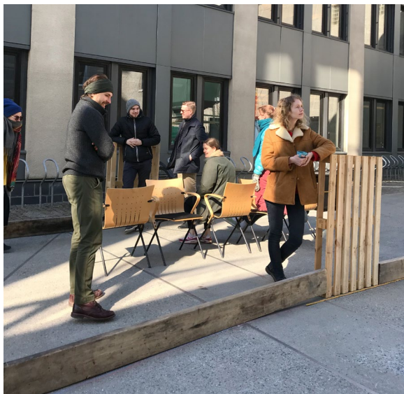
120 cm høyt rekkverk er ideelt for å dele positur og se på utsikten. Både innovervendte og utovervendte passasjerer bruker rekkverket.
