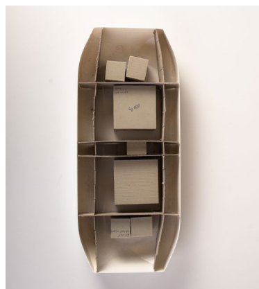
Skottedesign av Erik Veitch. Klossene representerer thrustere, batterier og prosesseringskraft.
