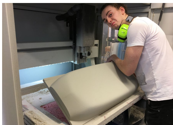
Inspeksjon av ferdigfrest skum.
