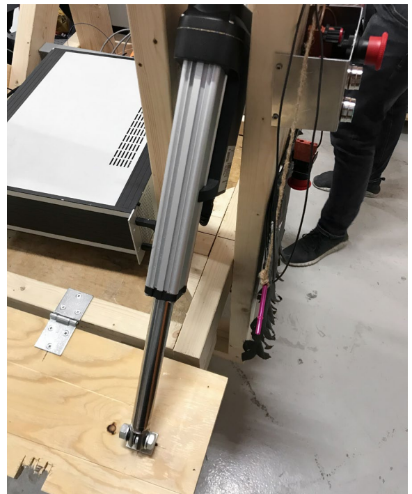
Lineæraktuatorer i hjørneskapene senker lemme.
