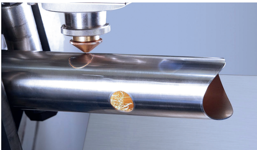
Figur 20. Flerakset laserskjæring av rørprofil.
