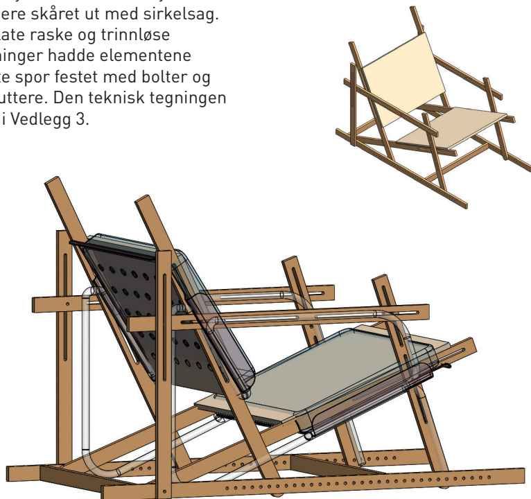
Figur 47. CAD av ergonomijiggen med utgangspunkt i skissemodellen av lenestolen.
