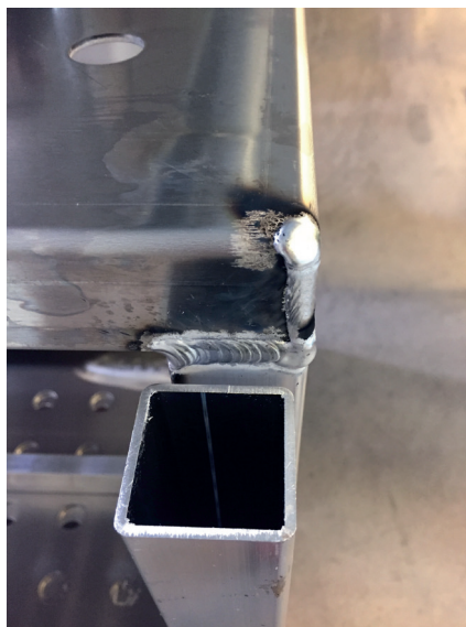
Figur 23. Hjørnesveis på aluminiumsbord før pussing.
