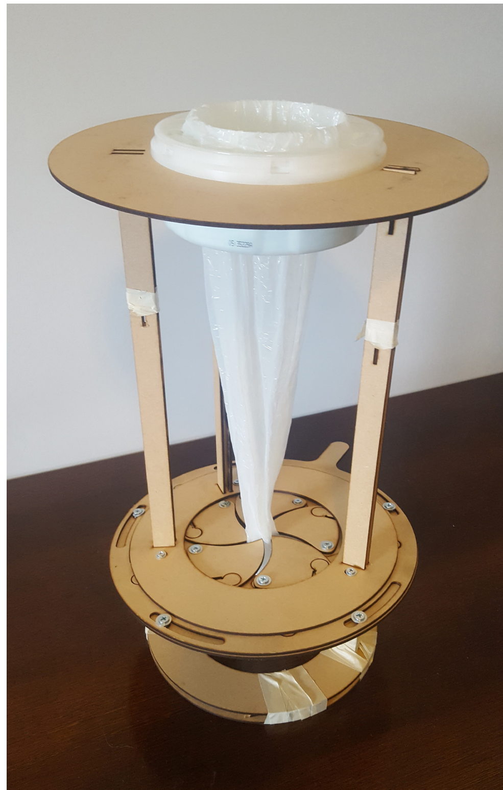
6) Senk iris-mekanismen for å simulere at posen (med dens innhold) blir senket ned i forbrenningskammeret.
