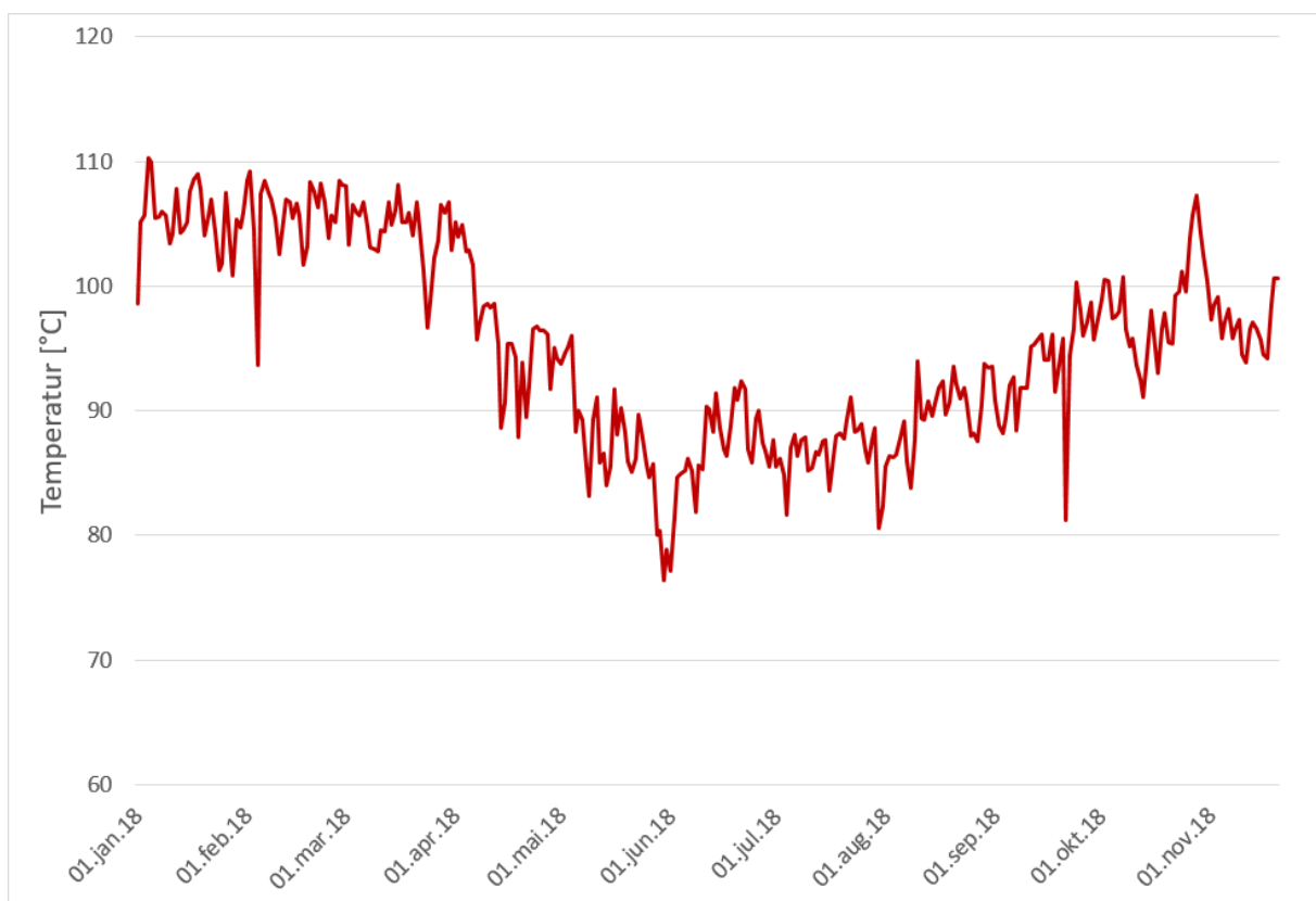
Figur 7.28 Trykkgasstemperaturen ved kompressorutløpet for VP/KM målt i 2018.
