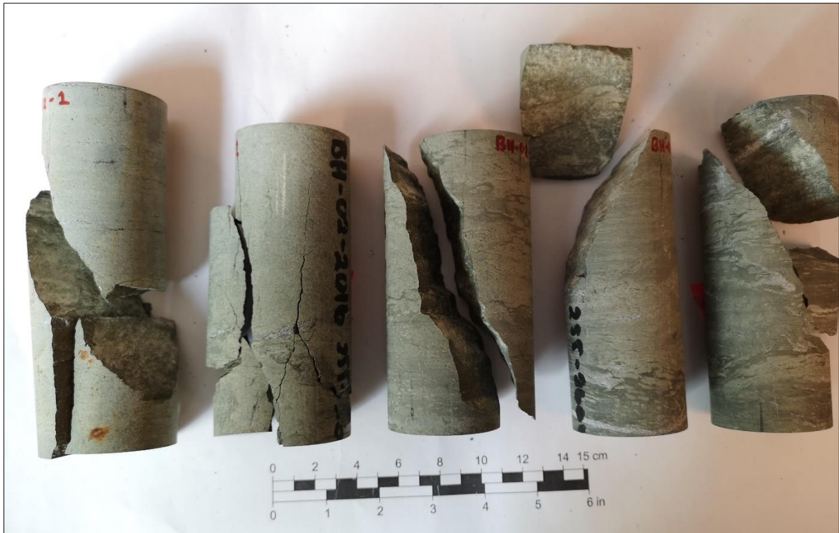
Figur 4.19: Foto av brudd i prøvekjerner fra BH-02-2016 etter enaksiell trykktest. Fra venstre mot høyre: BH-02-1, BH-02-2, BH-02-3, BH-02-4 og BH-02-5.
