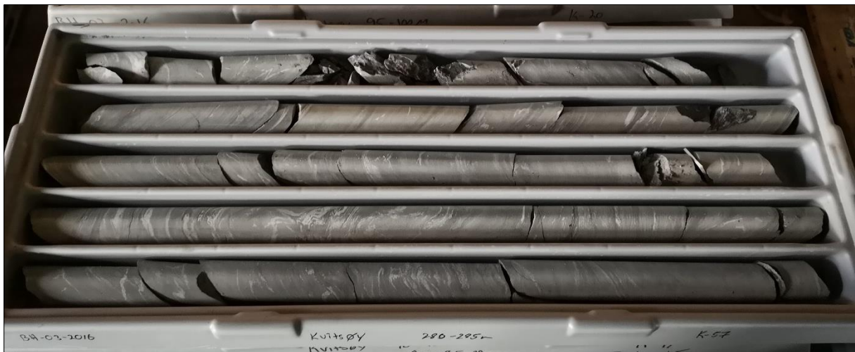
Figur 4.15: Foto av kjernekasen K-57, BH-03-2016, 280-285 m. Fra kassen er det tatt ut kjerneprøver til enaksiell trykktest.
