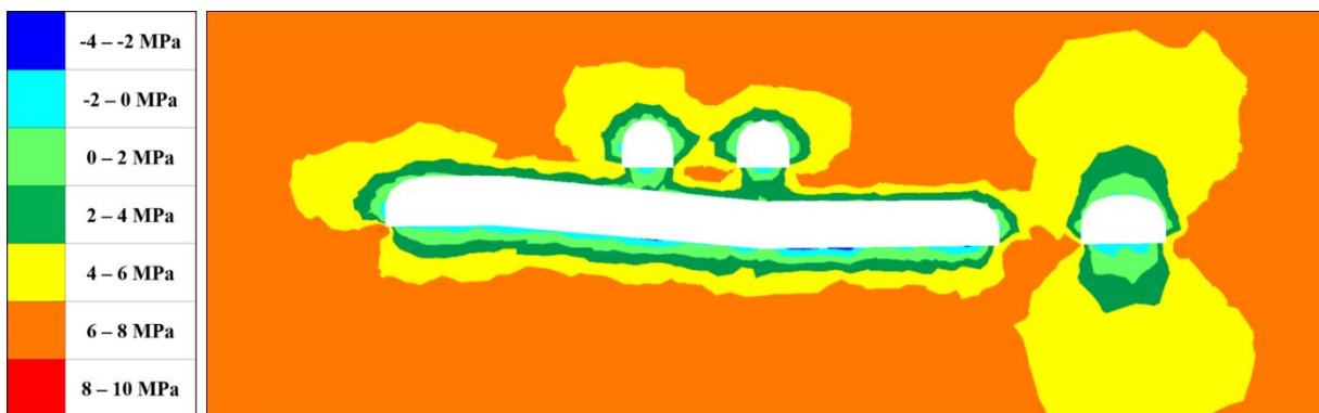
Figur 5.18: Konturplot fra RS3 av sekundærspenningen \sigma_3 i snitt C 1 -C 2 for scenario 2.
