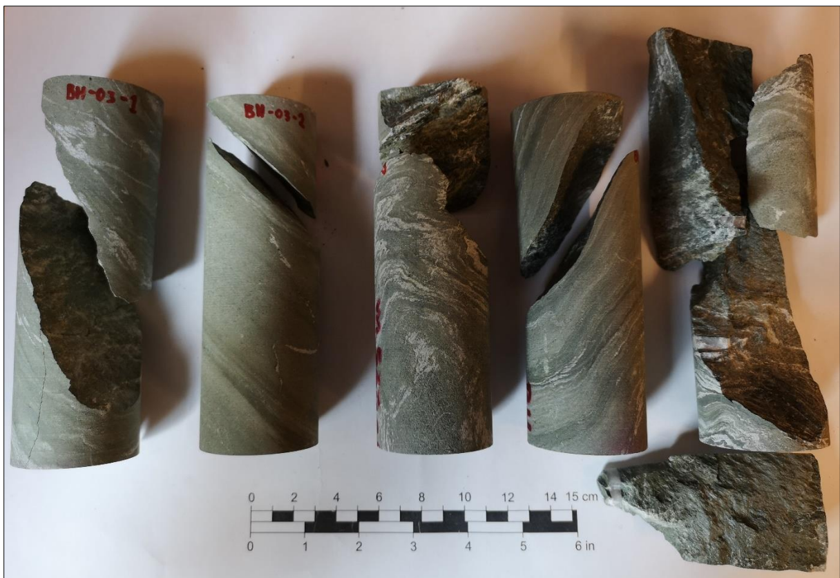
Figur 4.20: Foto av brudd i prøvekjerner fra BH-03-2016 etter enaksiell trykktest. Fra venstre mot høyre: BH-03-1, BH-03-2, BH-03-3, BH-03-4 og BH-03-5.
