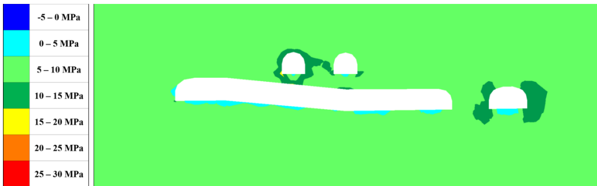
Figur 5.17: Konturplot fra RS3 av sekundærspenningen \sigma_2 i snitt C 1 -C 2 for scenario 2.
