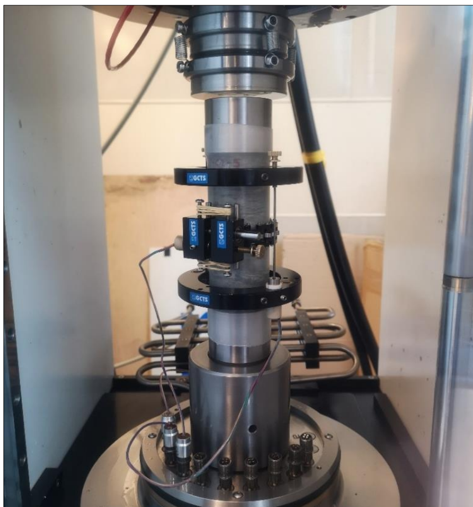
Figur 4.16. Foto av prøveoppsett for enaksial trykktest.
