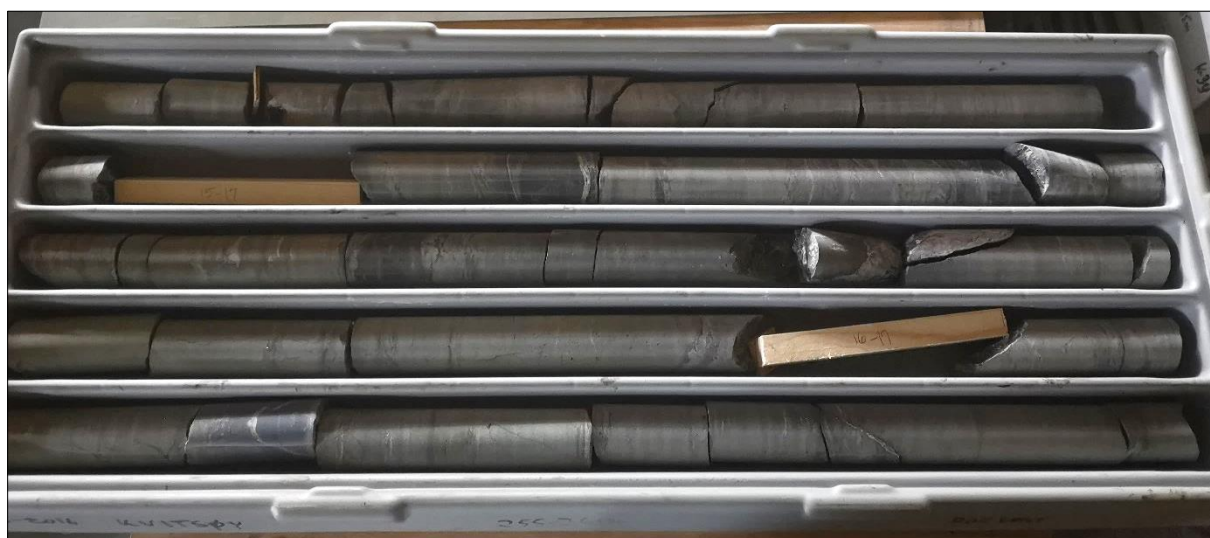
Figur 4.11: Foto av kjerne-kassen K-52, BH-02-2016, 255-260 m. Fra kassen er det tatt ut kjerneprøver både til tilttest og til enaksiell trykktest.
