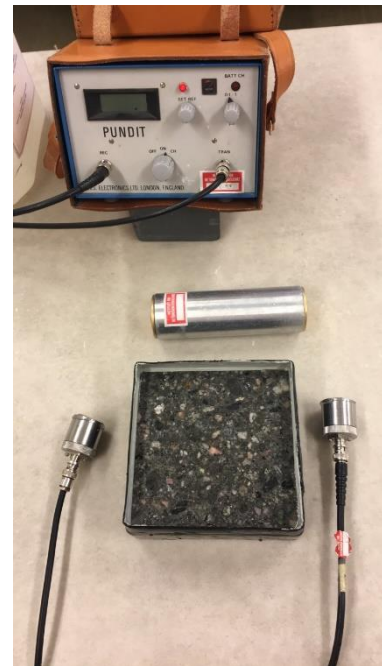
Figur 10: Bestemmelse av ultralydhastighet gjennom betongprøven. Foto: Jørn Hustad
