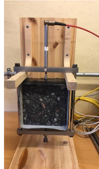
Figur 8: Måling av betongprøvens lengdeendring. Foto: Jørn Hustad.
