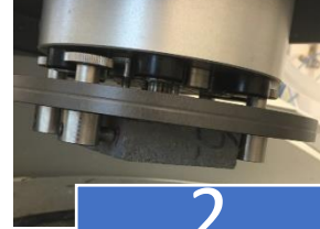
Figur 13: Betongprøvene skrus fast til en sirkulær metallskive (1) og festes deretter til slipemaskinen ved hjelp av magnetisk kraft (2). Foto: Jørn Hustad
