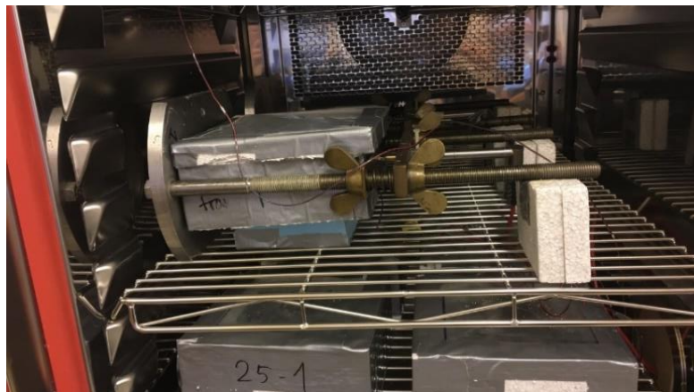
Figur 9: Kontinuerlige målinger av betongprøvens lengdeendring. Foto: Jørn Hustad
