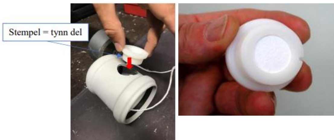
Figur 4: Montering av DGT-måler for utplassering i et RAS-anlegg, og en ubrukt DGT-måler.
