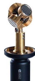
Illustrasjon 17: Sennheiser Ambeo VR-mikrofon. Består av fire mikrofonkapsler som tar opp lyd i et 360-graders felt. Plasseringen på kapslene i forhold til hverandre gjør at det ikke skapes fase- eller frekvensforstyrrelser i lydbildet
