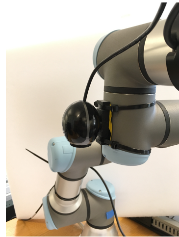
Figur 5.19: Kamera montert på første håndledd på robotarm
