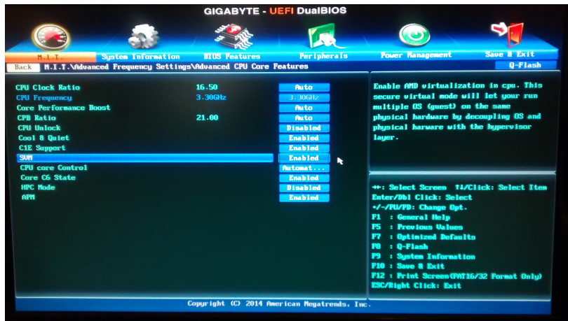
Figure 4.10: AMD SVM Parameter in the UEFI-BIOS 12
