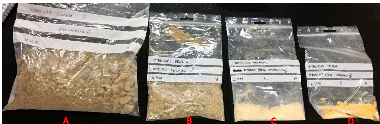
Figur 10: Bilde viser de fire ulike sildehydrolysatene etter frysetørking. (A) sildehydrolysat før ultrafiltrering ved 150kDa/MWCO og 4kDa/MWCO. (B) Retentat >150 kDa filtrert ved keramisk filtrering, 150kDa/MWCO. (C) Retentat >4 kDa filtrert ved keramisk- og polymer- membranfiltrering, 150kDa/MWCO og 4kDa/MWCO. (D) Permeat <4 kDa ble filtrert ved keramisk- og polymer- membranfiltrering, 150kDa/MWCO og 4kDa/MWCO.
