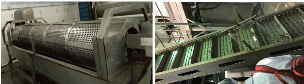
Figur 23 Viser det første vaskesteget i surimiproduksjonen hvor en trommel vasker fisken ved bruk av isvann.
