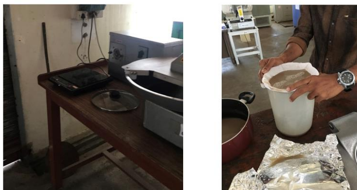
Figur 30. viser kokeplaten som ble benyttet til varmebehandling av råstoffet når det ankom CFTRI. Neste bilde viser hvordan restråstoffet ble filtrert for større partikler
