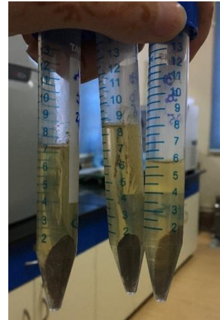
Figur 31: Bilde viser hydrolysat uten klar separasjon mellom oljefasen og vannfasen
