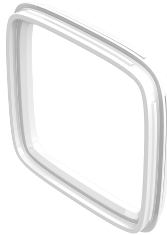
AKRYLRINGEN: DEN RINGFORMEDE SNAPEN ER KUTTET I HJØRNENE FOR Å GJØRE DET ENKLERE Å MONTERE OG DEMONTERE PRODUKTET.
