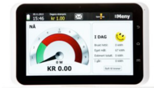
BILDE 2.4: E-WAVE ER EN NORSKPRODUSERT IHD, SOM HAR BLITT BENYTTET I PILOTSTUDIER I NORGE. IHD-ET PRODUSERES AV MILJØVAKT A/S. FOTO: (GLOBAL TALENT CENTER, 2016)
