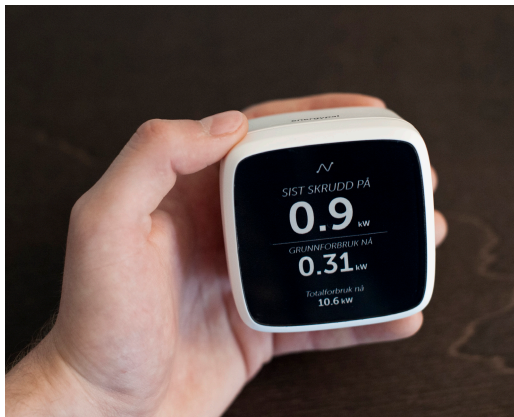
BILDE 9.2.4: PLUTSELIG SLÅR 0,9 KW SEG PÅ IGJEN. MATS UNDRER LITT FØR HAN KOMMER PÅ AT DET KAN VÆRE TERMOSTATEN TIL PANELOVNVEN I GANGEN.
