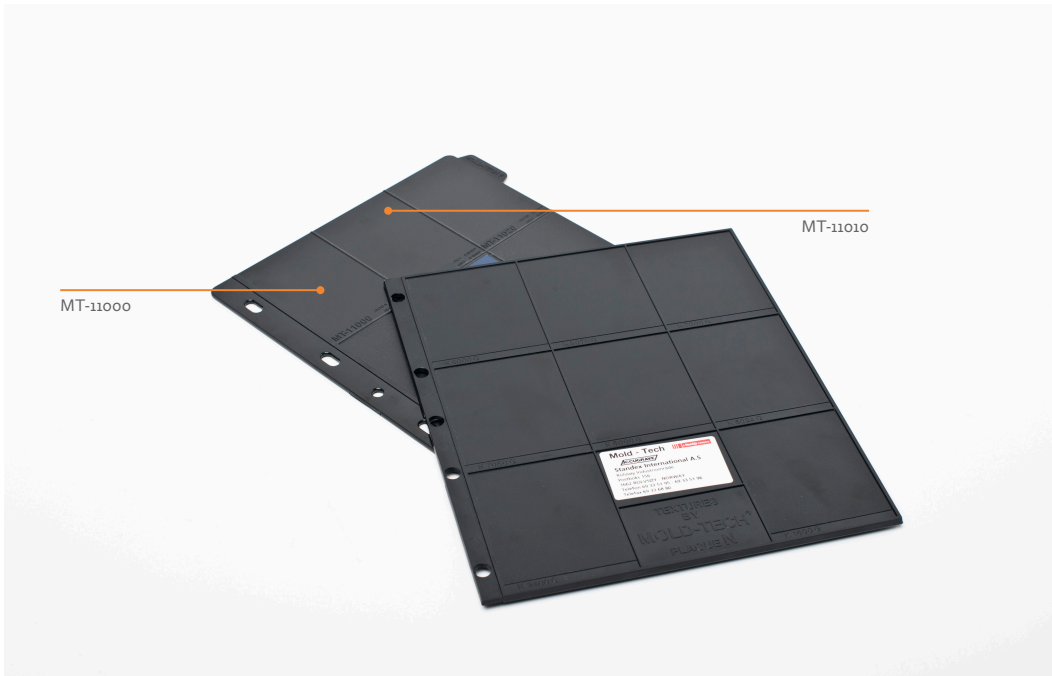
TEKSTURVALG: MED TEKSTURPRØVER FRA MOLD-TECH BLE MT-11010 VALGT SOM HOVEDTEKSTUR OG MT-11000 VALGT SOM GLANSFLATE PÅ FRONTDEKSELETS CHAMFER.
