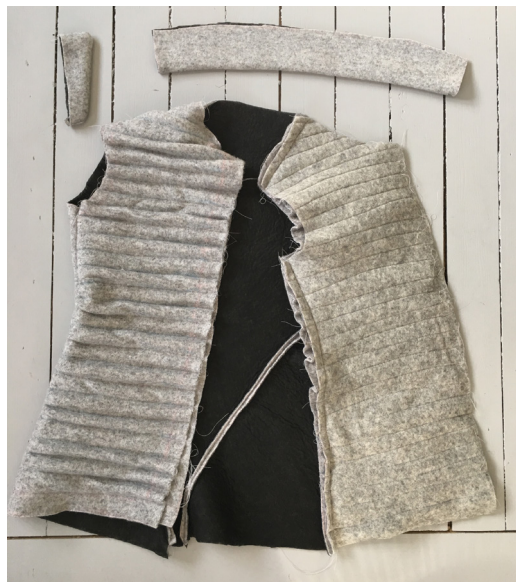
Fremstykkene og bakstykket sydd sammen. Bakstykket har fått et lag med stretch-vlies, et strykeinnlegg som gir stoffet mer hold ("Spesial vlies", 2018). Dette ble testet ut for å se om det var nødvendig eller om ullstoffet kunne holde formen til vesten selv. Den sorte herrevesten var uten strykeinnlegg for å kunne sammenligne.
