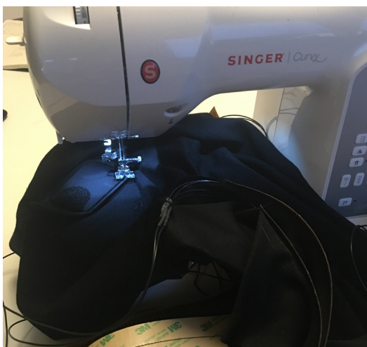
Festing av batterilommer på innsiden av vesten. Viktig at disse sitter godt sånn at batteriet også blir fast i vesten.
