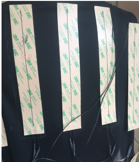
Konstruksjon av mønstermal og klipping av innerstoff. Innerstoff med varmelementer sydd på, og delene til slutt sydd sammen til "innmaten" i vesten.
