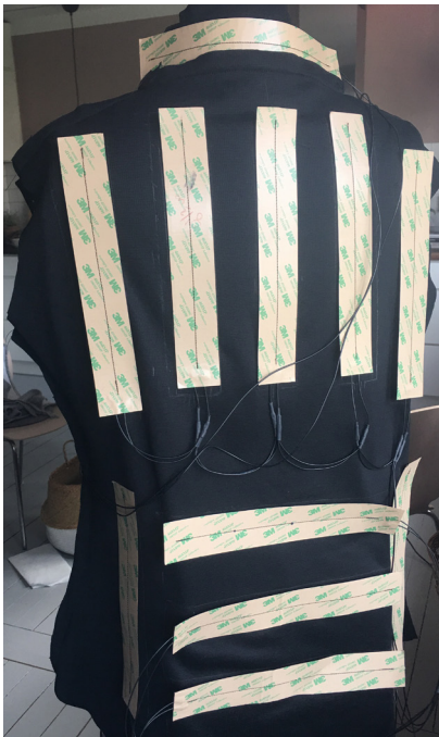
Konstruksjon av mønstermal og klipping av innerstoff. Innerstoff med varmelementer sydd på, og delene til slutt sydd sammen til "innmaten" i vesten.
