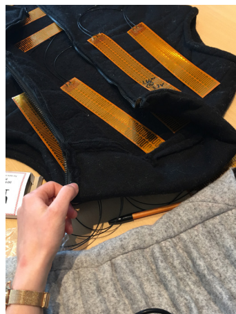
Plassering av varmelementer og batteripakker.
