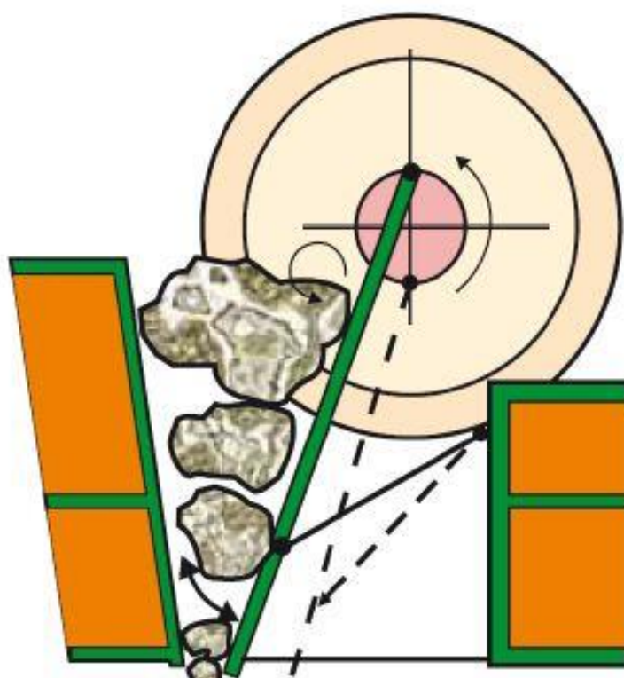
Figur 9: Kjefteknuser, rotasjonsknuser (Viilo, 2011)
