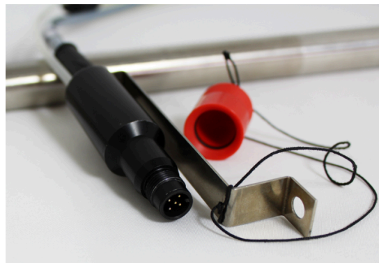
Figur 36. a) Piezometer av typen Geokon (Geokon, u.å.). b) Seba trykkcelle (SebaHydrometrie, u. å.). Begge benyttes til poretrykkovervåking på Follobanen.
