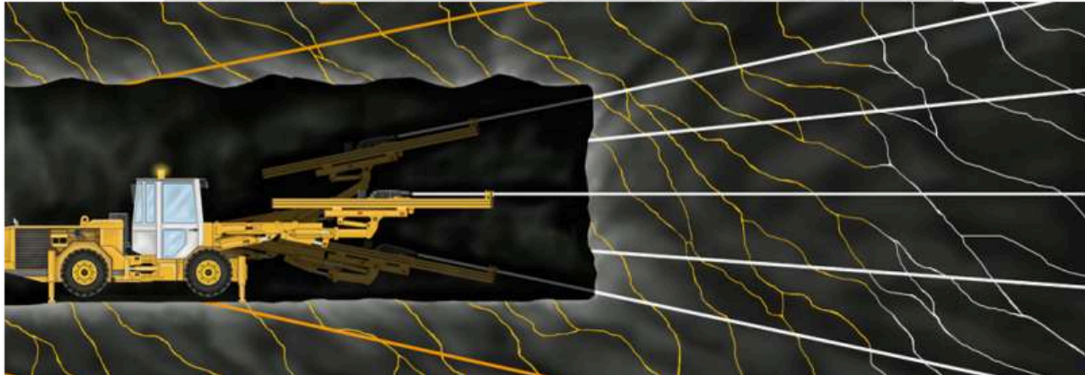
Figur 12. Viser tunnelstøffen foran boremaskinen. På illustrasjonen injiseres det injeksjonsmasse for å tette bergmassen i forkant av drivingen gjennom sonen (Vegvesen, 2011).
