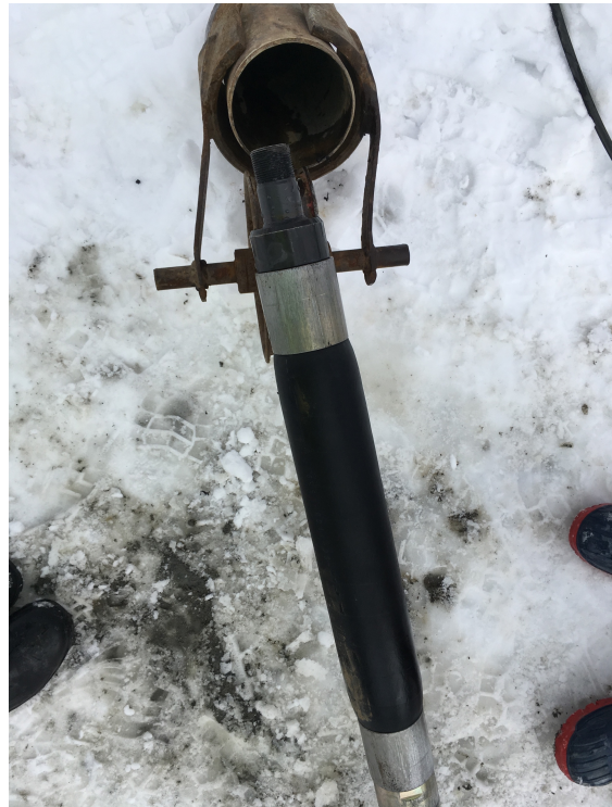
Figur 9 a og b. Utstyr benyttet til lugeontesting. a) Vannslanger og brønn. Pumpe til venstre som sørger for at pakkeren ekspanderes og dermed holdes på rett dyp i brønnen. På de to blå beholderne ses ventiler og målere på slangen som overvåker infiltrert vannmengde og trykk på vannet. b) Infiltrasjonsbrønn med pakker. Bilder tatt i felt, fra Follobanen.
