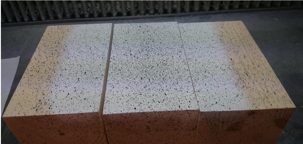
Figur 24 - Prikkemønster påført et av prøvestykkene
