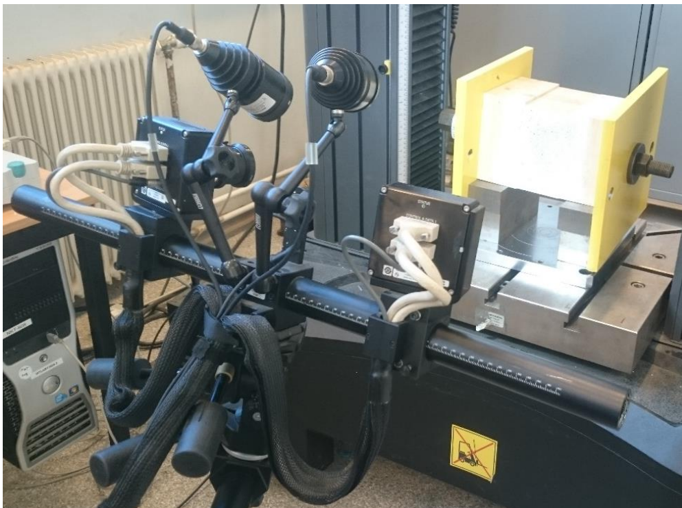
Figur 28 - Prøvestykket plassert i testmaskinen klar for testing. I forkant vises plasseringen av kameraene benyttet i forbindelse med registrering av målingene i Aramis.
