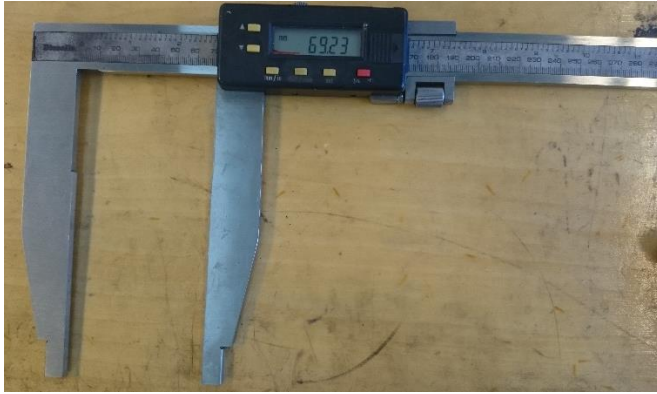
Figur 21 - Skyvelær benyttet til måling av avstanden mellom stålplatene ettersom prøven ble strammet opp
