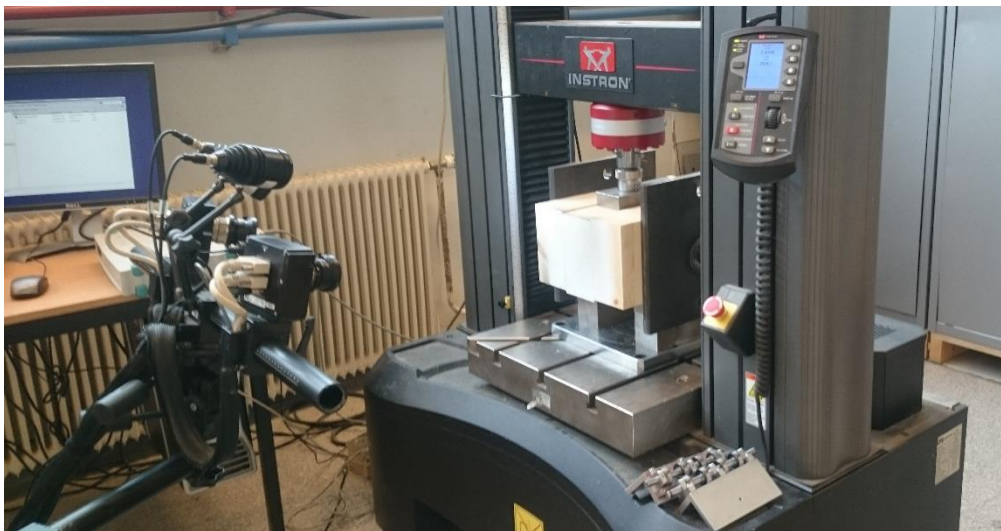
Figur 22 - Oppsett av utstyret. Klossene ble plassert i testmaskinen med passende avstand til kameraene som var tilkoblet Aramis. Vertikallasten ble så satt på den midterste av treklossene og testingen startet.
