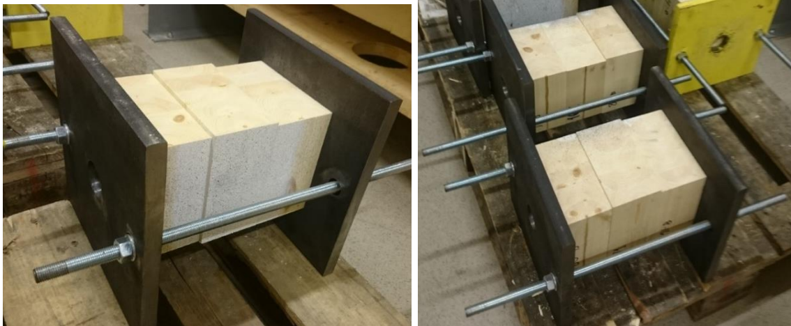
Figur 25 - De oppspente prøvene ble lagret oppspente ved bruk av to mindre stålstag. Prøvene ble stablet på paller og oppbevart i klimarom fram til de skulle testes.
