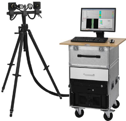
Figur 23 - Målesystemet Aramis. Systemet består av et stativ med påmonterte kameraer. Disse er så tilkoblet en datamaskin [35].
