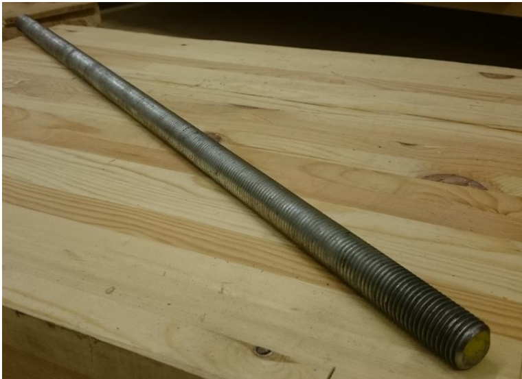
Figur 19 - Det store stålstaget som ble benyttet under oppstramming og testing av prøvestykkene
