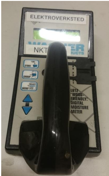
Figur 17 - Fuktighetsmåler benyttet til å undersøke fuktigheten i trevirket
