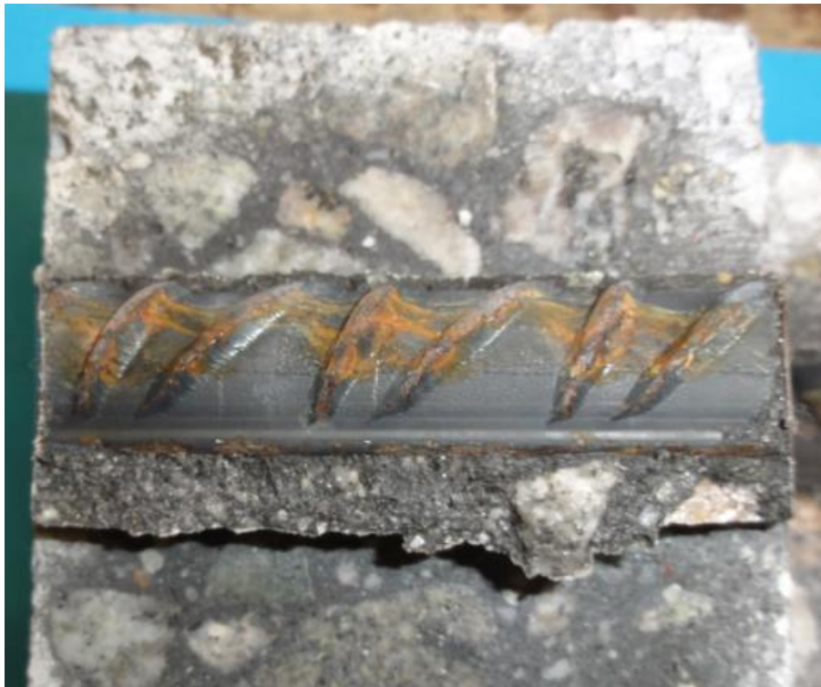
Figur 4.18: Rustprodukter på armeringen i kjerne FTCr2. (Foto: Tobias A. Danner)
