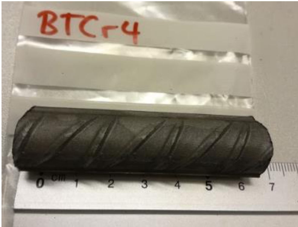
Figur L.1: Rengjort armering fra kjerne BTCr4
