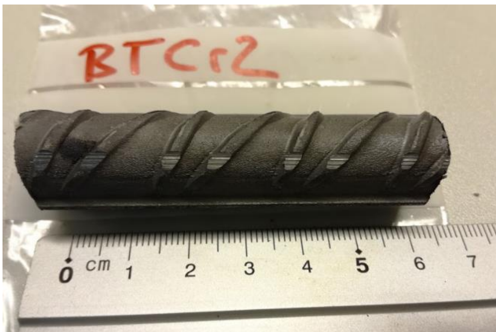
Figur L.2: Rengjort armering fra kjerne BTCr2
