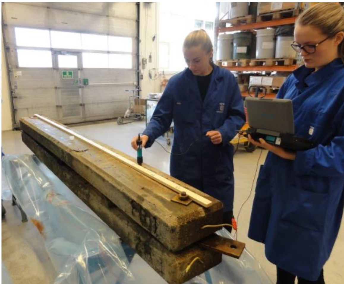
Figur 3.14: Utførelse av EKP-punktmålinger langs linje 2 på bjelke F. Målesonden plasseres på bjelken med jevne mellomrom, og verdier for EKP registreres på den håndholdte enheten. På bildet er det synlig hvordan det er etablert elektrisk kontakt mellom instrumentet og armeringen via den gule ledningen i enden av bjelken. (Foto: Tobias A. Danner)
