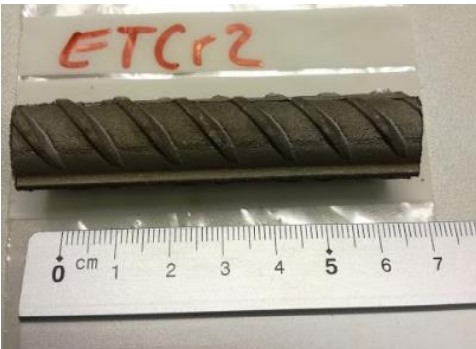
Figur L.4: Rengjort armering fra kjerne ETCr2
