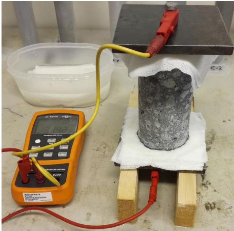
Figur 3.20: Motstandsmåling på en borekjerne. Klutene kaster skygge på øverste del av kjernen slik at den ser mørkere ut her. (Eget foto)
