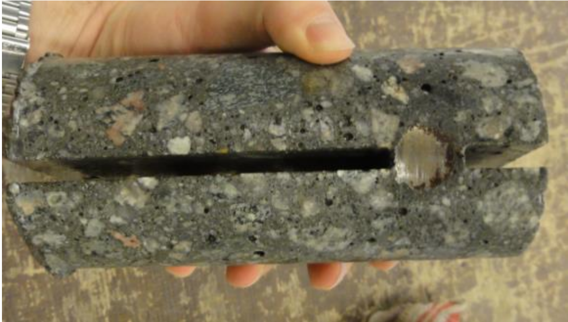
Figur K.1: Splittelse av kjerner med armering
