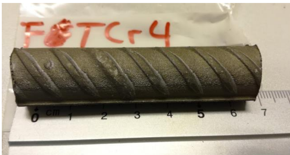
Figur L.5: Rengjort armering fra kjerne FTCr4
