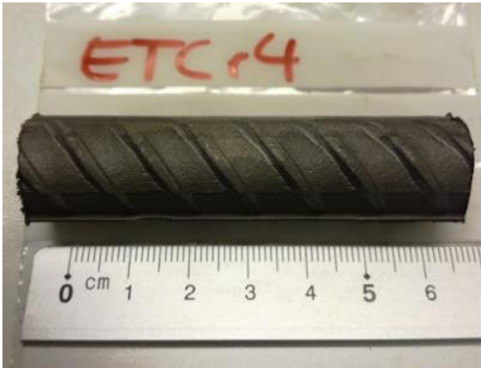
Figur L.3: Rengjort armering fra kjerne ETCr4
