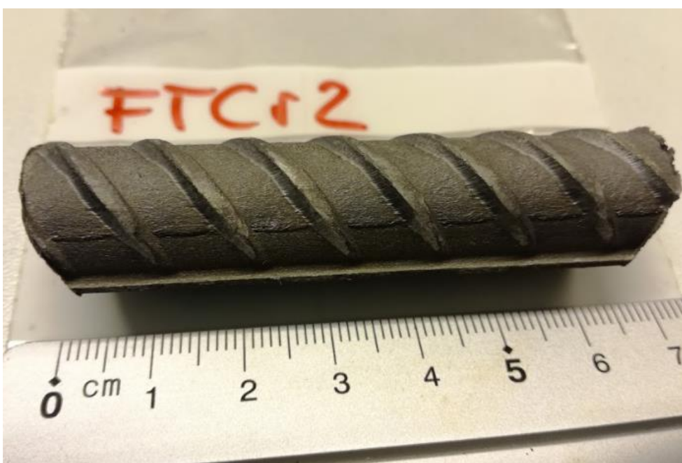
Figur L.6: Rengjort armering fra kjerne FTCr2
