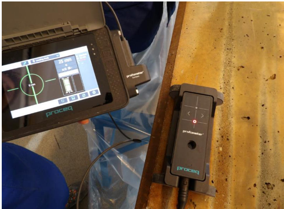
Figur 3.13: Illustrasjon av bruk av overdekningsmåleren fra Proceq. Bildet viser at det dukker opp et rødt lys når måleren har identifisert armeringsjernet, og faktisk overdekning kan leses av på skjermen. (Eget foto)
