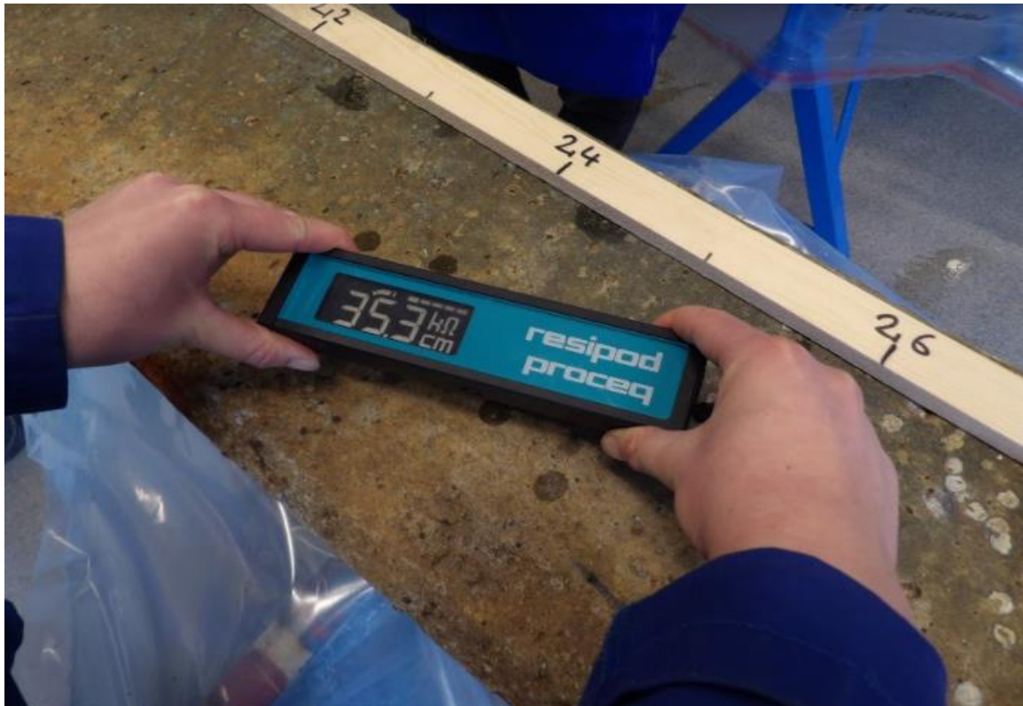
Figur 3.16: Måling av resistivitet med Resipod fra Proceq. De våte flekkene på betongen stammer fra svampene på måleinstrumentet som til enhver tid ble holdt fuktig. (Eget foto)
