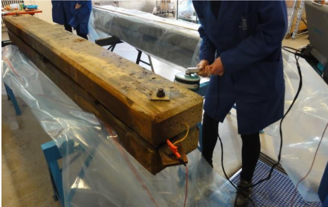
Figur 3.15: Utførelse av EKP-målinger ved hjelp av hjul langs linje 1 på bjelke B. Målingene startes manuelt på skjermen til den håndholdte enheten i det man begynner å føre hjulet langs bjelken, og avsluttes i enden av bjelken. Verdier for EKP fanges opp kontinuerlig langs bevegelsesbanen. (Foto: Tobias A. Danner)
