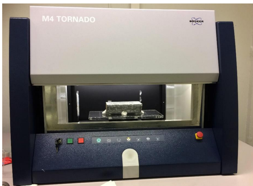
Figur 3.21: En kjernehalvdel ligger klar for analyse i M4 Tornado \mu -XRF apparatet. (Eget foto)
