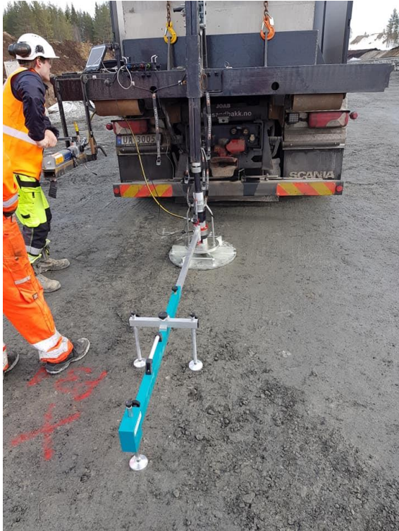
Figur 8: Platebelastningsutstyr på lastebil.
