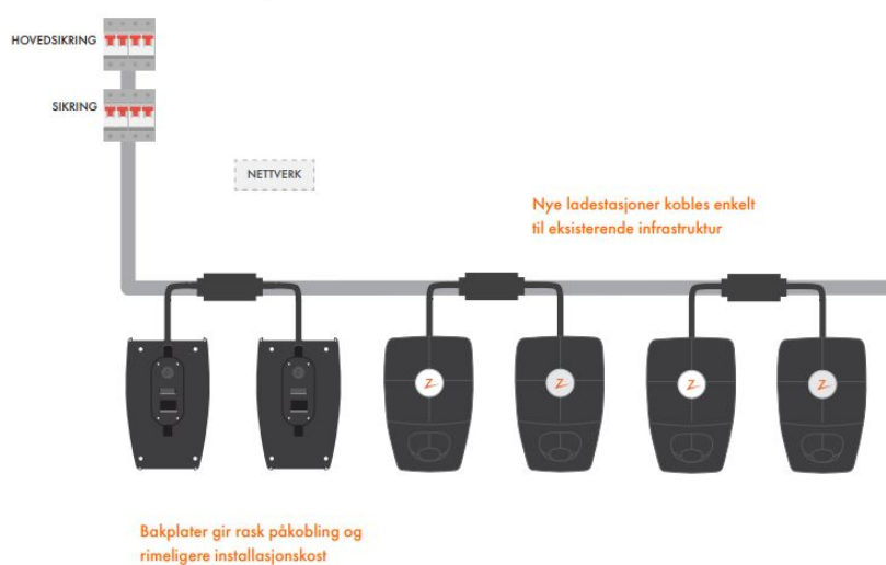
Figur 6: Blokk-skjema av Zaptec ladessystem. [11]
