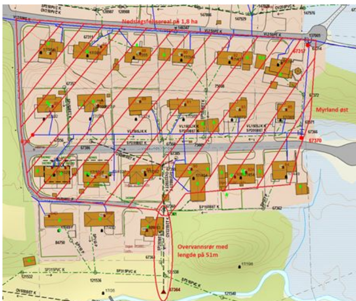
Figur 32. Utvalgt nedslagsfelt for boligfeltet i østlig del for overvannsberegning
