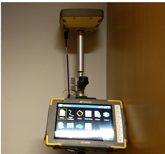
Figur 20. GPS-utstyr fra Topcon
