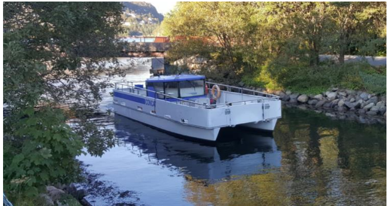
Figur 24. Nearshore Survey AS bruker den sammenleggbare katamaranen ConCat til oppmåling (Bergen Kommune, 2015).
