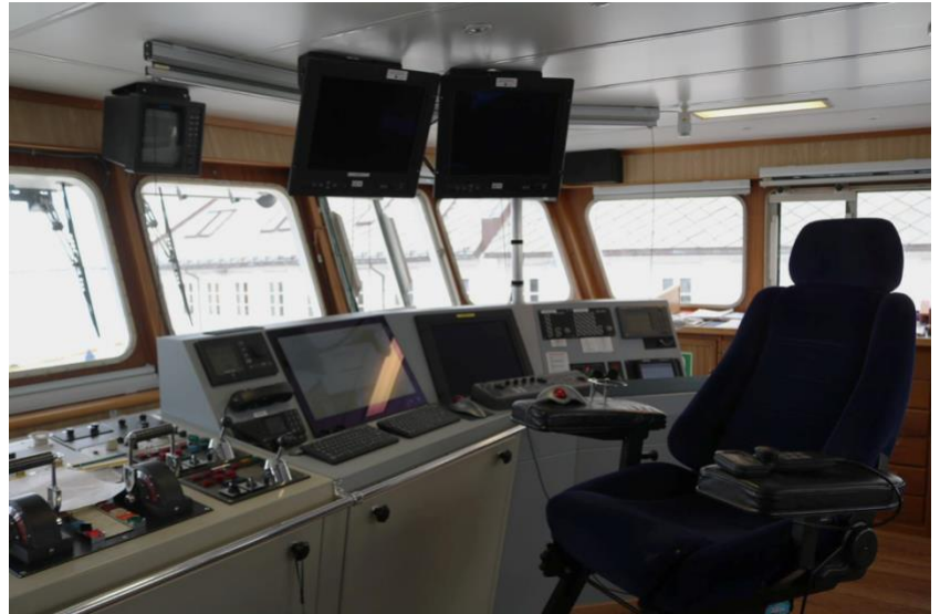
Figur 22. Vakthavende offisers arbeidsplass på broen om bord på Hydrograf. Her kan offiseren overvåke seilassen med navigasjonsinstrumentene nede på bropulten og den batymetriske innsamlingen på skjermene over.
