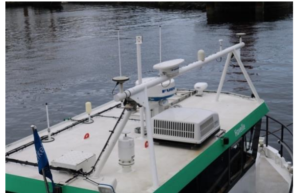
Figur 19. Sensorer montert på taket til målefartøyet.
