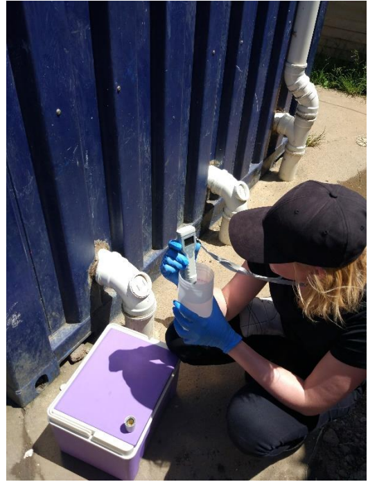
Måling av pH og temperatur ved en CAB.
