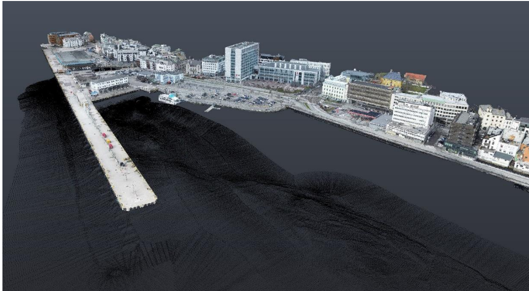
Figur 2.17: Punktskyen vår kombinert med dybdedata. Skjermbilde fra ReCap.
