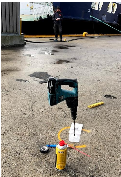
Figur 3.9: Metode for innsamling av borestøv.
