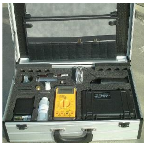
Figur 3.1: RCT-feltsett fra Millab
