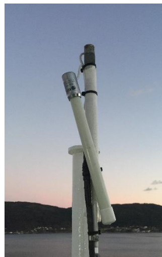
Figur 8 Brukket antenne (foto: Jostein Synes)
