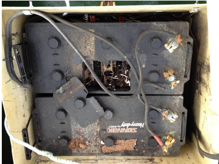
Figur 14 Uttørket syrebatteri (foto: Jostein Synes)
