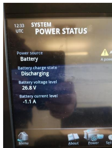
Figur 11 Testing av batteri med belastning (foto: eget)
