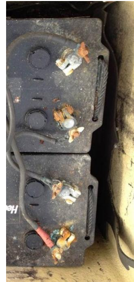
Figur 15 Poler med irr (foto: Jostein Synes)
