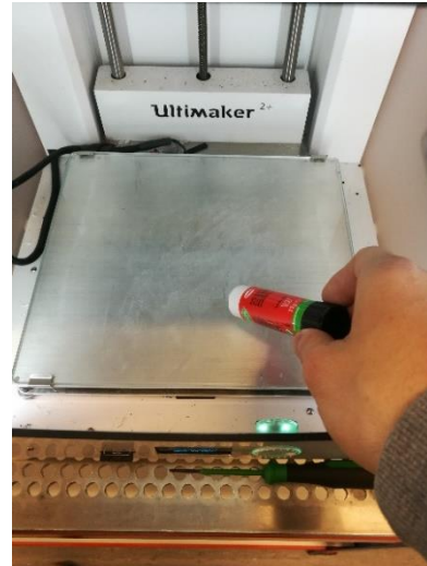
Bilde 4.37: Liming av bunnplaten
