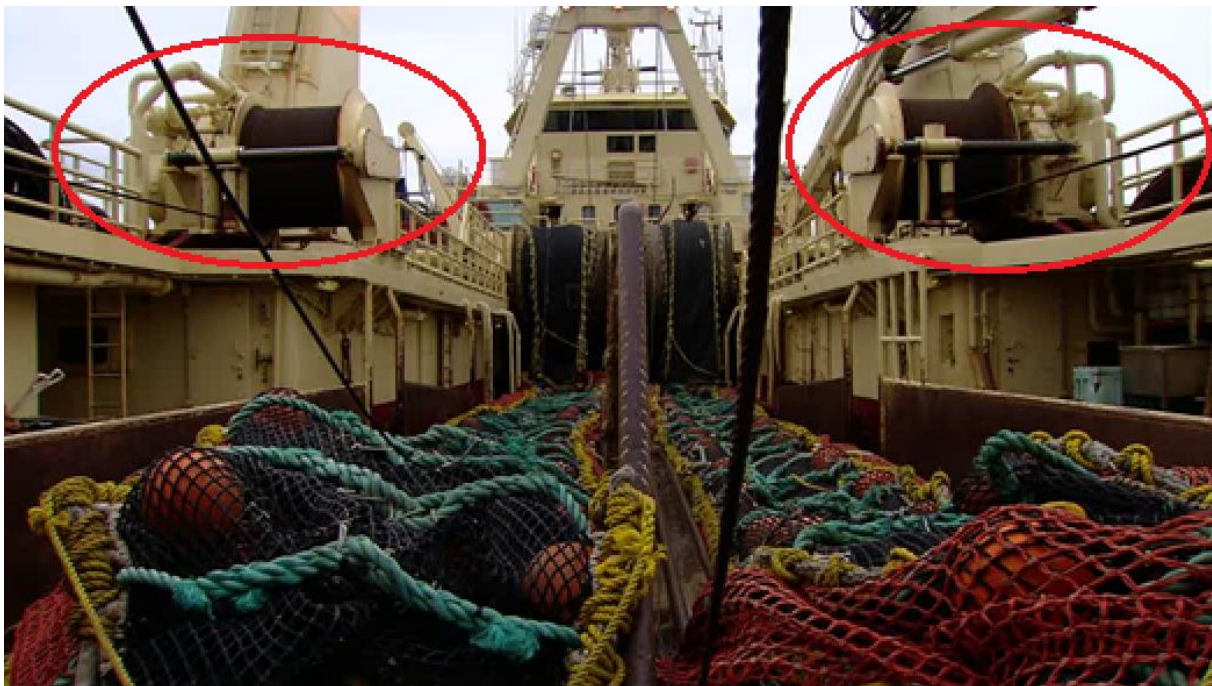
Figur 3. Oppsett av trålvinsjer. 2 wire vinsjer på sidene (raudt), og 1 nett vinsj i midten.
