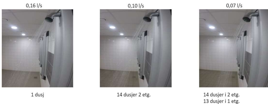
Figur 15: Viser vannstrålen fra dusjhodet ved angitt antall dusj i 2. etasje på Lade Sportsarena.
