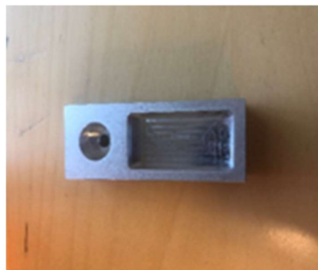
Figur 35 Sensorhus rustfritt stål
