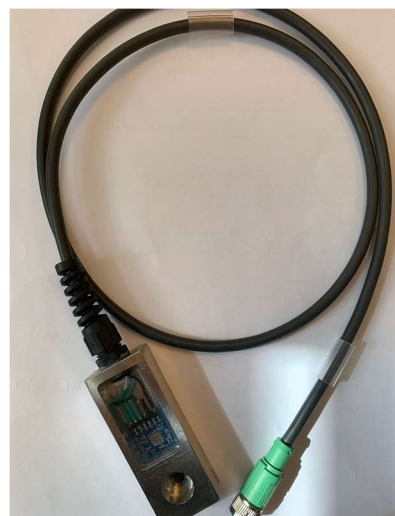
Figur 41 Ferdig laget vibrasjonssensor
