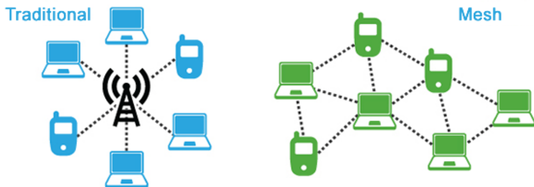
Figur 7: Tradisjonelt nettverk vs Mesh-nettverk (TUCU 2014)
