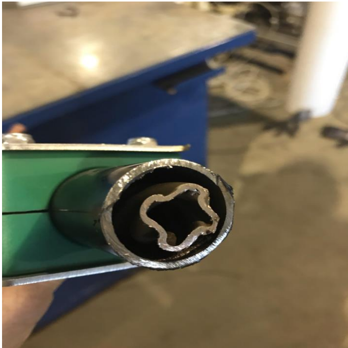
Sugegassveksleren som vi måtte demontere kuttet i to, Mellomveksleren har akkurat samme utforming. Eget bilde.
