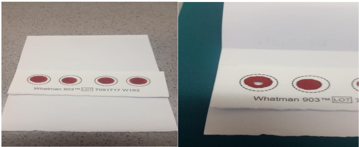
Figur 9: Viser til venstre DBS papir som er spottet med fullblod med peptidmiks. Til høyre ser man et eksempel på senterpunch.
