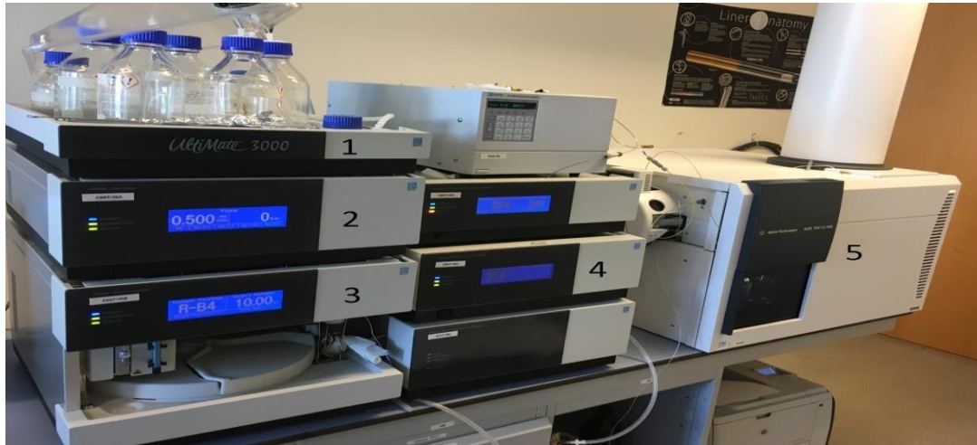
Figur 10: LC-MS instrumentet som ble benyttet i denne oppgaven hvor de forskjellige delene er: 1. mobilfasereservoar, 2. pumpe, 3. autosamplere, 4. kolonne, 5. detektor
