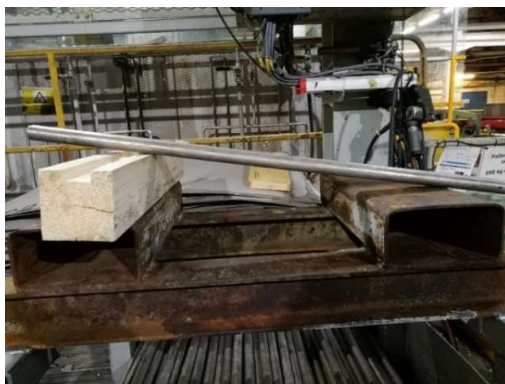
Figur 10: Oppsett for test av tyngdekraftens påvirkning på stenger ved forskjellige vinkler
