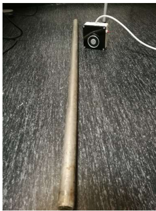
Figur 9: Stang og elektromagnet
