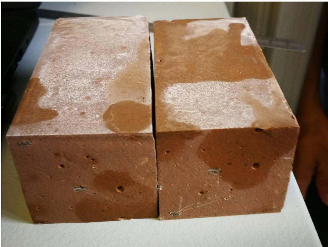
Bilde c.2.3: Prisme 1, blanding 30 % blå leire leire, 15% kalkstein og 55% sement.
