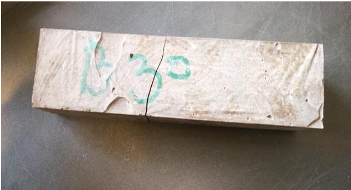
Bilde c.1.3: Prisme 1, blanding 30 % blå leire, 15% kalkstein og 55% sement.
