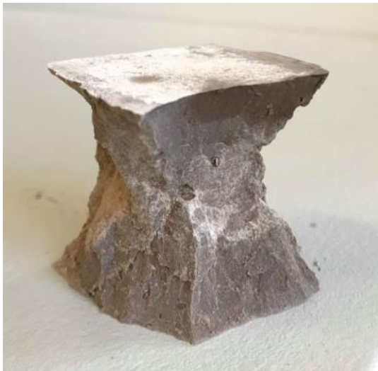
Figur 18: Bilde av godkjent bruddform, kalles for C
