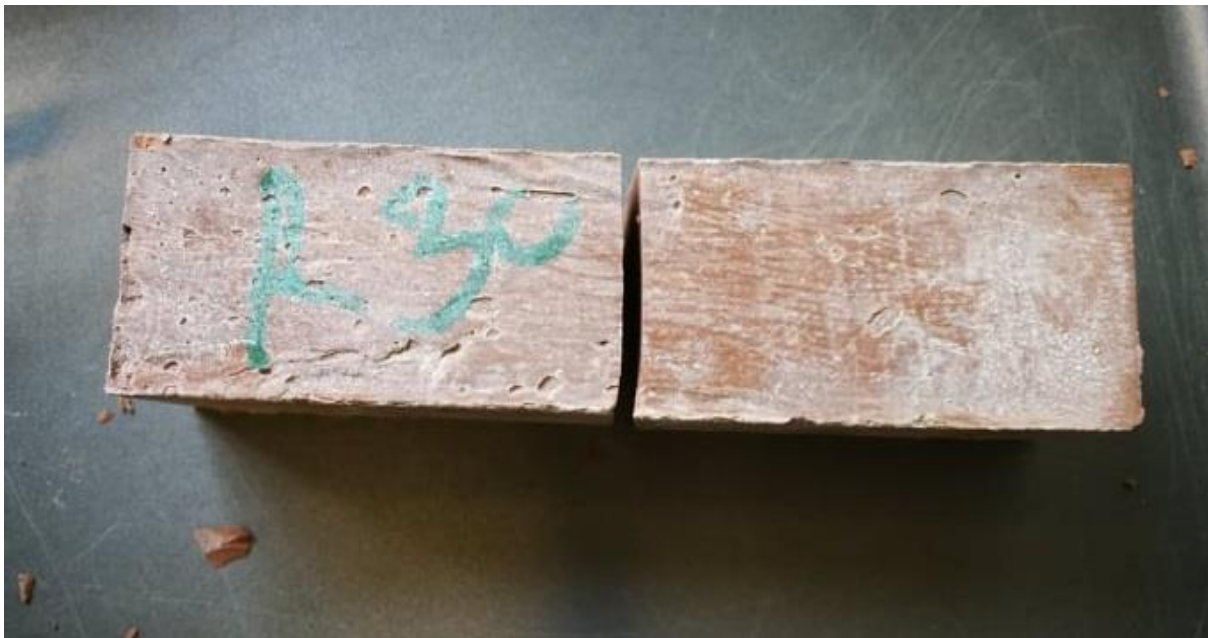
Bilde c.1.6: Prisme 2, blanding 30 % Rød leire, 15% kalkstein og 55% sement.
