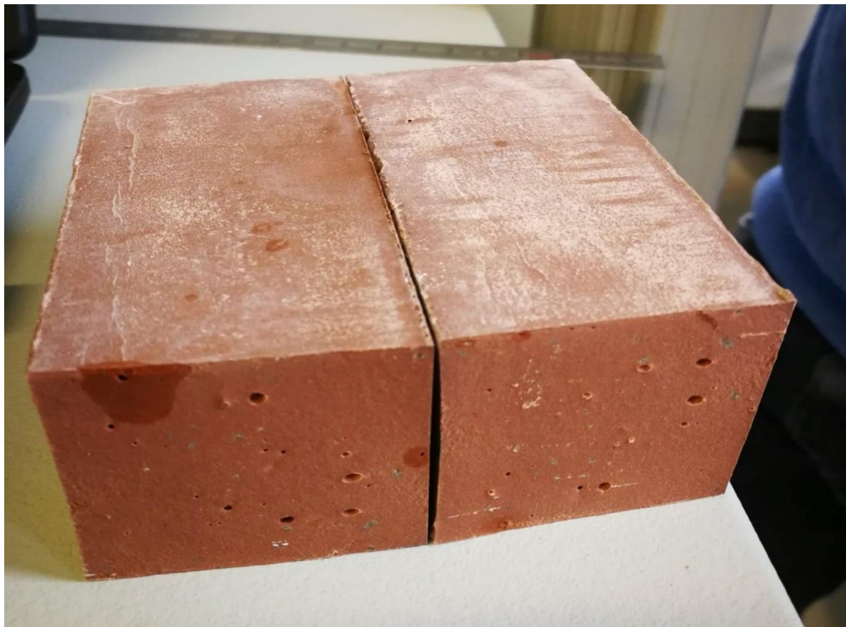
Bilde c.2.6: Prisme 2, blanding 30 % rød leire, 15% kalkstein og 55% sement.
