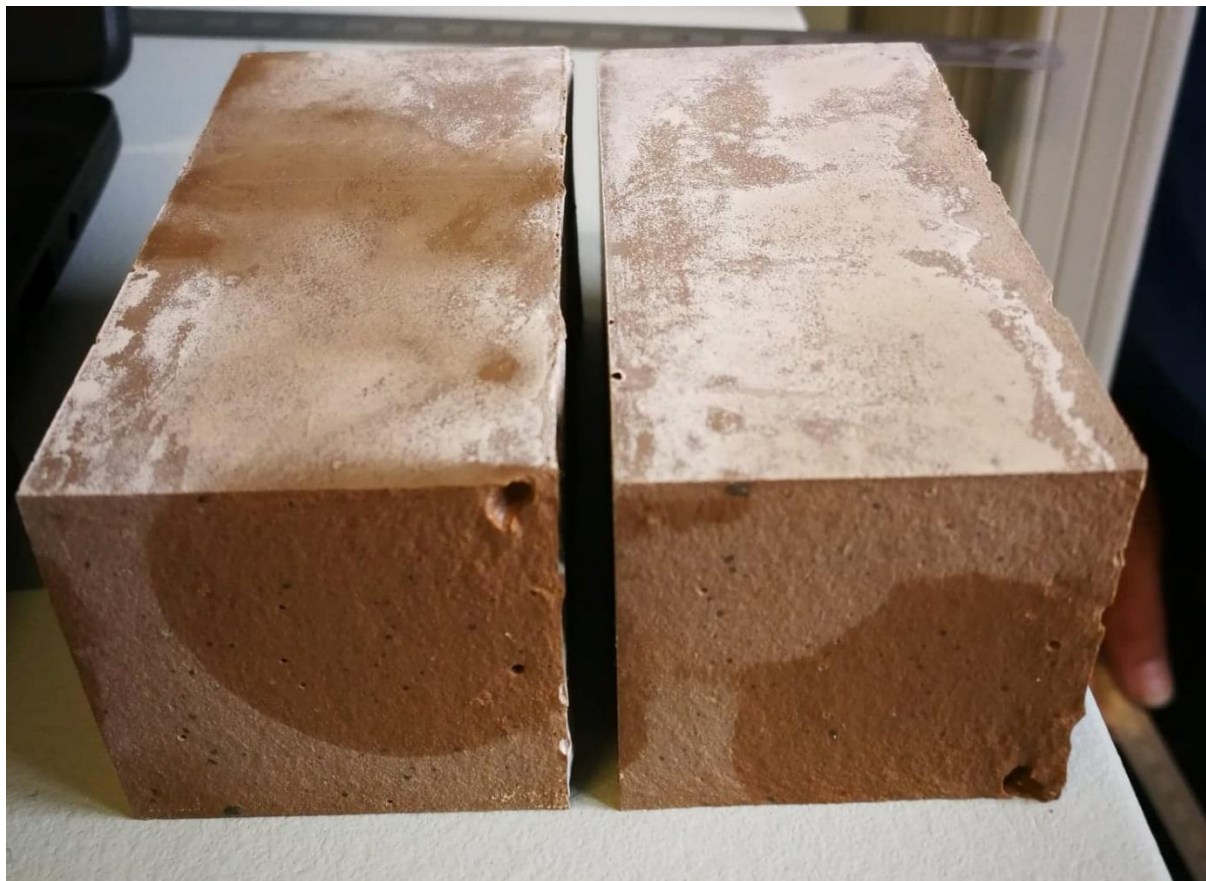
Bilde c.2.2: Prisme 2, blanding 30 % lokal leire, 15% kalkstein og 55% sement.
