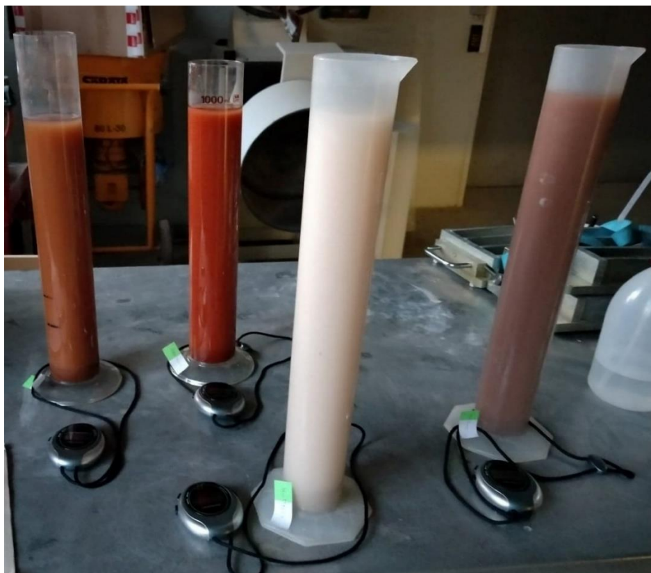
Figur 15: Bilde av sylindere fylt med leireksemplar for bestemmelse av kornstørrelsesfordeling
