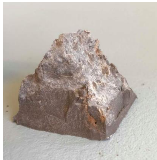
Figur 19: Bilde av godkjent bruddform, kalles for B
