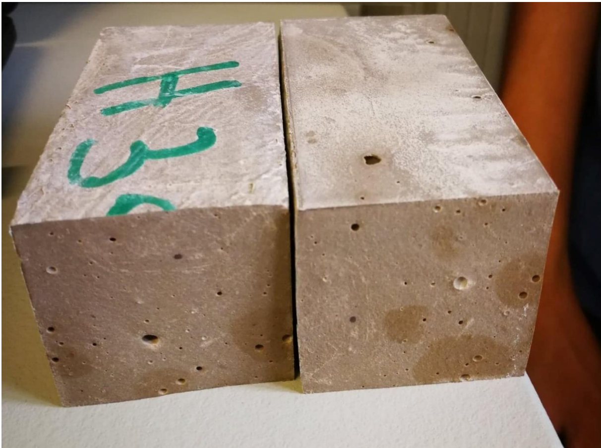
Bilde c.2.8: Prisme 2, blanding 30 % hvit leire, 15% kalkstein og 55% sement.
