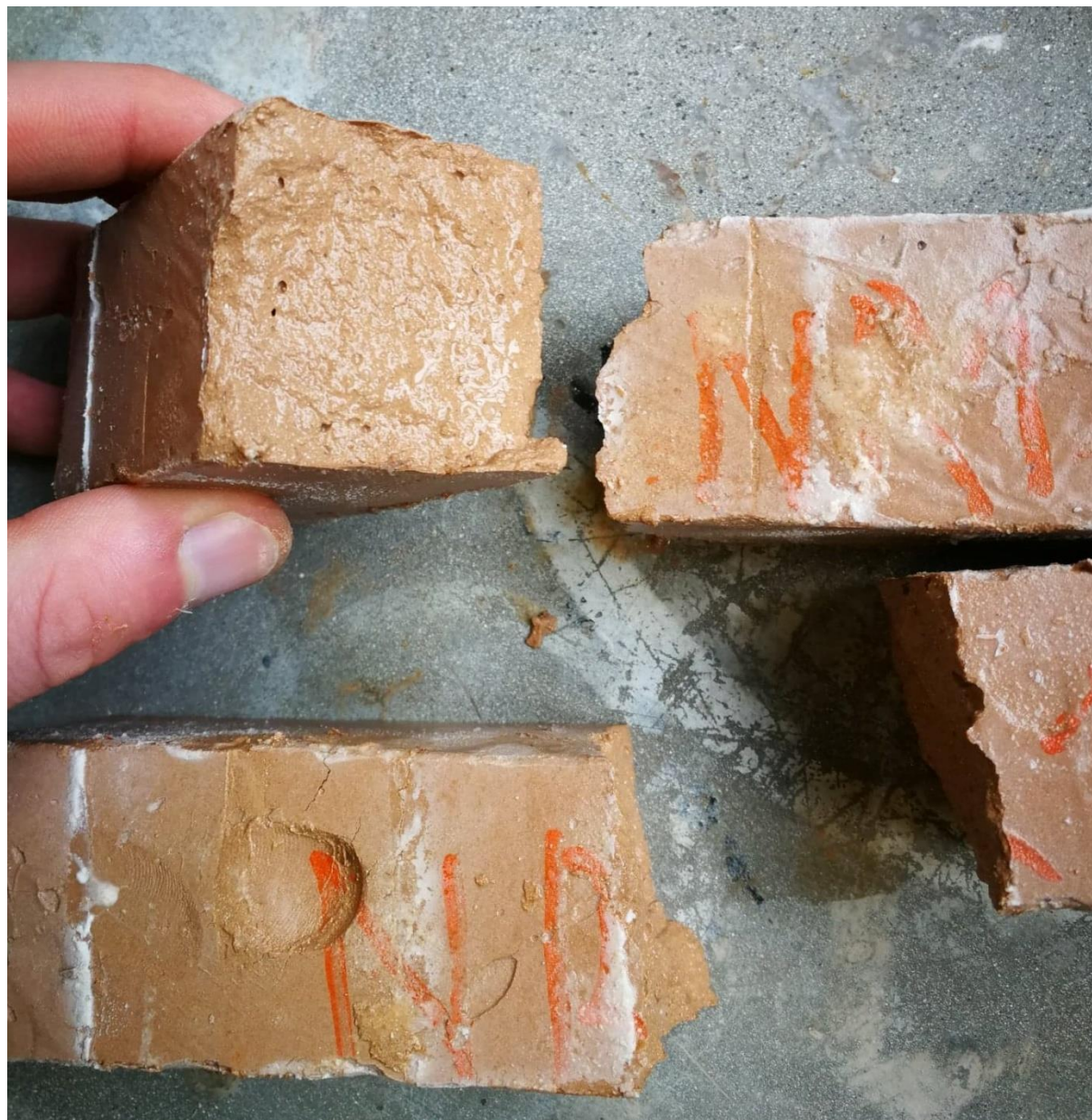
Bilde c.5.1: prisme1 -2: for blanding med 52.7% loka leire, 10,5% kalkstein og 36.8% hydratkalk
