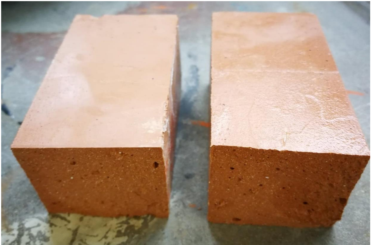
Bilde c.5.2: prisme 1: med blanding 52.7% blå leire, 10,5% kalkstein og 36.8% hydratkalk
