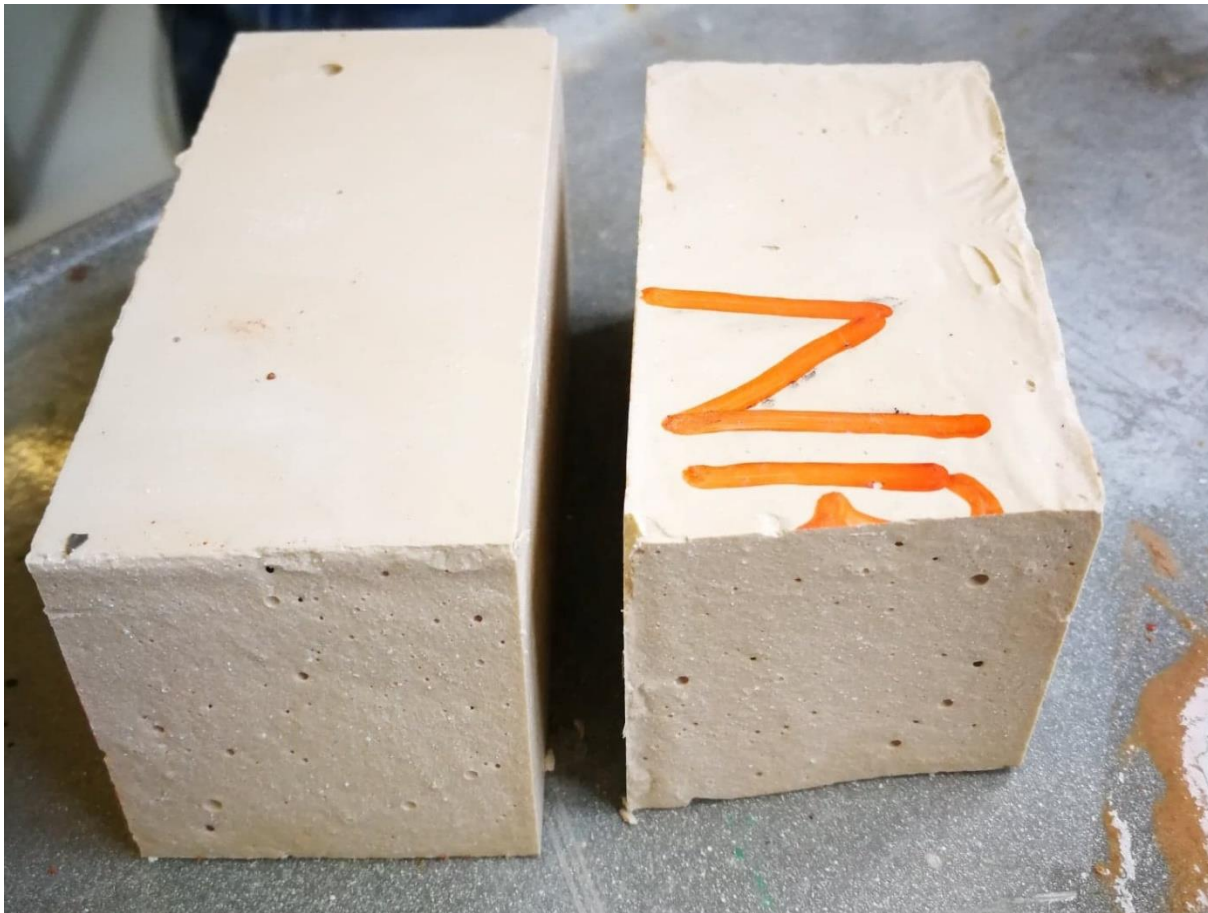
Bilde c.5.6: prisme 1: med blanding 52.7% hvit leire, 10,5% kalkstein og 36.8% hydratkalk
