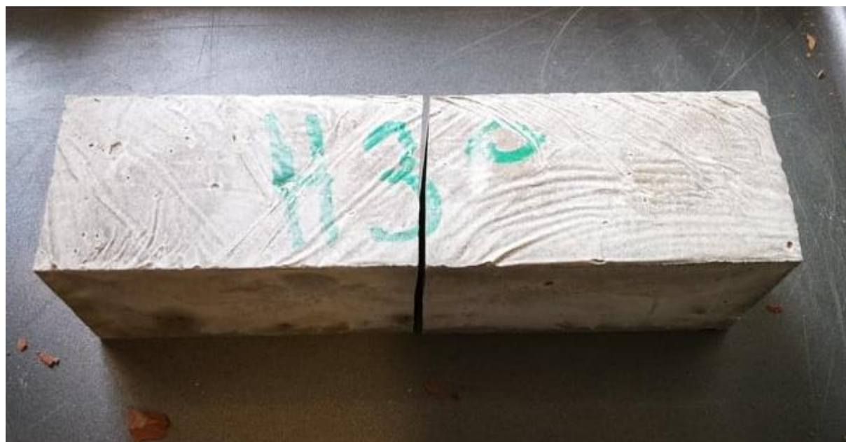
Bilde c.1.8: Prisme 2, blanding 30 % hvit leire, 15% kalkstein og 55% sement.
