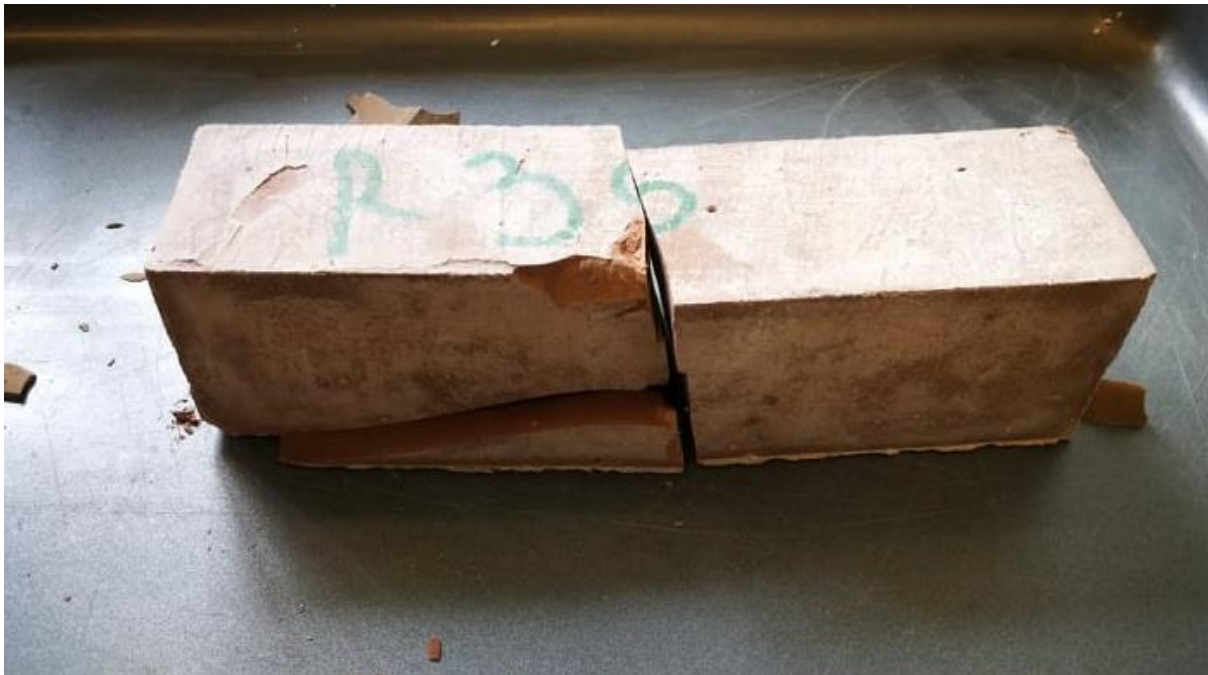
Bilde c.1.5: Prisme 1, blanding 30 % Rød leire, 15% kalkstein og 55% sement.
