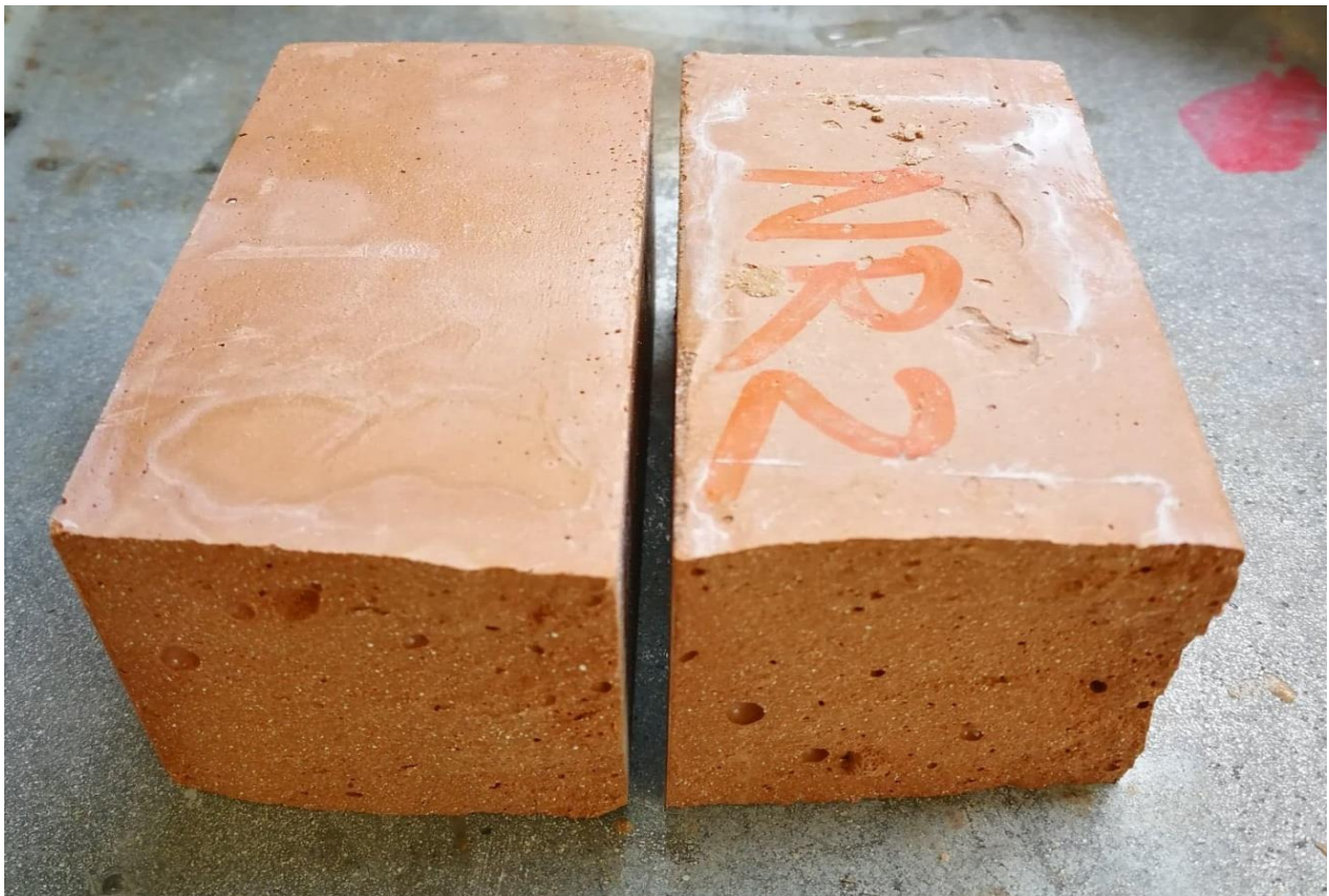
Bilde c.5.3: prisme 2: med blanding 52.7% leire, 10,5% kalkstein og 36.8% hydratkalk
