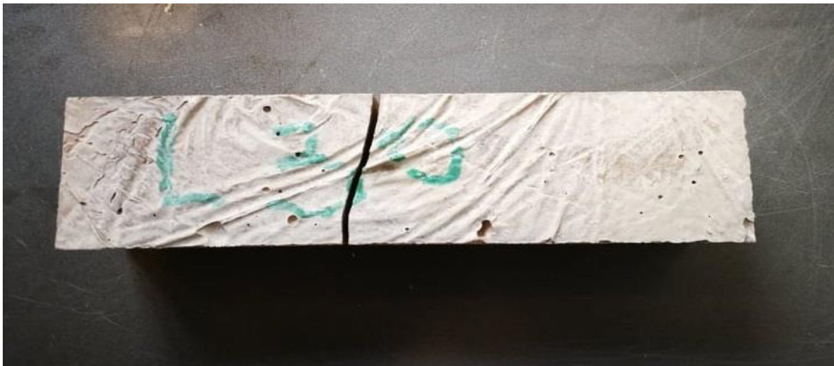
Bilde c.1.1: Prisme 1, blanding 30 % lokal leire, 15% kalkstein og 55% sement.
