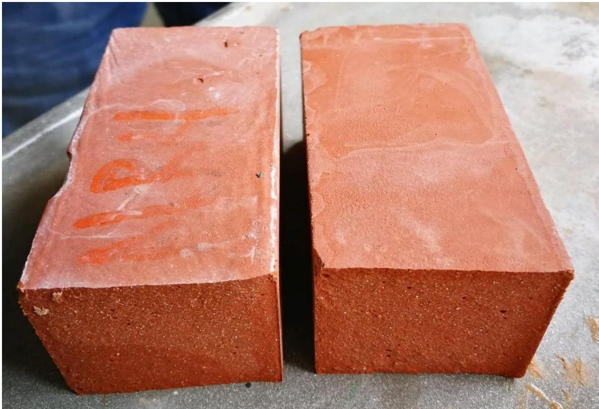
Bilde c.5.4: prisme 1: med blanding 52.7% rød leire, 10,5% kalkstein og 36.8% hydratkalk
