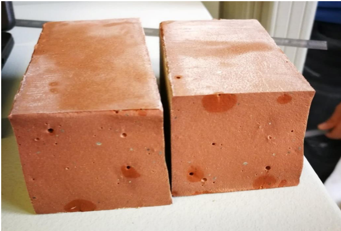
Bilde c.2.5: Prisme 1, blanding 30 % rød leire, 15% kalkstein og 55% sement.
