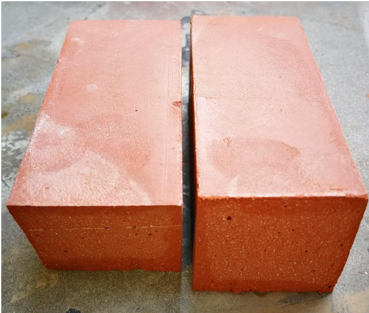
Bilde c.5.5: prisme 2: med blanding 52.7% rød leire, 10,5% kalkstein og 36.8% hydratkalk
