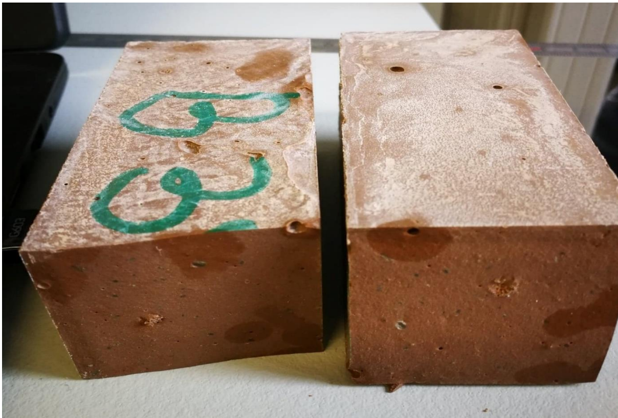
Bilde c.2.4: Prisme 2, blanding 30 % blå leire, 15% kalkstein og 55% sement.
