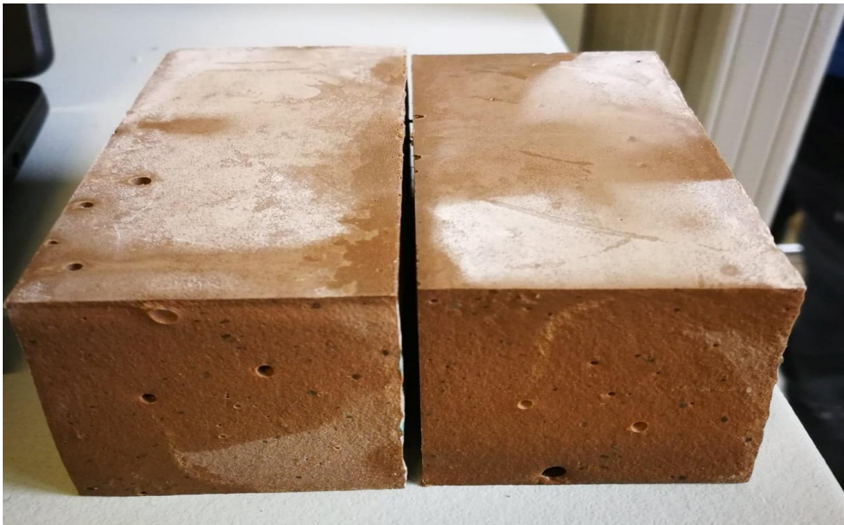
Bilde c.2.1: Prisme 1, blanding 30 % lokal leire, 15% kalkstein og 55% sement.
