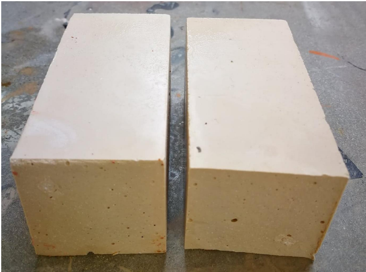
Bilde c.5.7: prisme 2: med blanding 52.7% hvit leire, 10,5% kalkstein og 36.8% hydratkalk
