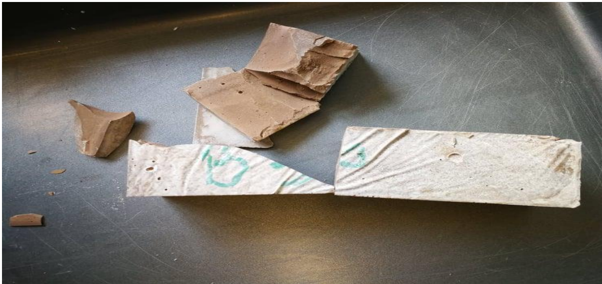
Bilde c.1.4: Prisme 2, blanding 30 % blå leire, 15% kalkstein og 55% sement.
