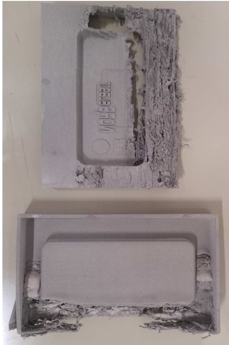
Figur 5: Resultatet av en mislykket print i Alumide
