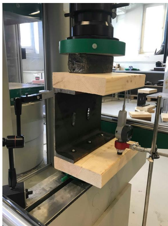
Figur 16: Prøvestykket ved endt trykktest
