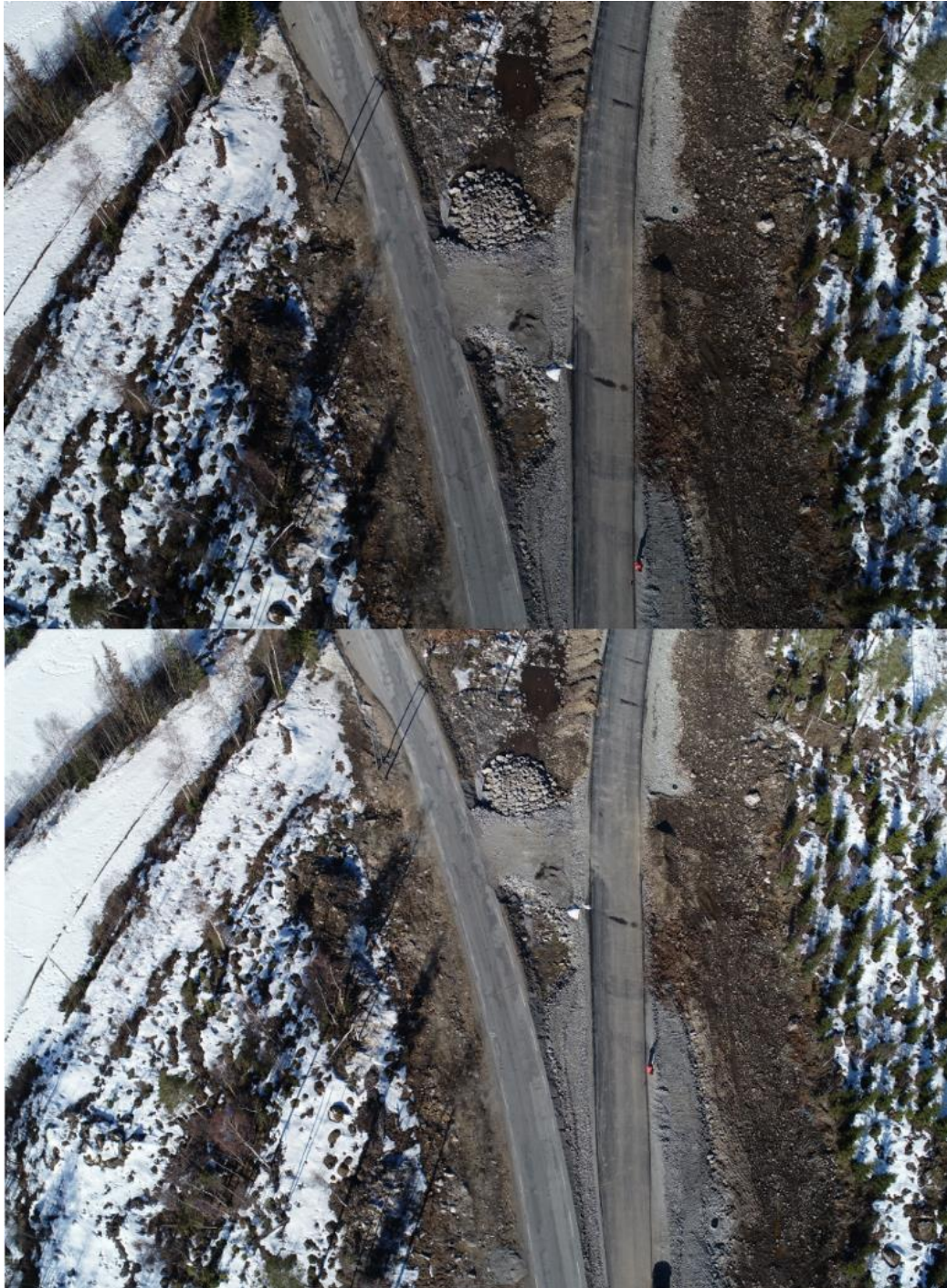
Figur 23: Lysforskjell på Dji sine bilder. Det øverste bildet er litt mørkere. Begge bildene har kamerainnstillingene ISO-100 og lukkertid på 1/2000sek. Øverste bildet har en blenderåpning på f-3,2 og nederste bildet har en blenderåpning på f-2,8.
