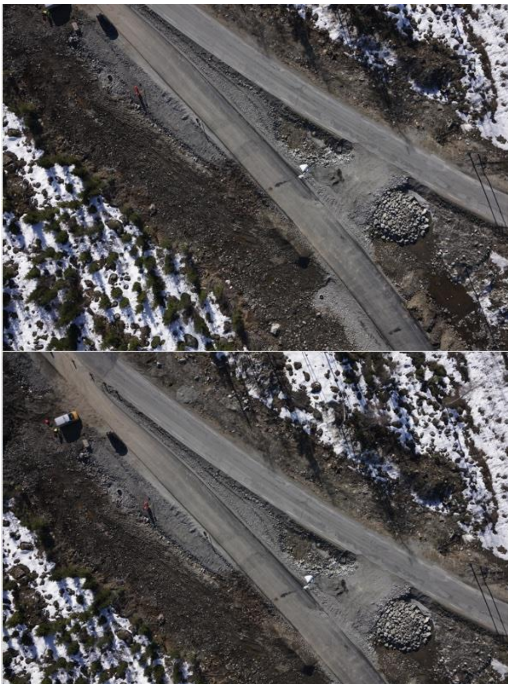
Figur 24: Ikke lysforkjeller på Wingtra sine bilder. Begge bildene har kamerainnstillingene ISO-320, lukkertid på 1/2000sek og blenderåpning på f-4,5.
