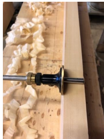
Figur 23. rissing av riktig dimensjon
