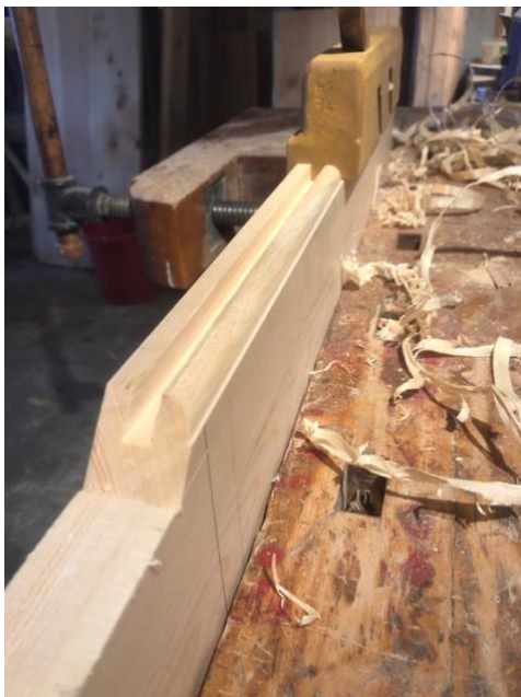
Figur 28. Høvling av not og profil.
