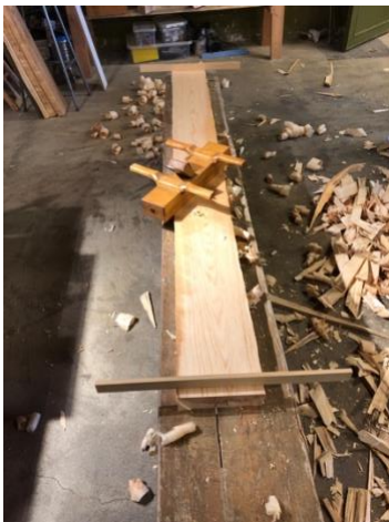
Figur 22. Avretting med skrubbokse
