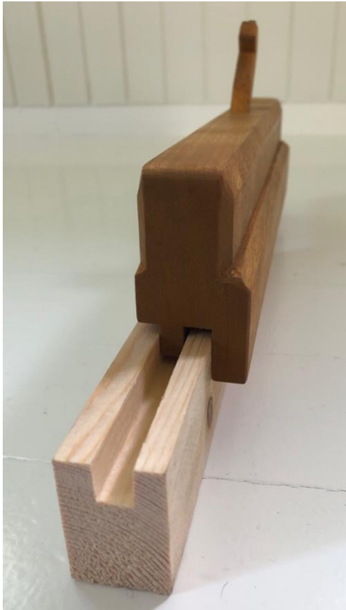
Figur 15. fast nothøvel som høvler not som er tilpasset slik at fjæren vil gå inn i notsporet.
