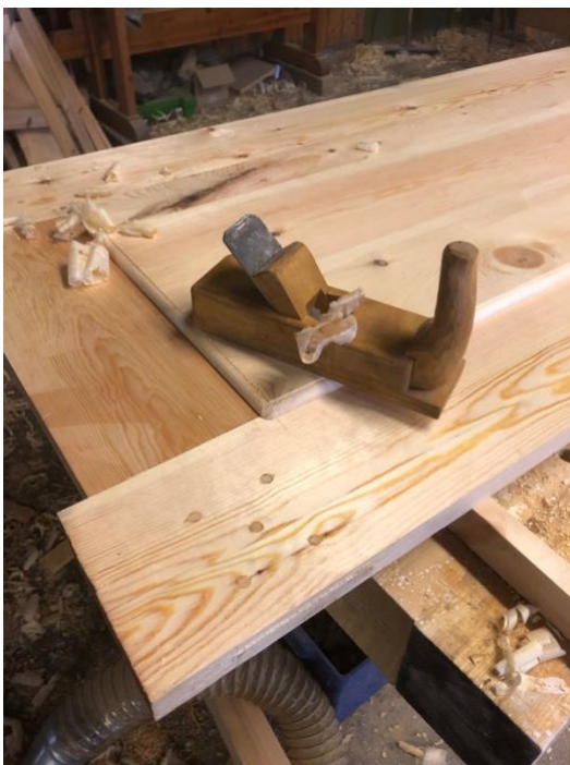
Figur 32. Pussing av sammenføyninger.
