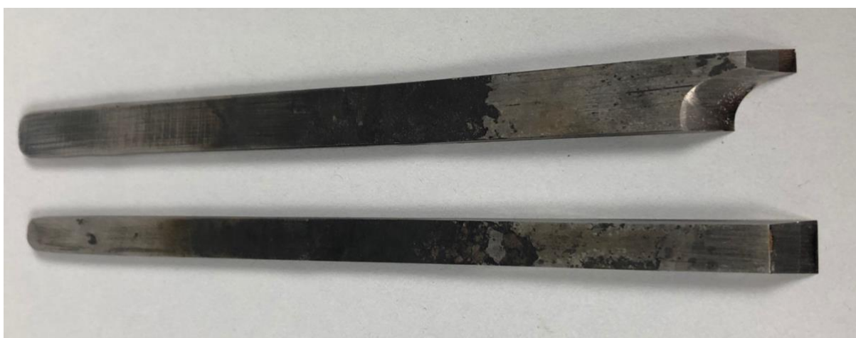
Figur 18. Her ser man at man lett kommer til for å kvesse profilstålet.
