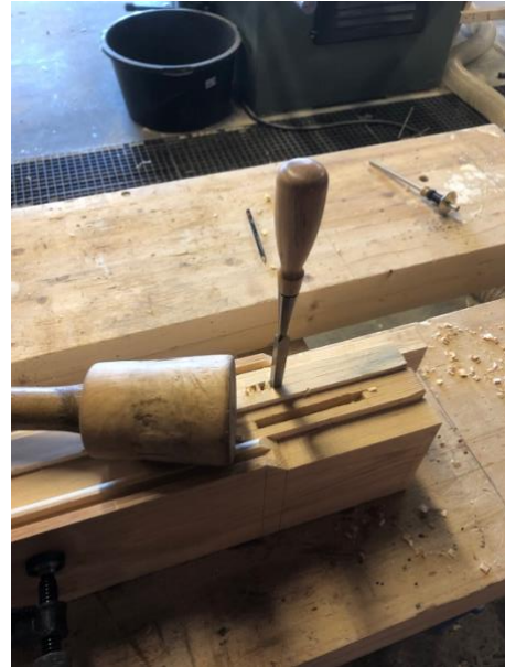
Figur 26. Hugging av tapphull.
