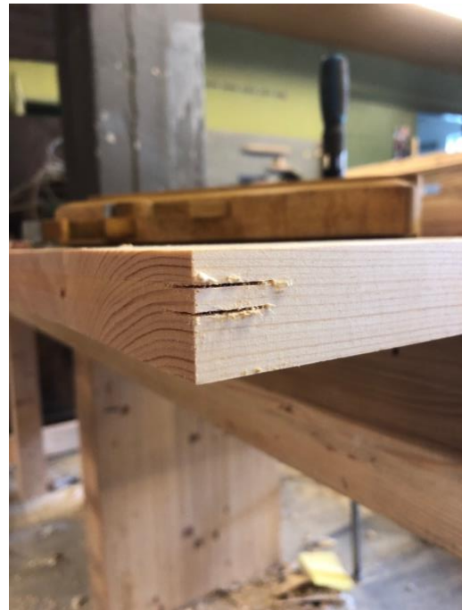
Figur 30. Kom til at ved å sage små snitt i enden unngår man utrivning.
