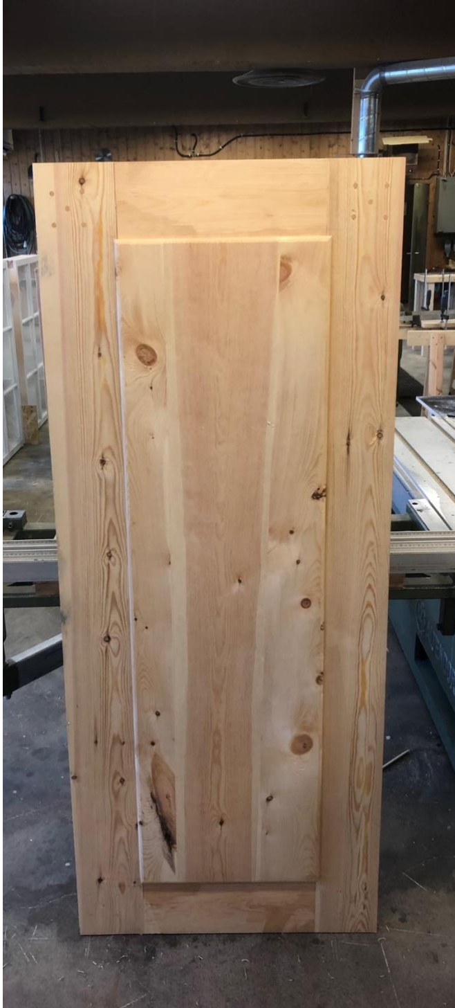
Figur 33. Enfyllingsdør der not og profil er høvlet med en og samme høvel.
