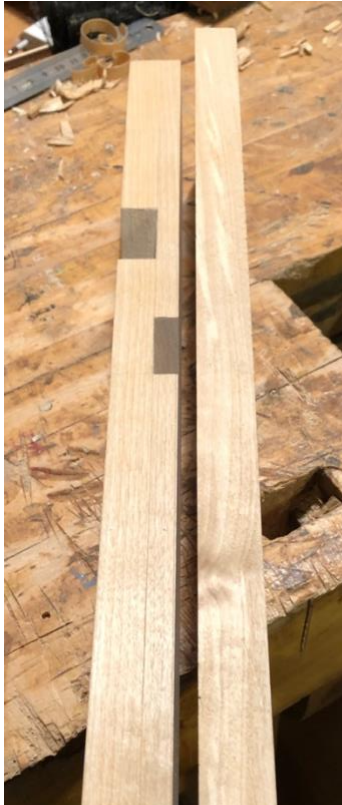
Figur 8. Viser hoved stokken med ut saging for stål og kile.
