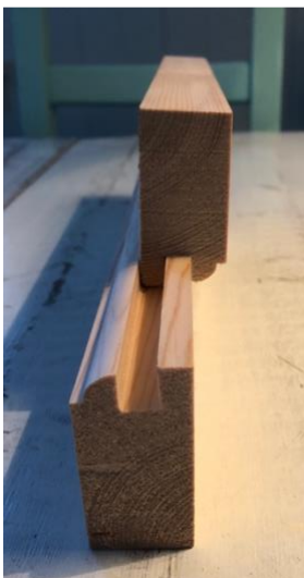
Figur 1. To prøvestykker der man ser notsporet og profilen. Dette endevendes slik at profilen kommer på hver sin side og ramtre og fylling blir senterforskjøvet.
