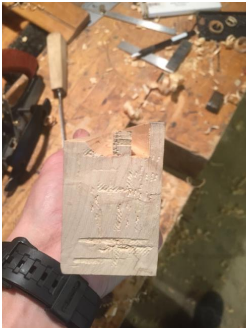
Figur 13. Såle ferdig høvlet og tilpasset.
