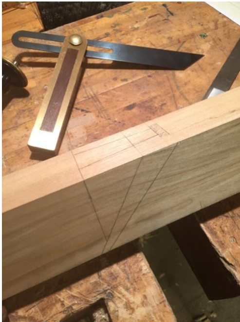
Figur 11.. Høvel HS B2 ferdig oppmerket for hugging.
