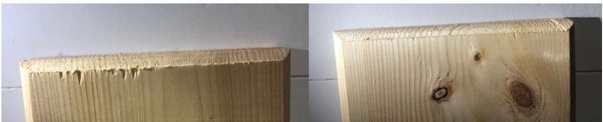
Figur 14. Prøvestykke til venstre er høvlet med høvel HS B3/1 og 2 her ser man utrivningene jeg fikk i endeveden. Prøvestykke til høyre er høvlet med høvel HS B5.
