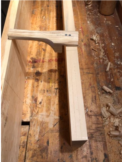
Figur 25. Merking av tapp med fast rippmot
