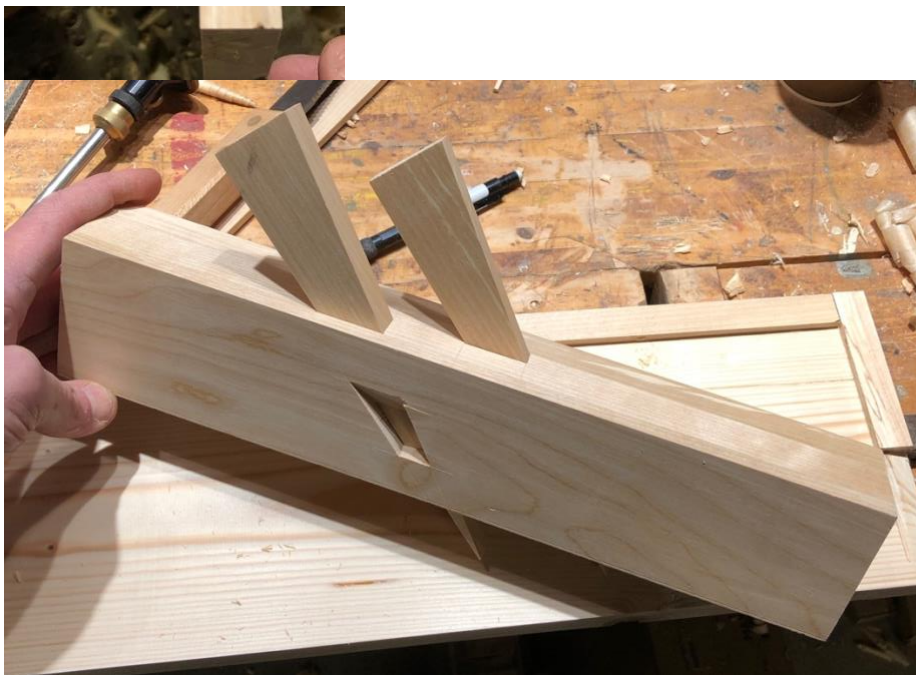
Figur 9. Høvelen med ferdig pålimte skiver i sidene.
