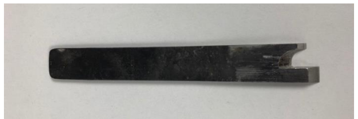
Figur 14. Stålet til høvel HS B2. her ser man overgangen mellom not og profilen som er vanskelig å slipe.
