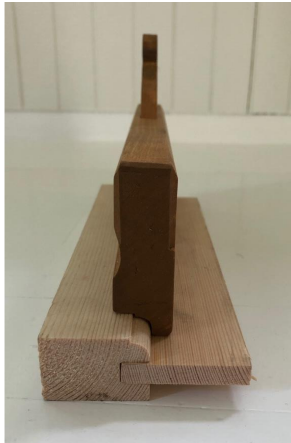
Figur 14. kvarstaff høvel som bruker løs fjær som dybdestopp.
