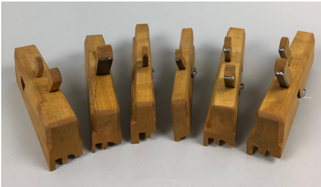
Figur 6. Her er fra venstre mot høyre høvlene som er laget i forbindelse med oppgaven. De ligger her i nummerert rekkefølge fra 1-5 de er nummerert fra HS B1 til HS B5 Not og kvartstaffhøvel er merket henholdsvis HS B3/1 og HS B3/2
