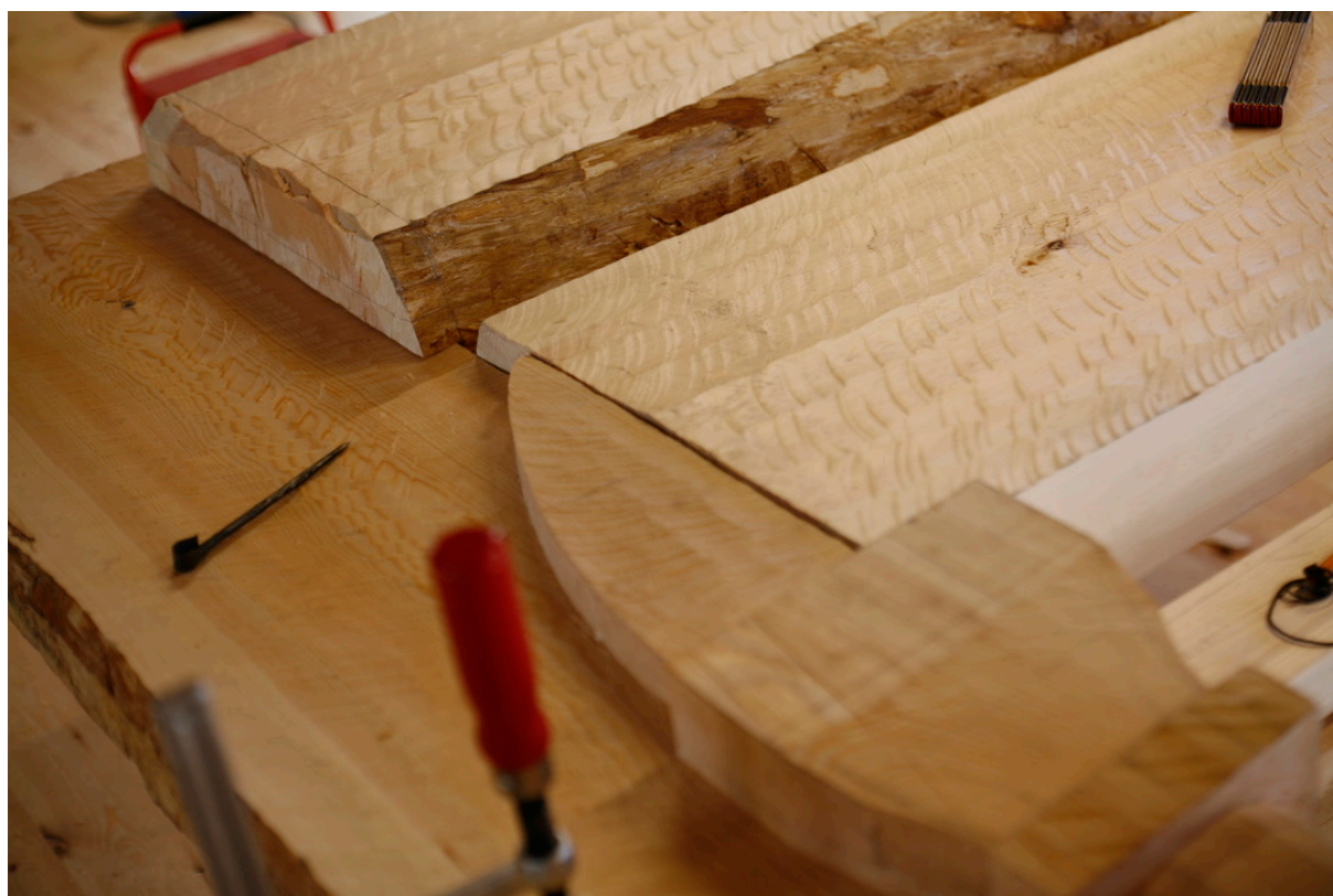
Bilde 79: Det loddes opp merking av lengden på baksiden av overstykkene. Fotograf: forfatter
