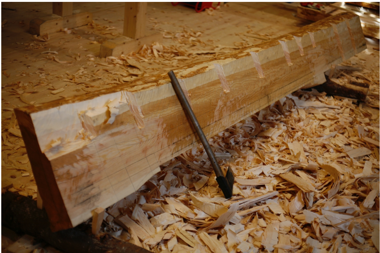
Bilde 35: Skåring og lomping av veggiledelen til venstre vangetile. Fotografi: forfatter
