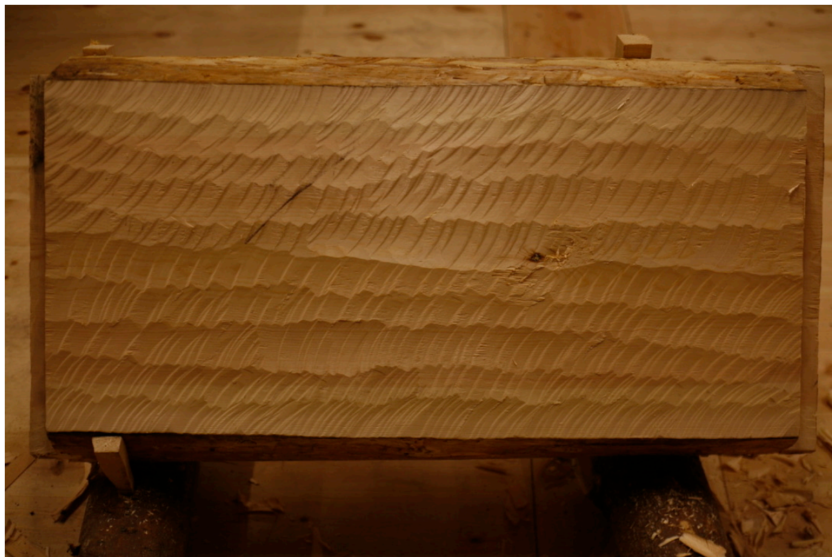
Bilde 81: Det nedre overstykket dimensjonert mot arkivoltnakkens tykkelse. Fotograf: forfatter
