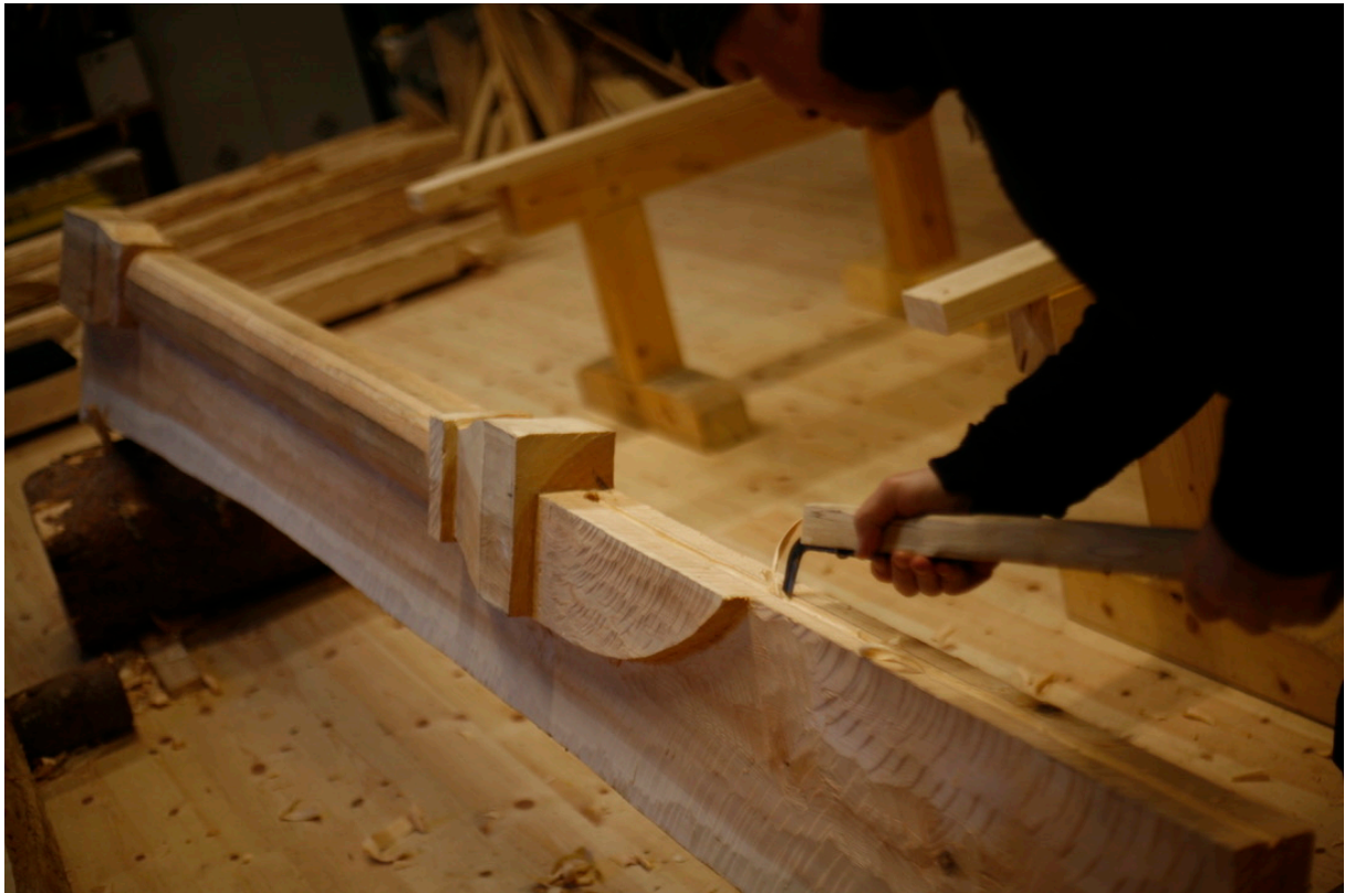
Bilde 63: Roald Renmølmo huler ut grøysporet med grøypjern. Fotograf: forfatter
