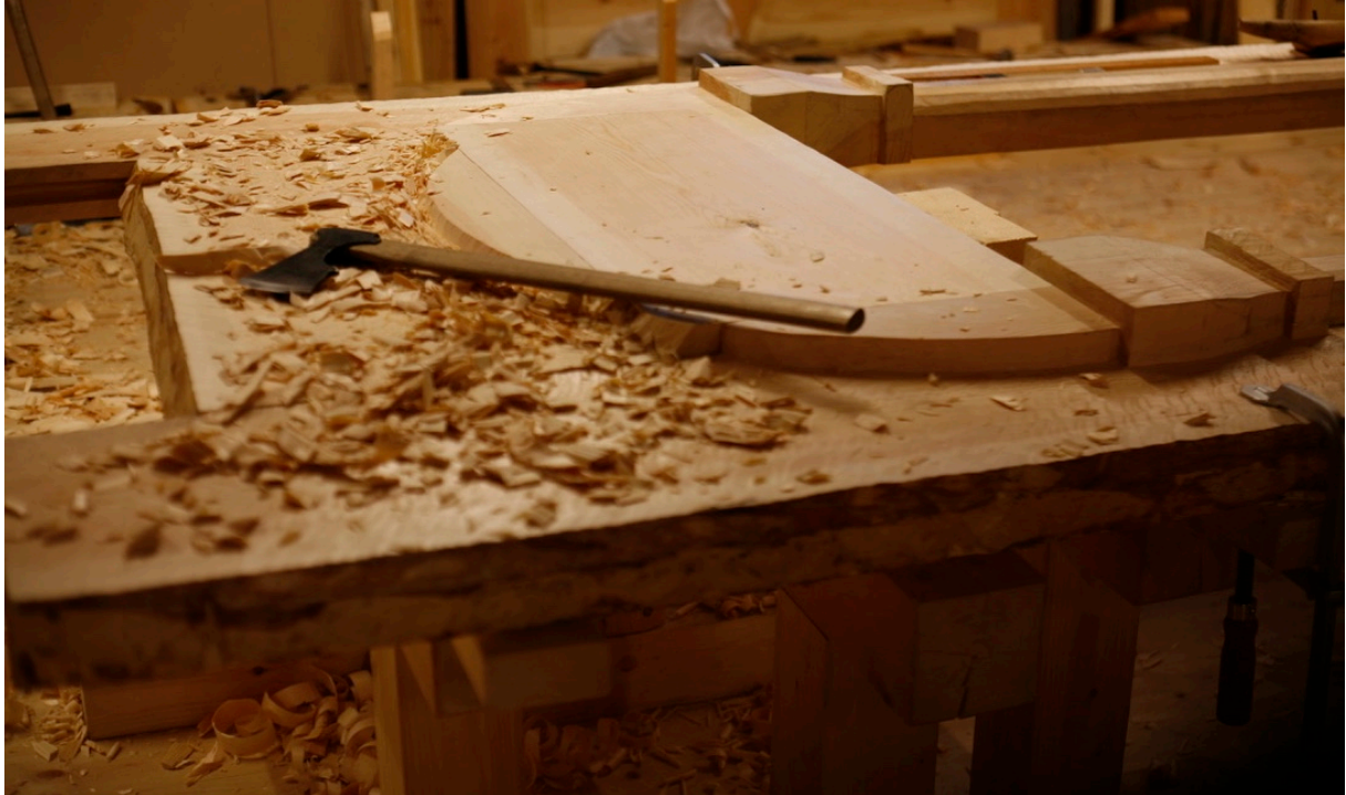
Bilde 103: Grovhogging av ekstrados til arkivolten på øvre overstykke. Fotograf: forfatter
