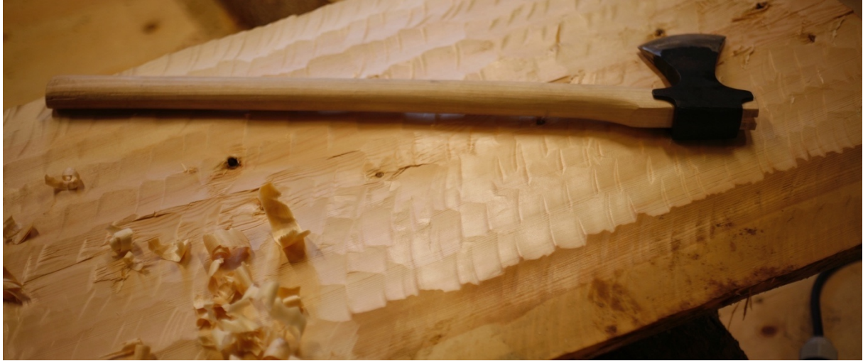
Bilde 26: Glepphoggarøks og glepphogging av margsiden. Fotograf: forfatter
