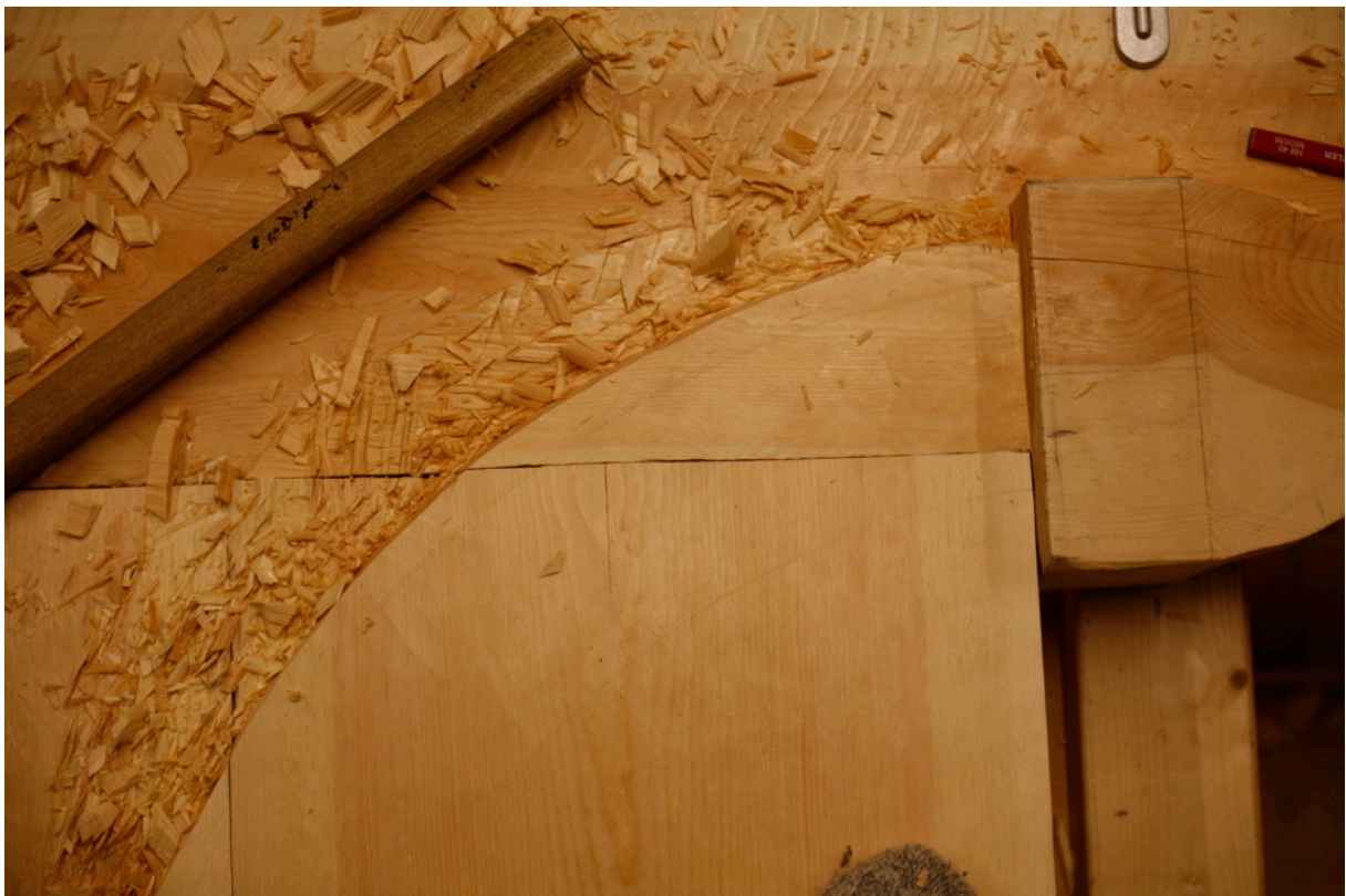
Bilde 108: Grovhogging av ekstrados til arkivoltnakken. Fotograf: forfatter
