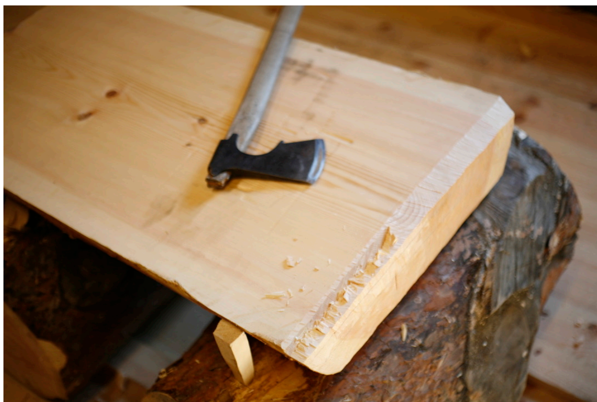
Bilde 75: Hogging med framhytta til en snekkerbile, av margsiden til tappen. Hoggingen bryter ut fibrene og krever en del kraft. Man jobber seg nesten helt ned, men gradvis innover mot strek. Fotograf: forfatter
