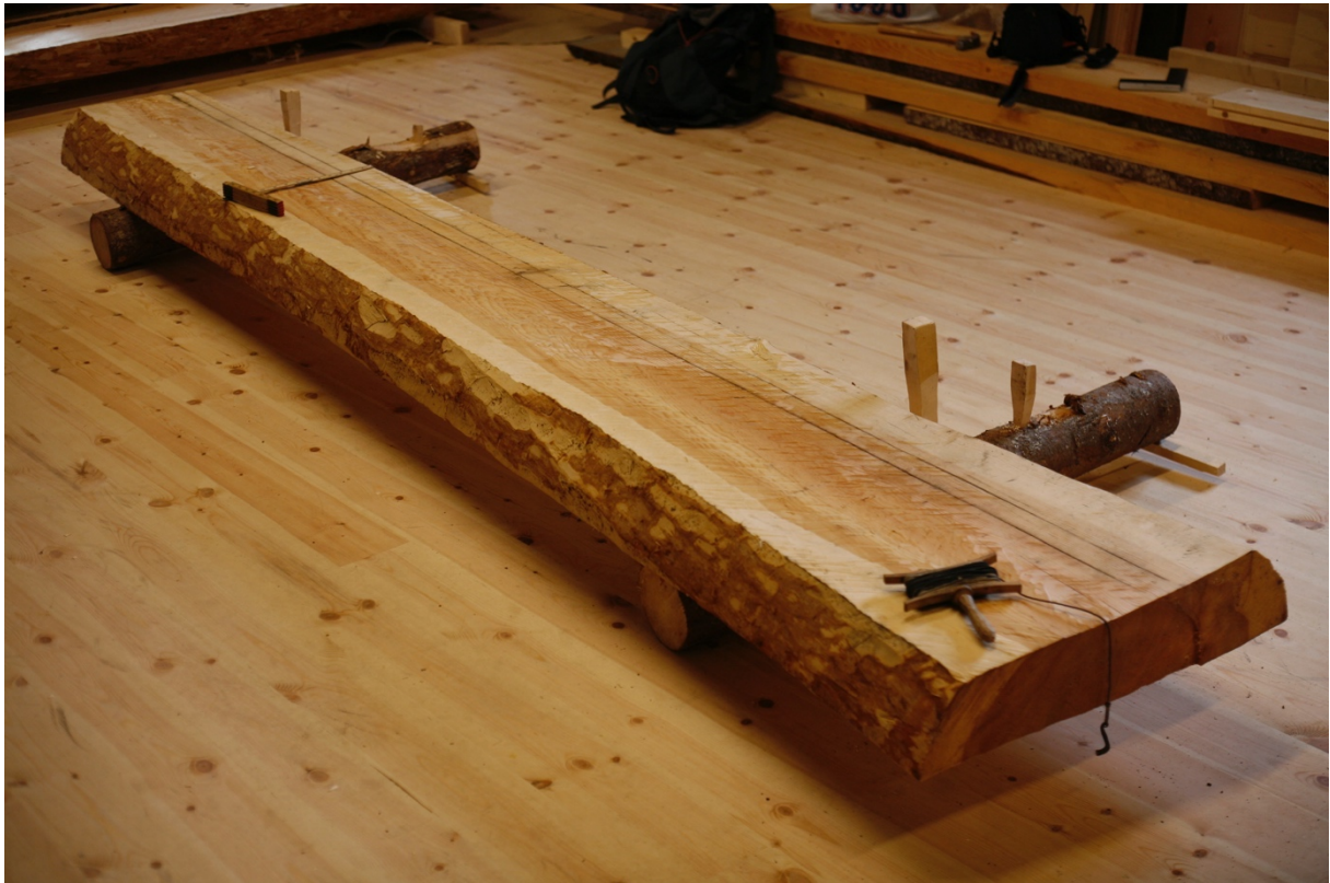
Bilde 28: Snorslåing med sotsnor for merking av referanselinjer. Fotograf: forfatter
