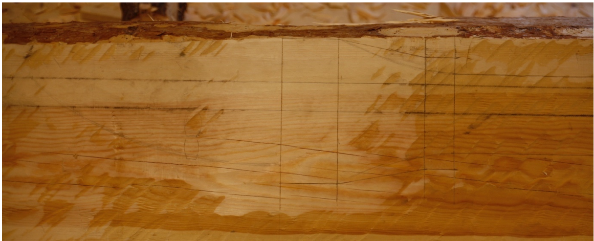
Bilde 31: Merking av kapitelet. Det svake merket av en bue over (til venstre på bildet) er et overmål til arkivoltnakken, slik at arkivolten kan merkes senere når alle delene til portalen er montert. Fotografi: forfatter
