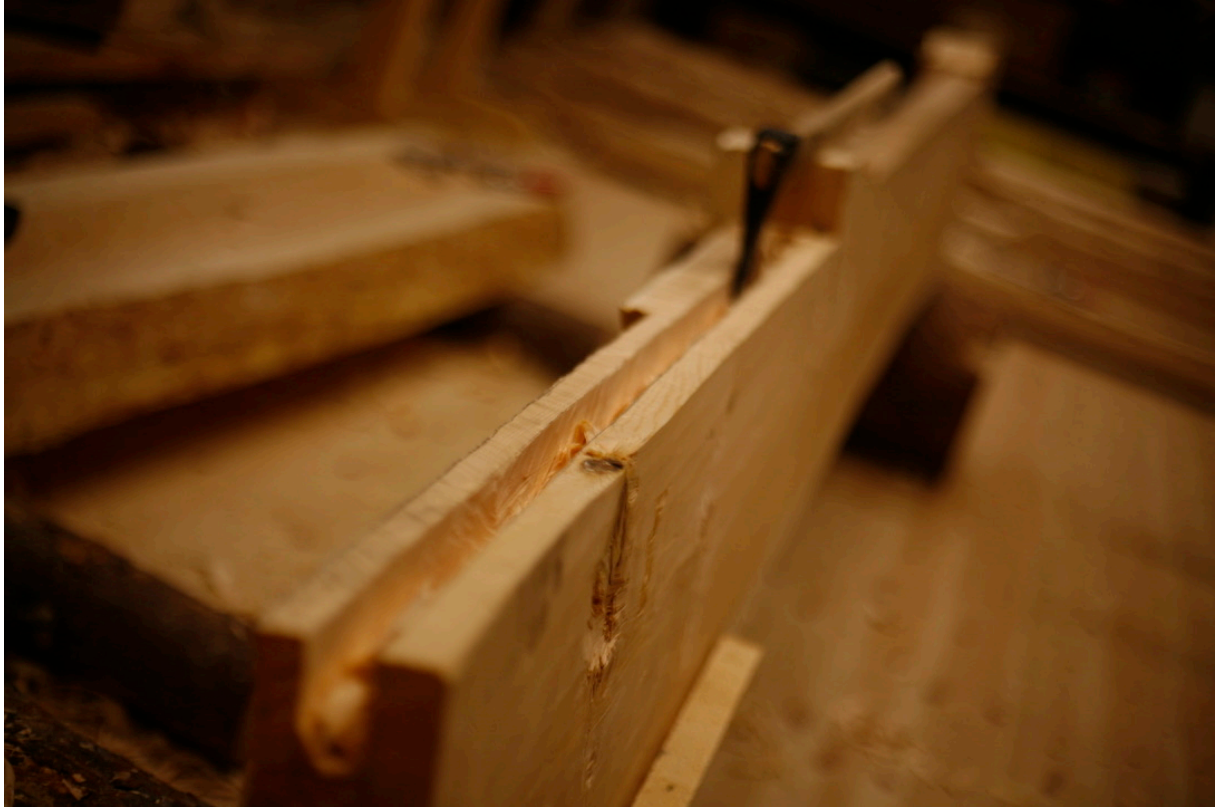
Bilde 66: Retting av sidene til grøypsporet. Fotograf: forfatter
