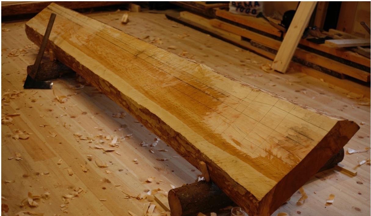
Bilde 29: Søyle merket på vrangsiden av emne til vangetile. Flatene ved kapitelet og basen er pjålet før merking, men basen er trukket inn fra kanten for å få mer dimensjon på vangetilen i toppenden. Fotograf: forfatter
