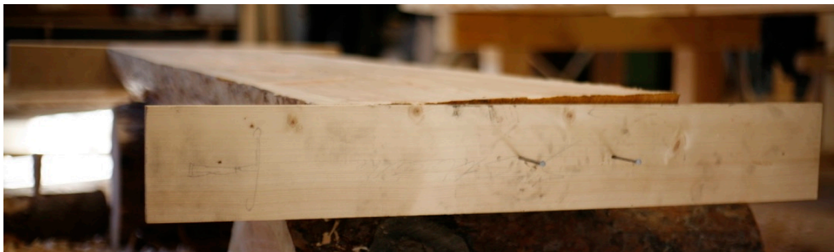
Bilde 25: Sikting av margsidene med siktestikker. Fotograf: forfatter
