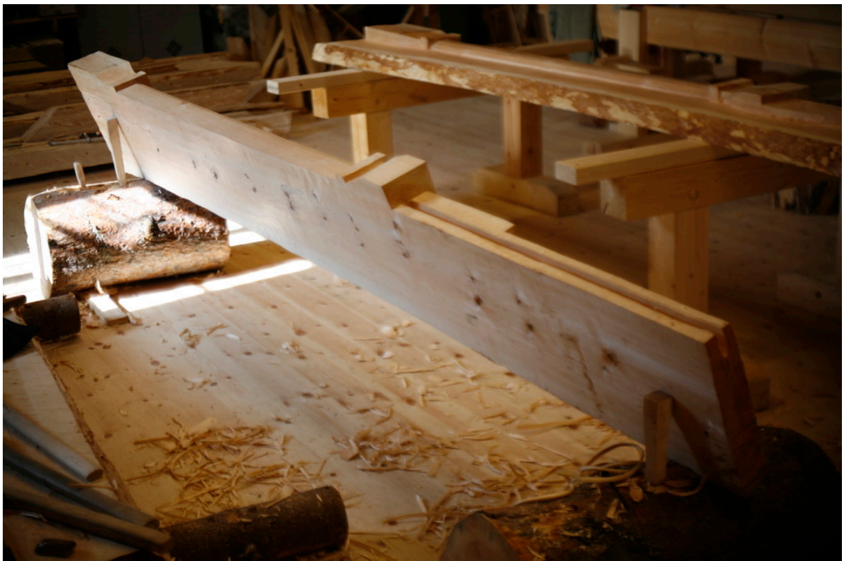
Bilde 65: Vangetile med grøypspor. Fotograf: forfatter
