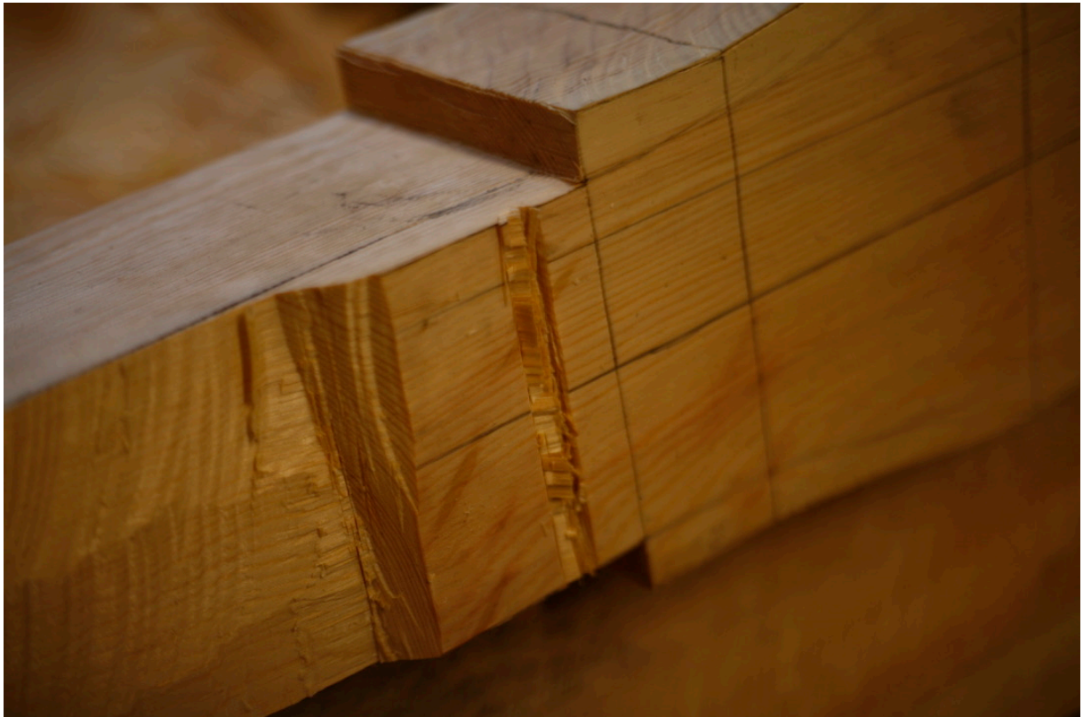
Bilde 46: Bruddflate for å beskytte halsringen under kapitelet fra utkløyvinger. Fotograf: forfatter
