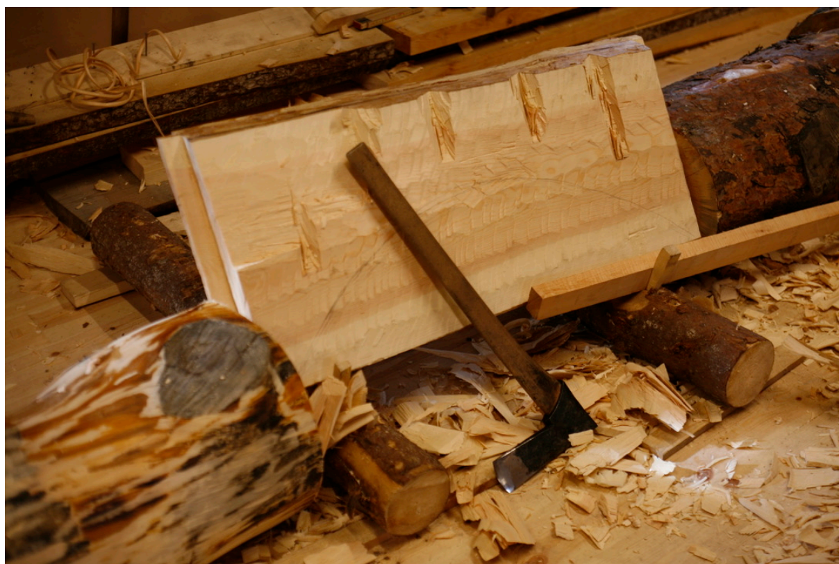
Bilde 88: Skåring og lopping av flaten rundt arkivolten på det øvre overstykket. Fotograf: forfatter
