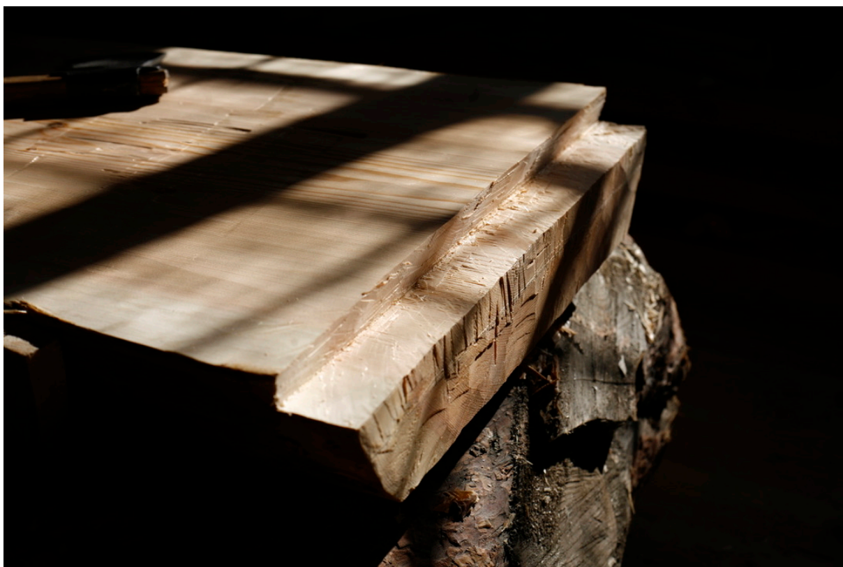
Bilde 77: Margside av tappen ferdig. Kanten med endeved er skrådd som bunnen av veggtiler. Dette var ikke et problem her siden emnet skulle meddrages i endeveden senere, men spesielt på baksiden av emnet måtte det hogges et rett plan slik at det ikke ble gliper under den endelige forming av arkivolten. Fotograf: forfatter
