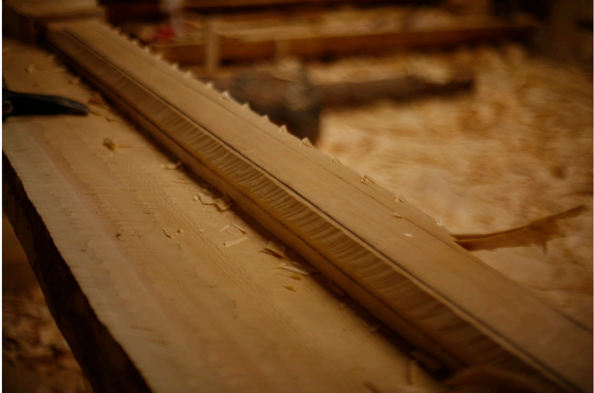
Bilde 58: Glepphogging av fasene på søyleskaftet. Fotograf: forfatter
