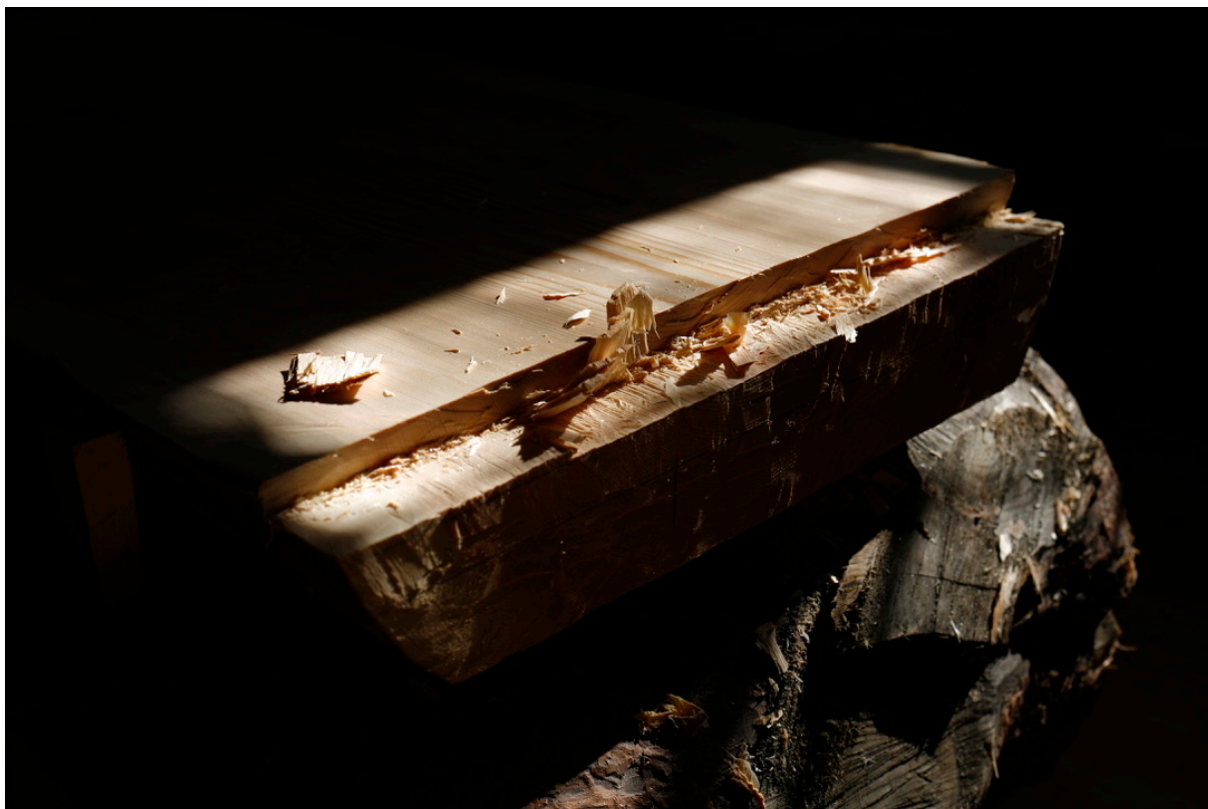
Bilde 76: Hogging fra siden langs merkene i endeveden. Fotograf: forfatter
