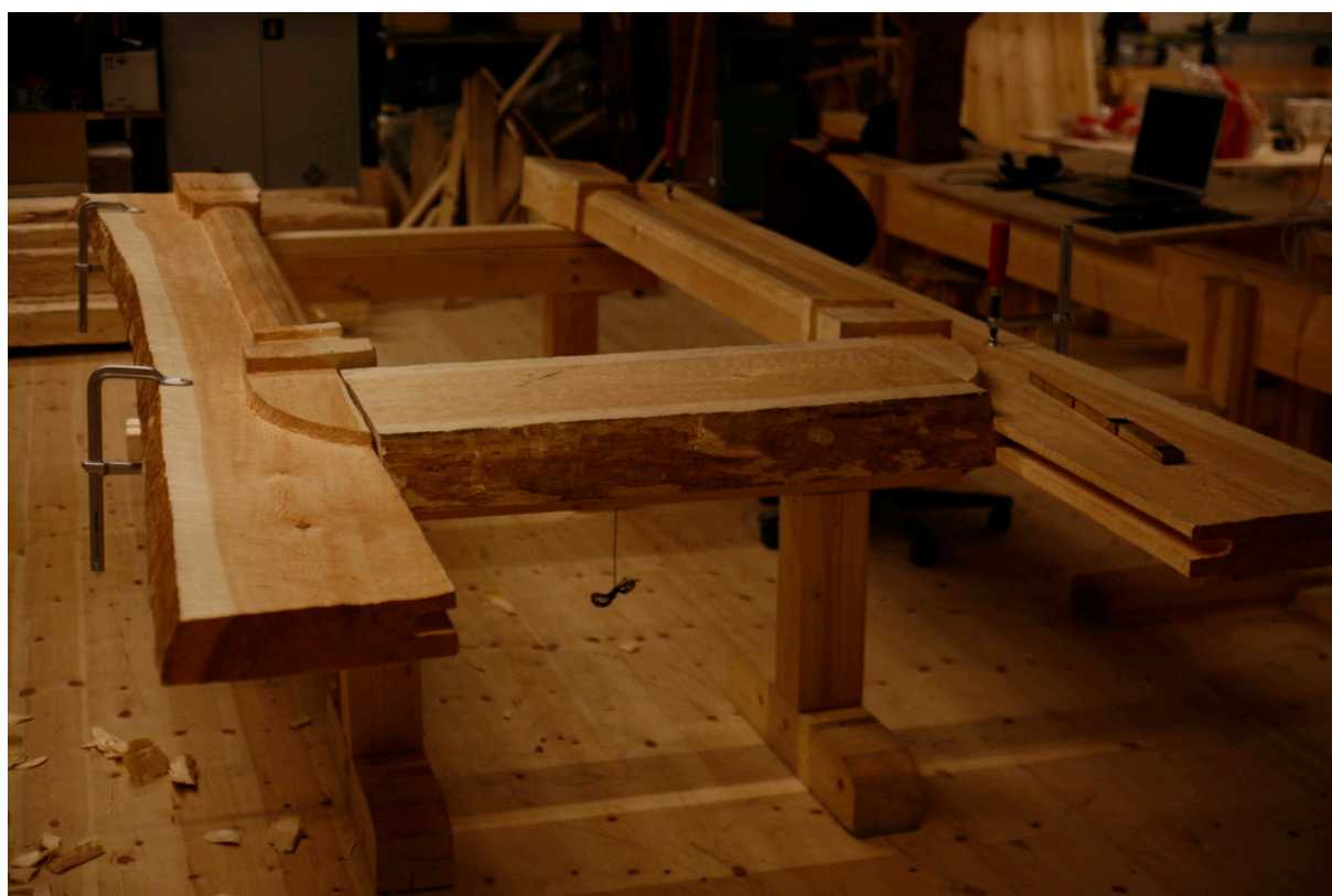
Bilde 80: Det nedre overstykket plassert mellom vangetilene. Fotograf: forfatter
