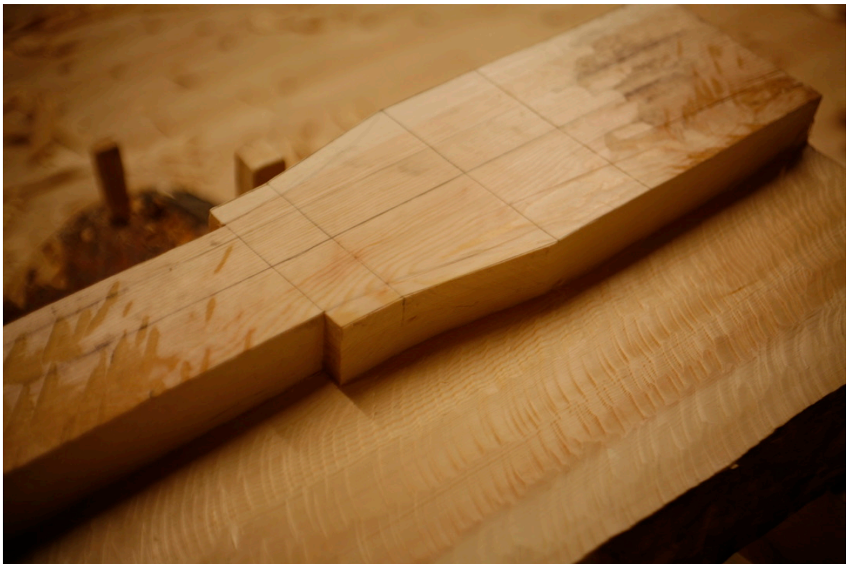
Bilde 44: Kanten til søylen mot veggiledelen ferdig slettet. Fotograf: forfatter
