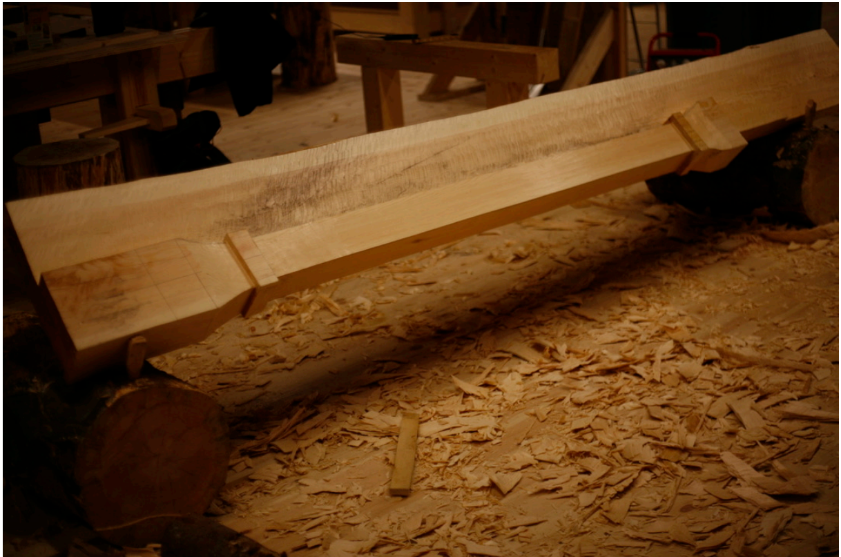
Bilde 54: Grovformen til søylen ferdig. Fotograf: forfatter
