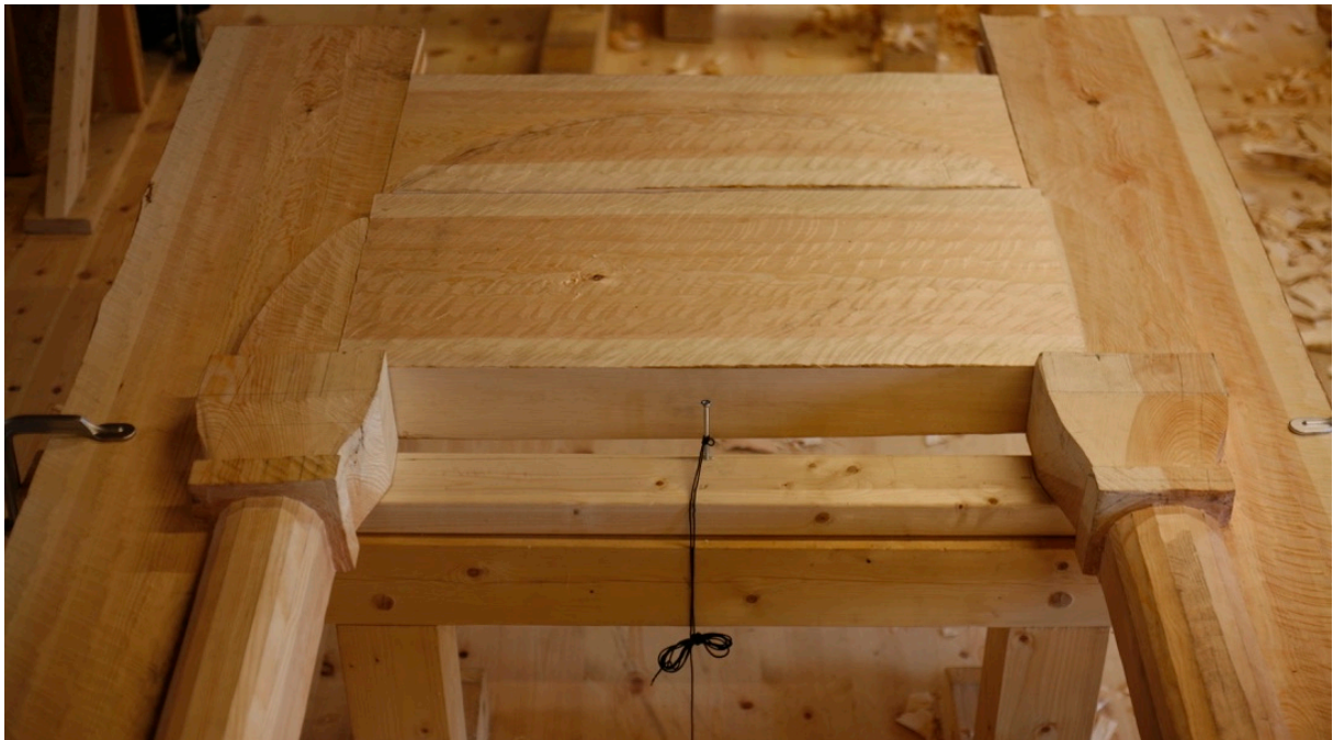
Bilde 99: Det er vanskelig å si hvor synlig slike gliper blir nedenfra når portalen er montert i vegg. Fotograf: forfatter
