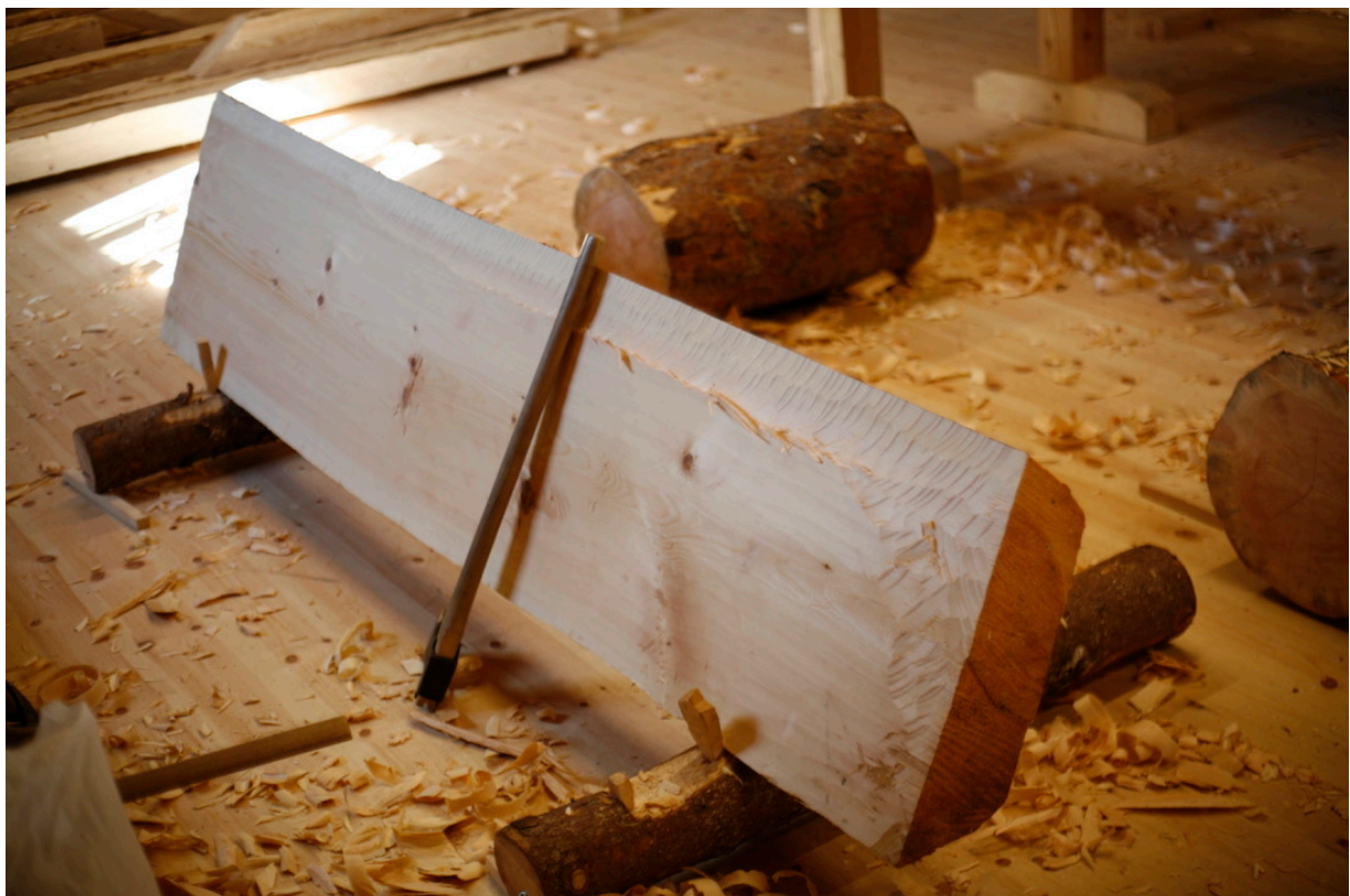
Bilde 69: Retting av vridning i emne til overligger. Fotograf: forfatter
