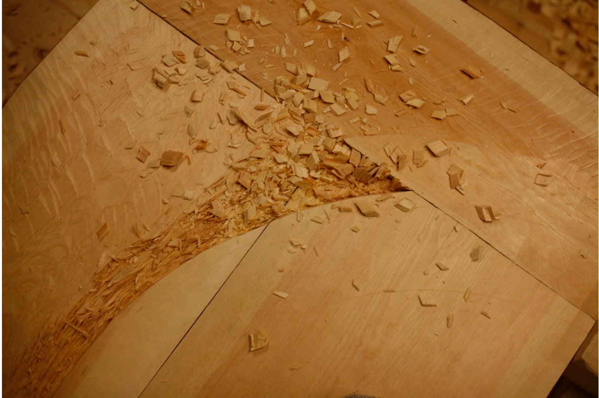
Bilde 105: Grovhogging av ekstrados til arkivolten på nedre overstykke. Det var viktig å følge med på fiberretningen på det ulike delene for å unngå utriving. Til dette var det en fordel at portalen var montert sammen. Fotograf: forfatter
