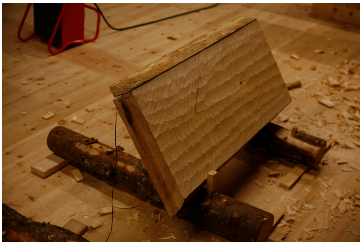
Bilde 82: Kanten på det nedre overstykket snorslått. Fotograf: forfatter
