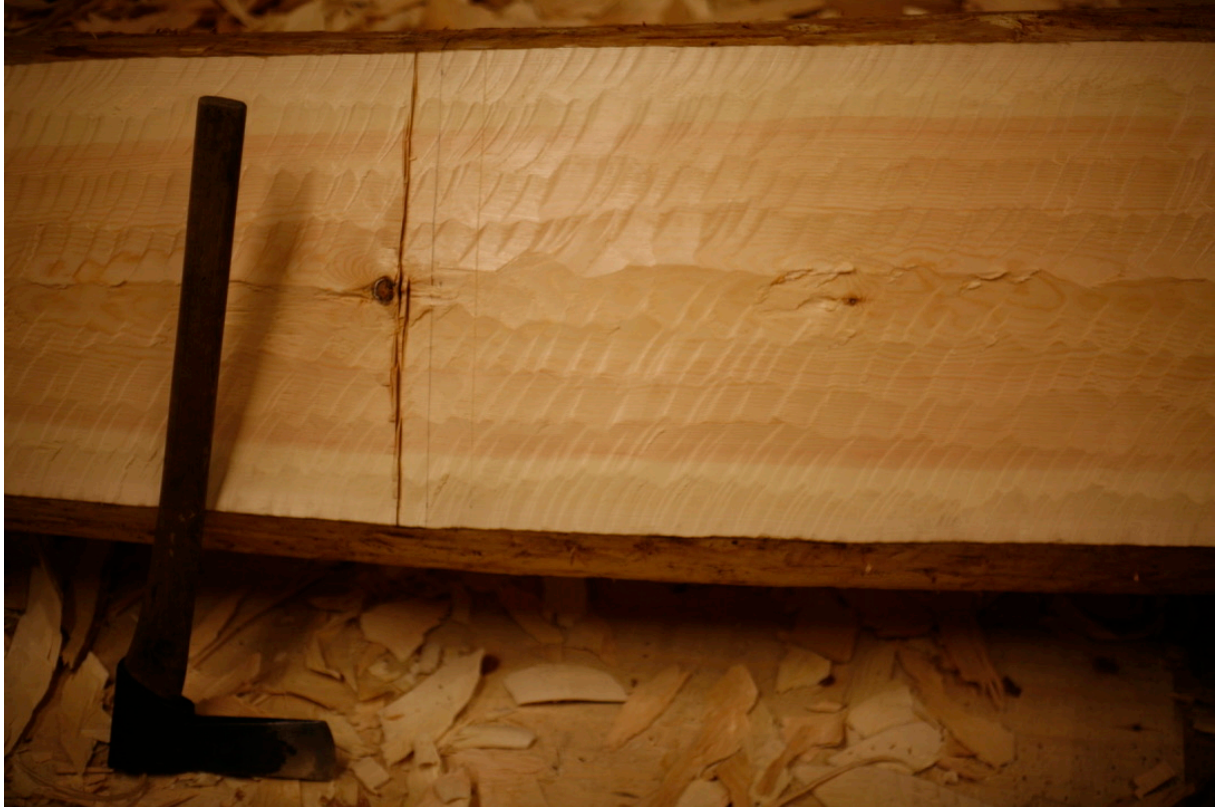
Bilde 71: Skårlinje for å få presis retning på kappeskåret og hindre utkløyving. Fotograf: forfatter
