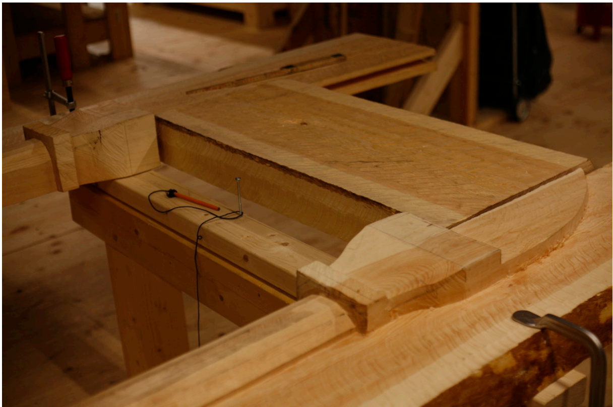
Bilde 84: Det nedre overstykket finmerket i underkant før sletting. Fotograf: forfatter
