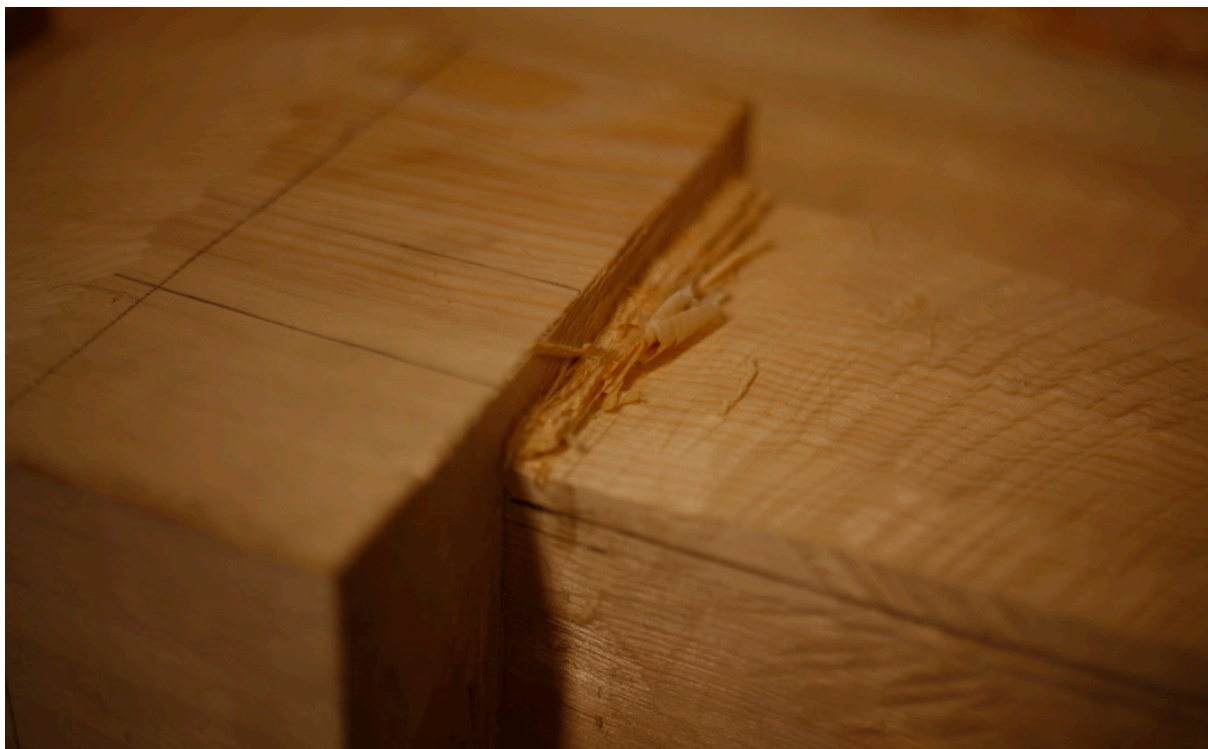
Bilde 51: Her går fibrene opp og inn i abakusblokken. Da er det lett å få en fin avslutning, men fort gjort at noe av abakusblokken kløyver ut. Fotograf: forfatter
