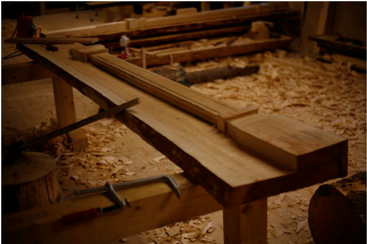
Bilde 56: Merking av fasene på søyleskaftet. Fotograf: forfatter
