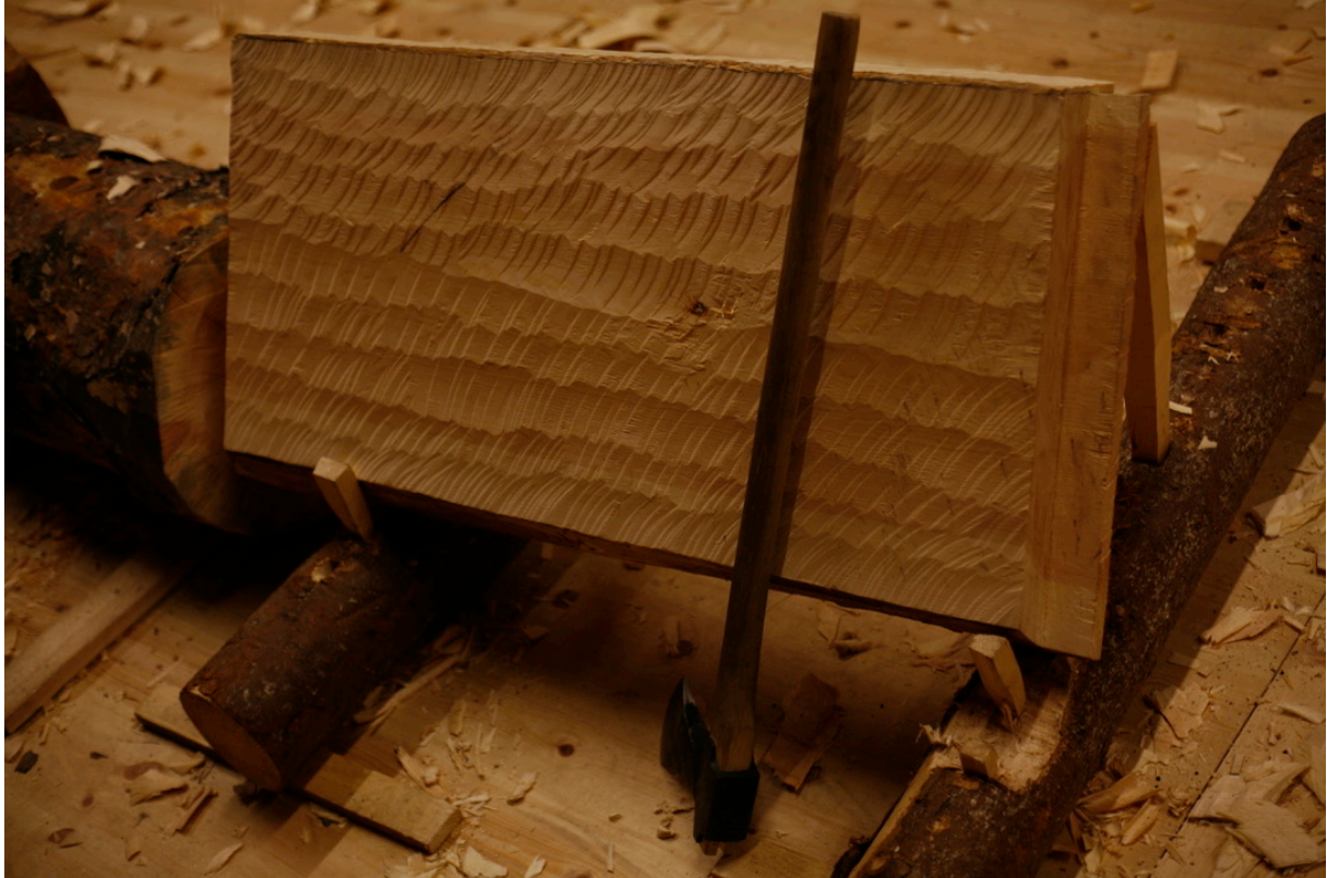
Bilde 83: Det nedre overstykket kantet i underkant med glepphoggarøks. Fotograf: forfatter
