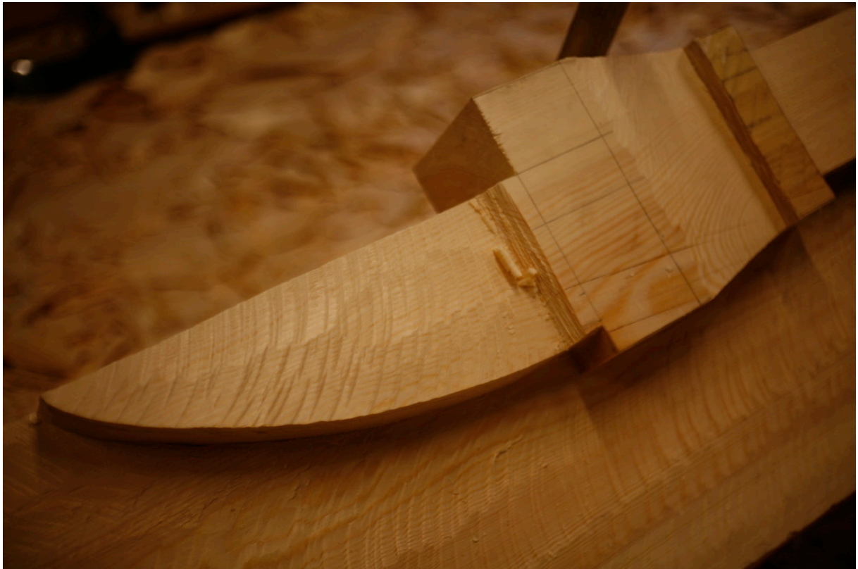
Bilde 50: Det var viktig å passe på banen til øksa rundt halsringene, og når mulig legge den slik at den ikke kunne treffe halsringene om hogget glapp. Fotograf: forfatter
