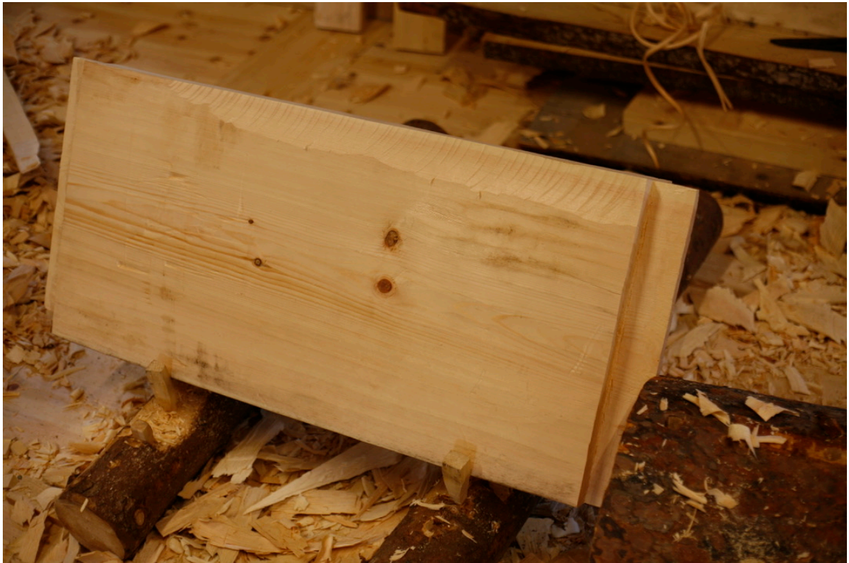
Bilde 93: Finjustering av margsiden under meddraging. Fotograf: forfatter
