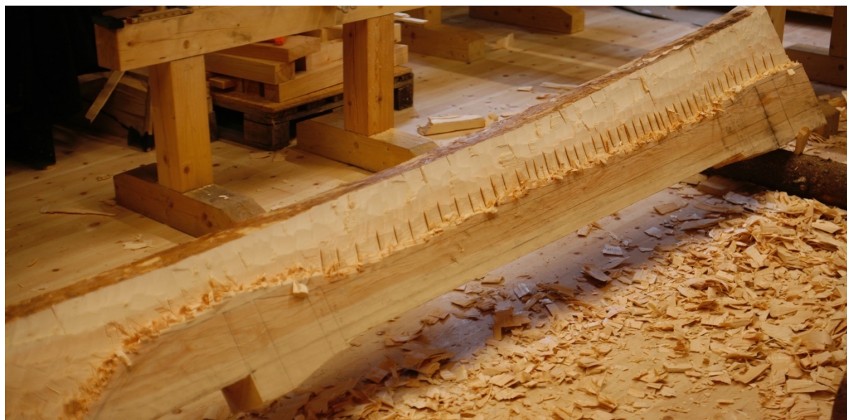
Bilde 37: Skvellet inn mot falsen mellom veggtilledelen og søylen. Fotografi: forfatter
