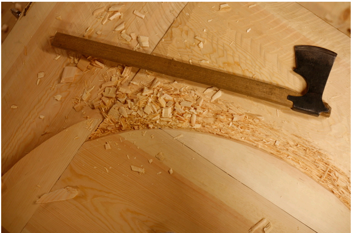
Bilde 106: Nærbilde av grovhogging av ekstrados til arkivolten på nedre overstykke. Fotograf: forfatter
