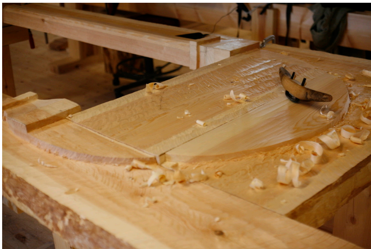
Bilde 100: Sletting med pjål av flaten til arkivolten. Fotograf: forfatter
