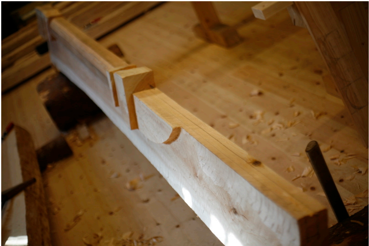
Bilde 61: Merking av grøypesporet. Fotograf: forfatter
