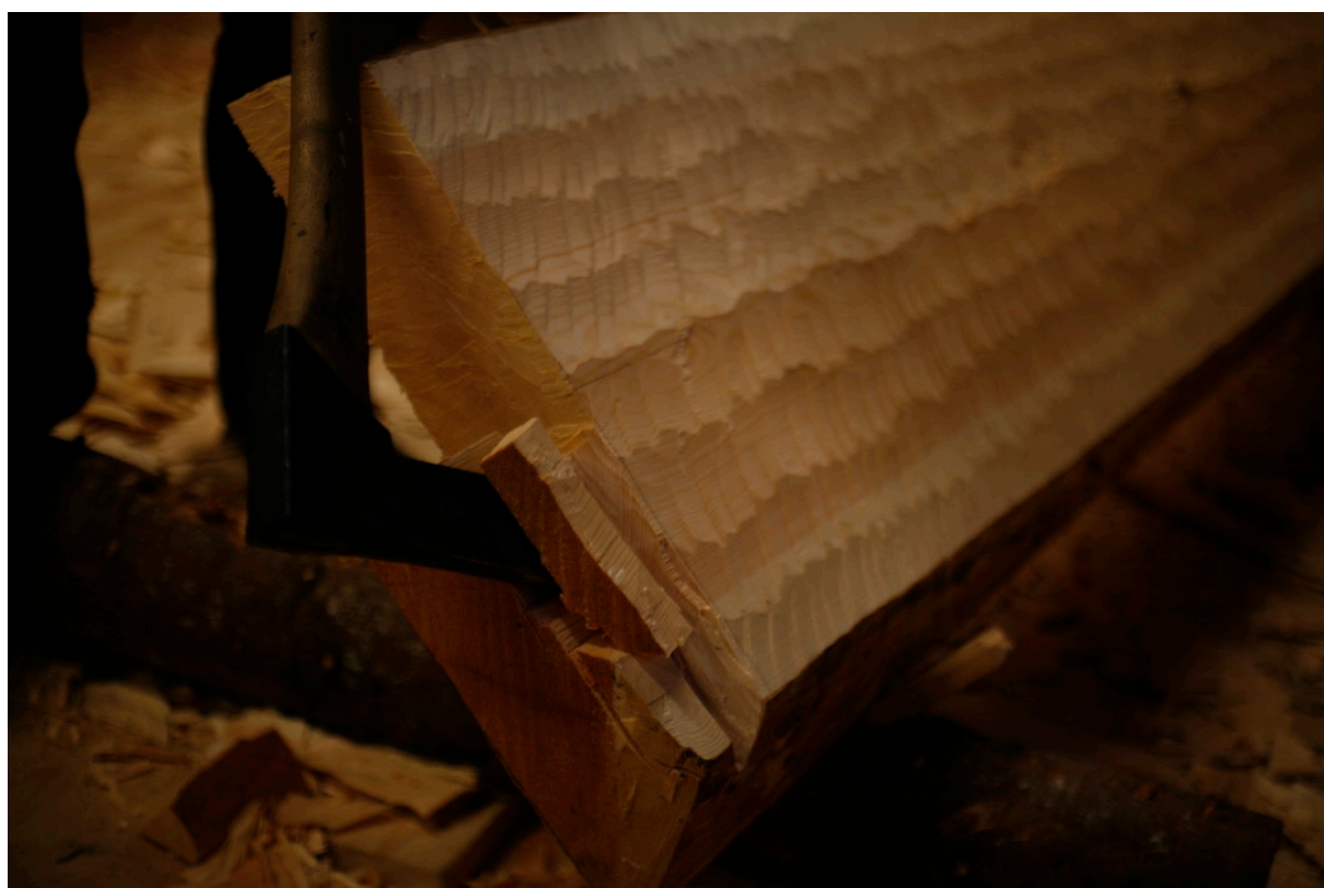
Bilde 70: Kaping av enden på emnet. Det skåres og kløyves ut vekselvis nedover i emnet. Fotograf: forfatter
