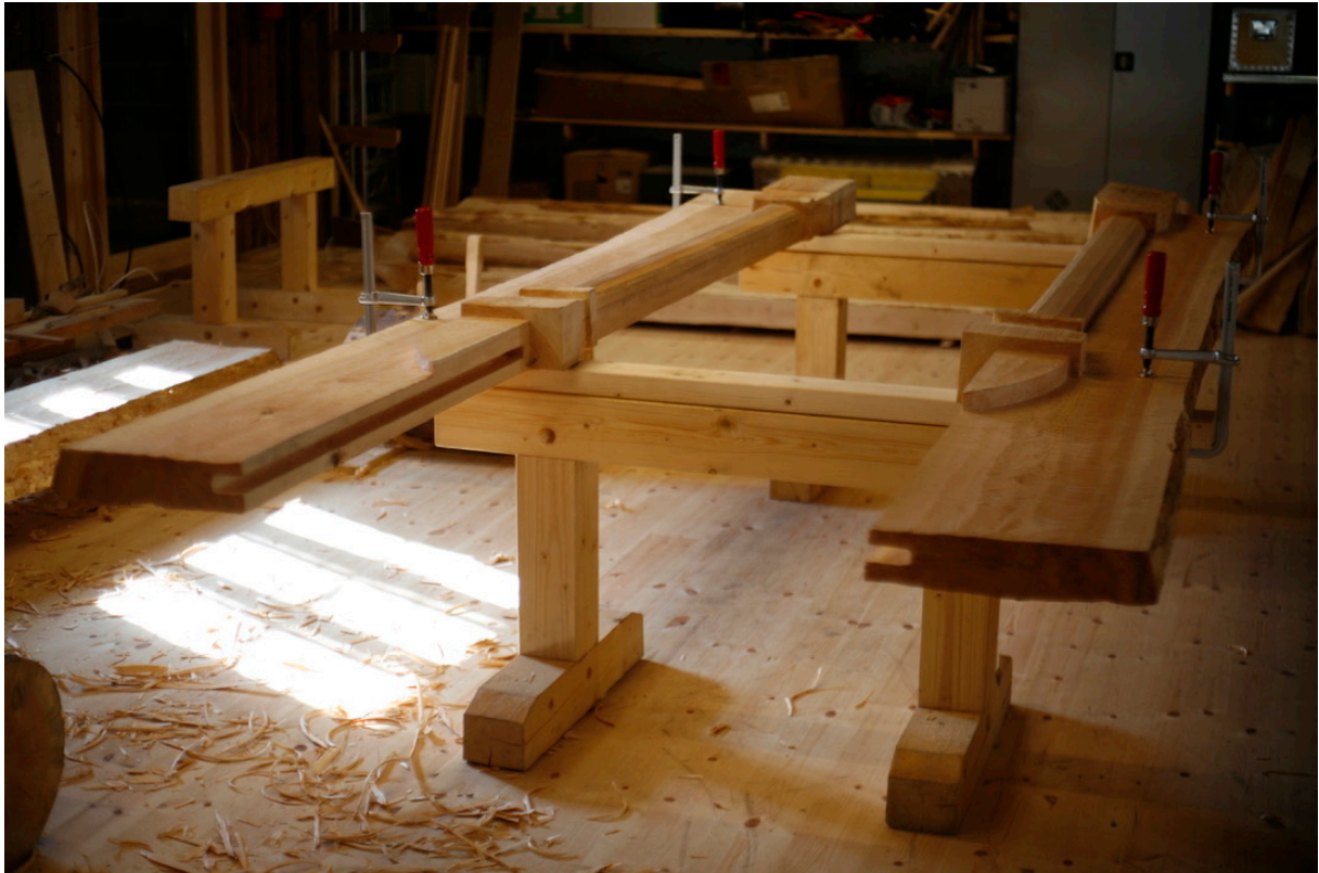
Bilde 68: Vangetilene lagt med riktig avstand før meddraging. Fotograf: forfatter
