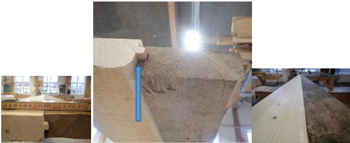
Tv: Arbeidsforsøket prøvd sammen med originalplanken. Midten: I og med at kanten på notsiden høvles under 90 grader fra rettsiden, er det god klaring på undersiden av fjøra. Dette sikrer at gulvet blir tett på oversiden.. Th: Tett i mellom bordene på oversiden, Foto: Henning Jensen
