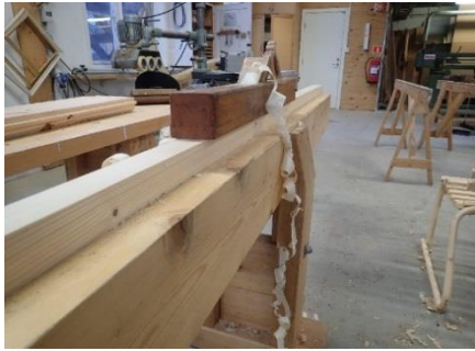
Øverst: Høvling av rettside med skrubbokse, sagskur og eventuell kuring ble høvlet vekk. Th: Høvling av kant, under 90 grader med skrubbokse. Nederst: Retting av kant med langhøvel. Foto: Henning Jensen
