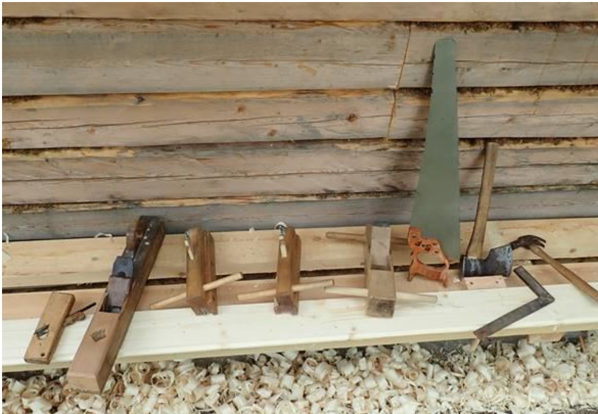
Verktøyet vi har brukt til høvlingen på tømmermansbenken. Fra v. semshøvel, langhøvel, nothøvel, fjørhøvel, okshøvel, sag, snekkerbile, vinkel, og hammer. Foto. Magnus Wammen
