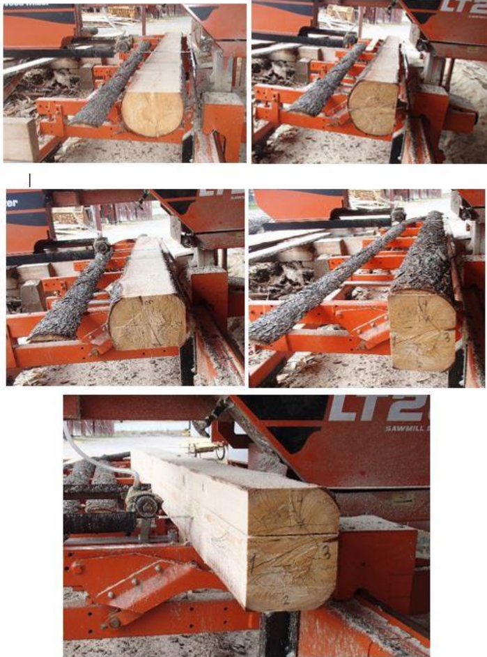
Sagingsprosess for 5 1/2" brede plank, her vist for skjæring av karmmaterialer, men prinsippet for gulvplanken er det samme, men at vi tok utgangspunkt i et sagsnitt imargen, og det ville bli en eller to takbord ut mot yta. Foto. Magnus Wammen
