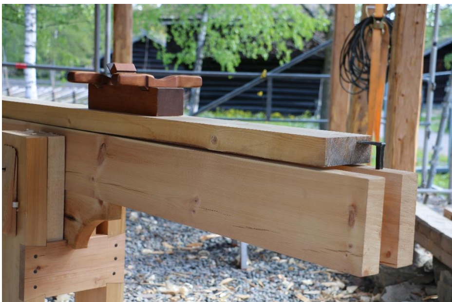
Høvling av rettsiden oppå langbordene på føybenken. Friksjonen fra sagskuren på undersiden, gjør at det også gikk greit å høvle vekk kuring diagonal uten side stopp. Foto: Henning Jensen
