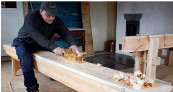
Roald Renmælmo høvler flask på langbenken. (Renmælmo, 2013, s 136) Foto: Roald Renmælmo
