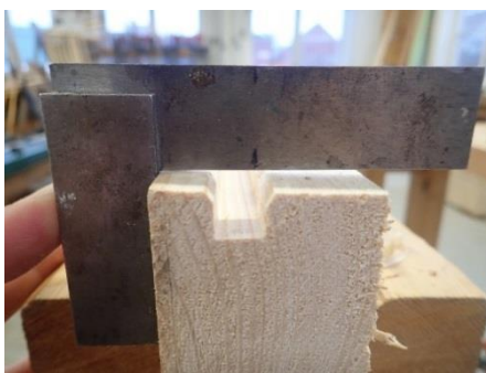
Øverst: Notsporet høvles. Dersom to stykker skal gjøre denne operasjonen, kan man så inn en pinne i hullet på høvelens fremkant. Th: Kanten på notsporet fases med semshøvel. Nederst: Ferdig notspor med fasede kanter og under 90 grader fra rettsiden.
