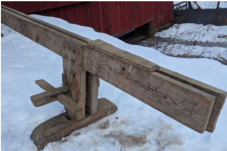
Et bord er spikret på mot enden. Sannsynligvis fungert som høvelstopp ved høvling av flask oppå benken. Skottbenk på Krogstad i Bardu. (Roald Renmælmo,2017) Foto: Pål Sneve Prestbakk.
