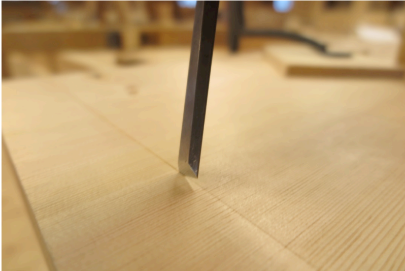
Figur 69. Forsterking av riss frå nothøvel med tappjarn. Foto:HTF
