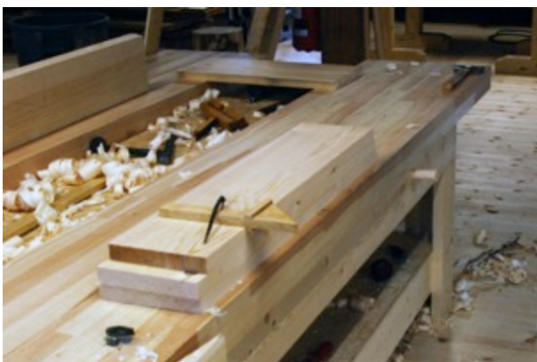
Figur 49 Vinkel,rissenål og tverramtre. Foto: PWB
