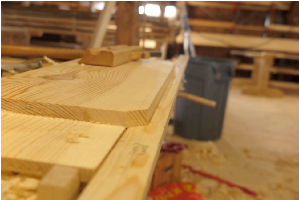
Figur 56. Ramtre før profilering. Foto:HTF
