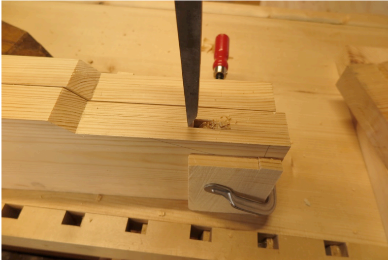
Figur 50. Hogging av tapphol. Foto:HTF
