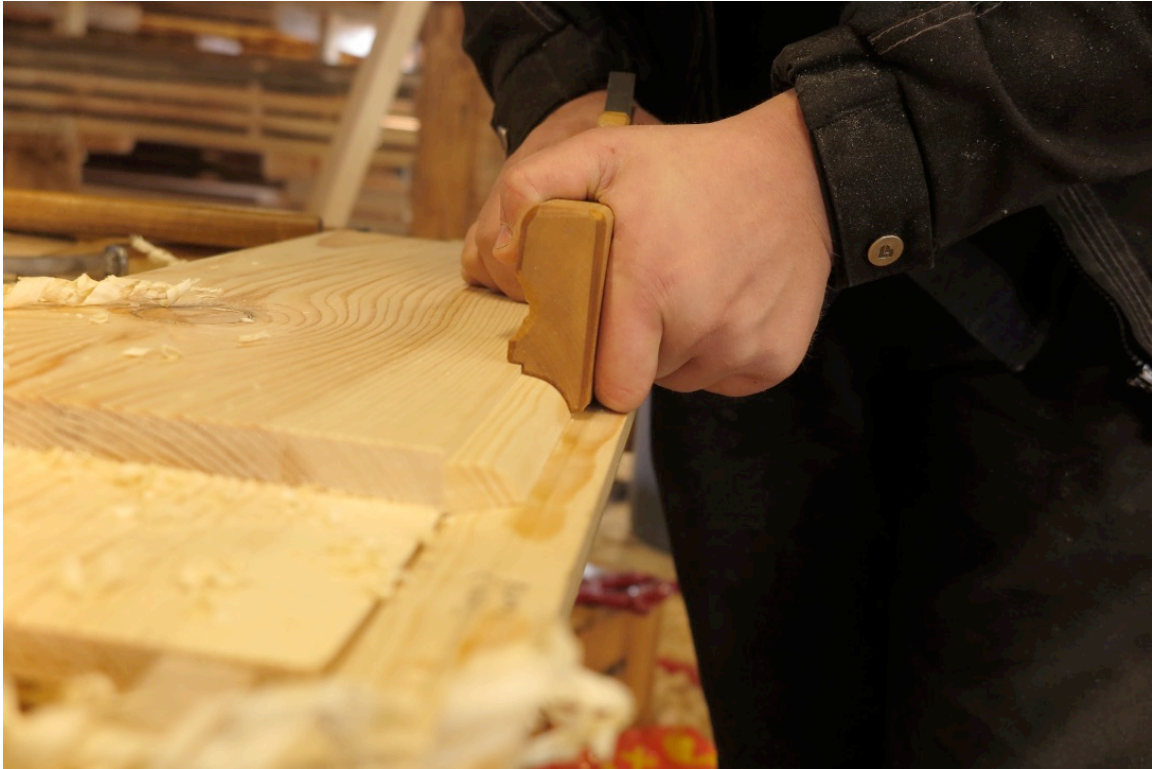
Figur 59. Profilhøvling av remtre. Foto:HTF
