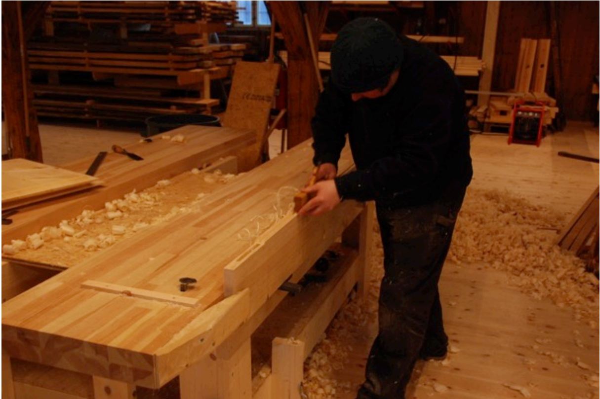
Figur 97 Staffhøvling på ramtre. Foto: PWB
