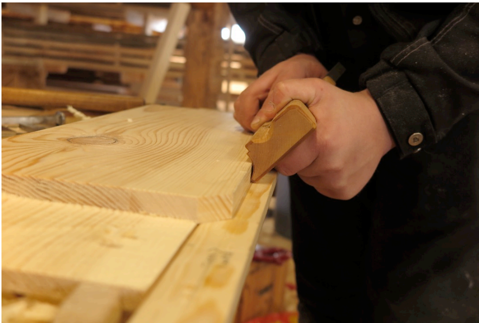
Figur 57. Profilhøvling av remtre. Foto:HTF
