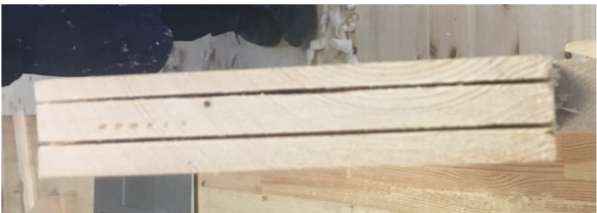
Figur 53 Sagsnitt endeved. Foto: PWB
