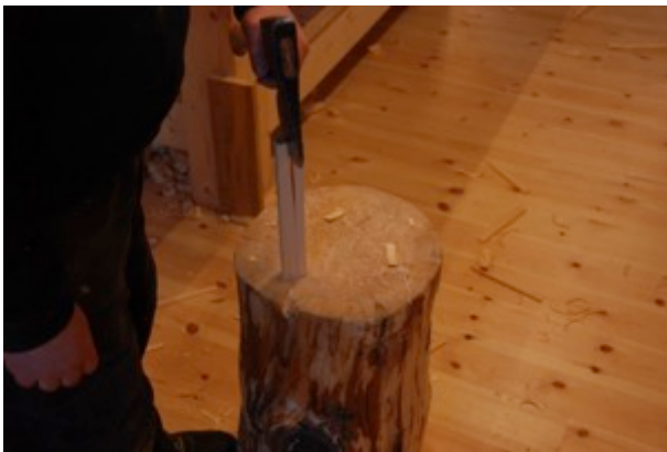
Figur 100 Klying av naglar. Foto: PWB
