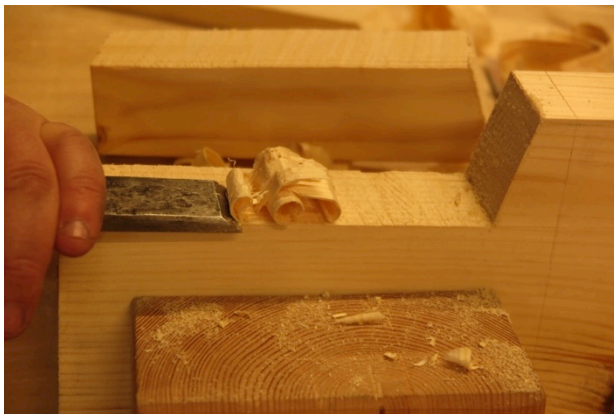
Figur 40. Stikking av tappbreidde. Foto:HTF
