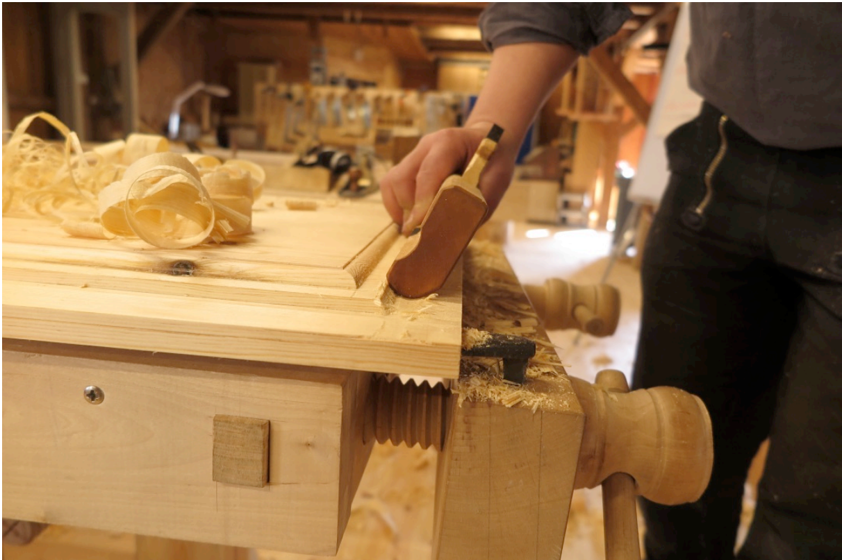
Figur 81. Høvling av holkil. Foto:HTF
