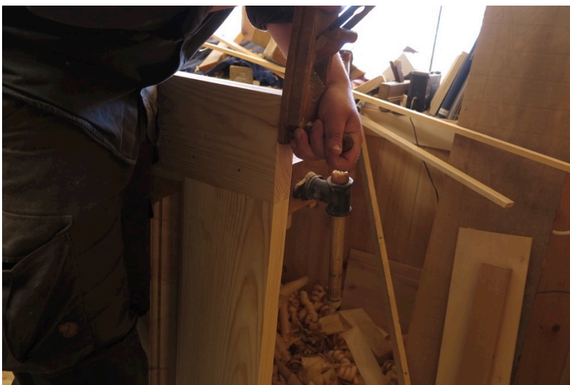
Figur 99. Støthøvling av endeveden. Foto:HTF
