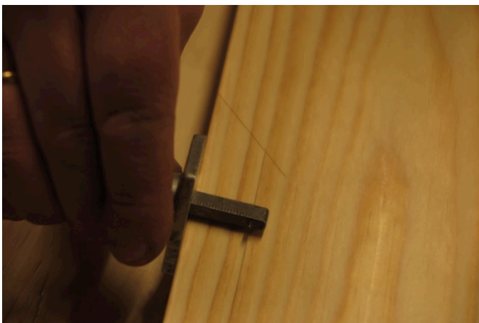
Figur 37. Oppmerking, Brystning, langramtre. Foto:HTF
