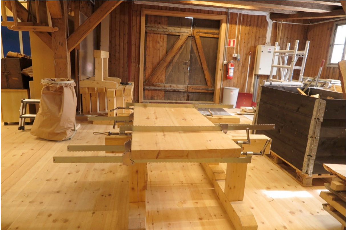
Figur 23. Liming av fylling Foto:HTF
