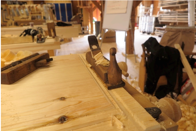
Figur 83. Grovhøvling av fris med skrubbhøvel. Foto:HTF
