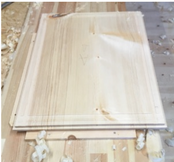
Figur 90 Fals på fylling. Foto: PWB
