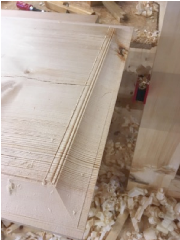
Figur 96 Staff,fals,hulkil og fjør. Foto: PWB
