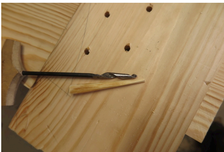
Figur 93. Nagle dimensjonert i naglelo og navar. Foto:HTF
