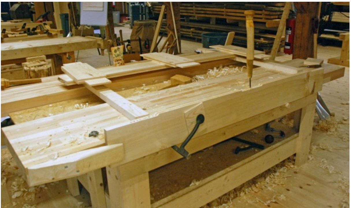
Figur 62 Forboring av tapphol. Foto: PWB
