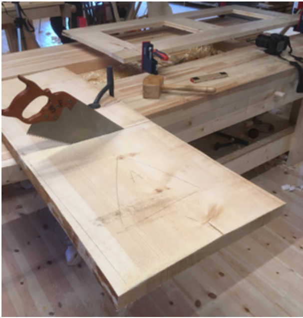
Figur 71 Kapping av fylling. Foto: PWB
