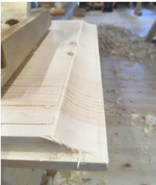
Figur 93 Fals,hulkil og fjør. Foto: PWB
