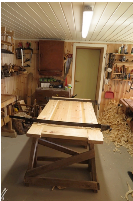
Figur 89. Tvinging før nagling. Foto:HTF
