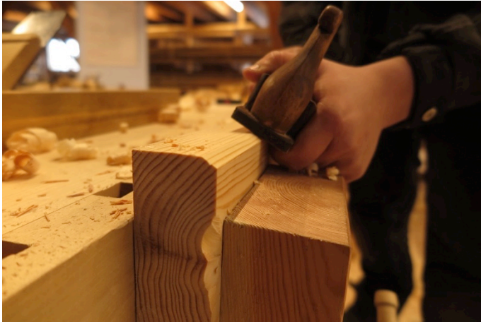
Figur 32. Dimensjonering av ramtre, skrubbhøvel. Foto:HTF
