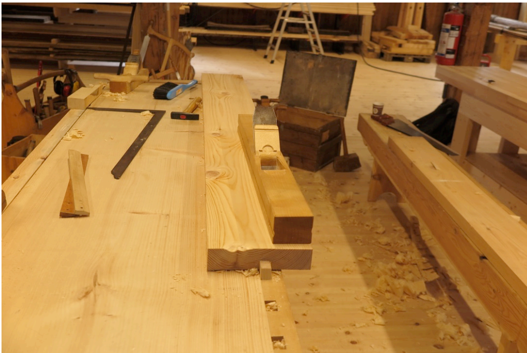
Figur 27. Retting av ramtre, langhøvel. Foto:HTF
