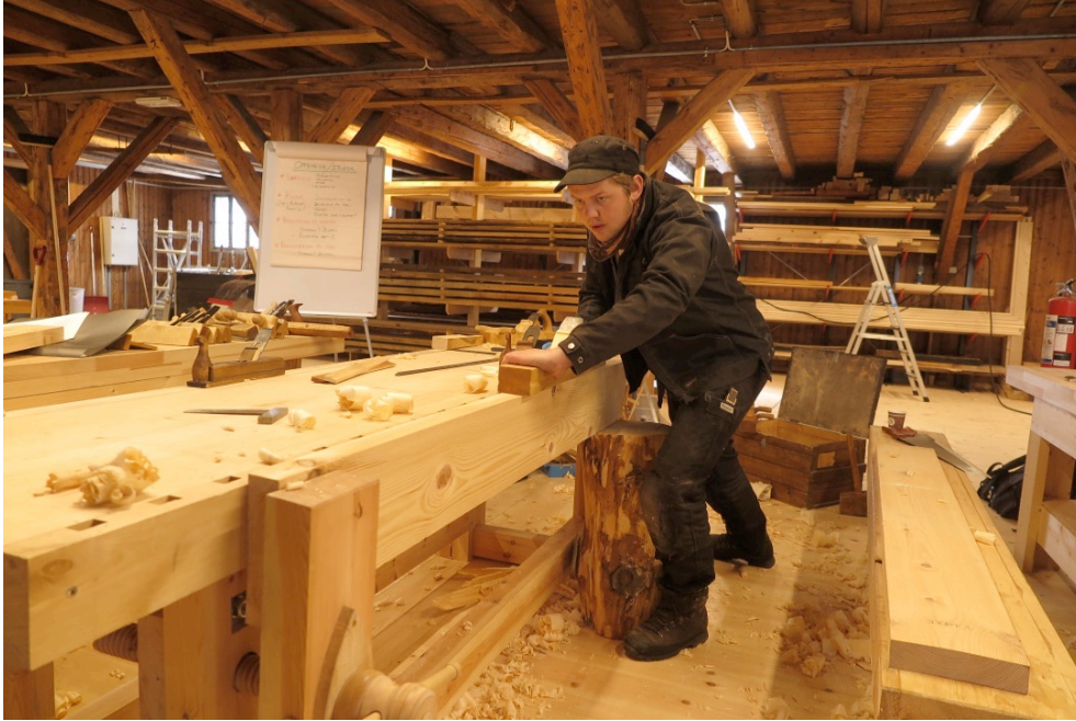
Figur 28. Retting av ramtre, langhøvel. Foto:HTF
