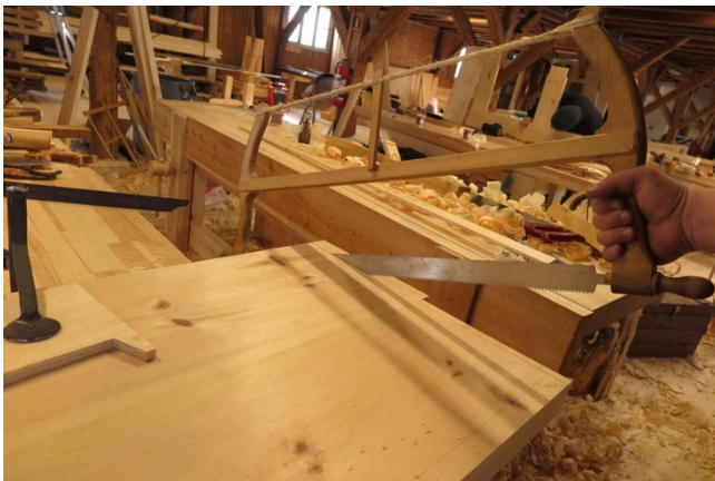
Figur 64. Kapping av fylling. Foto:HTF
