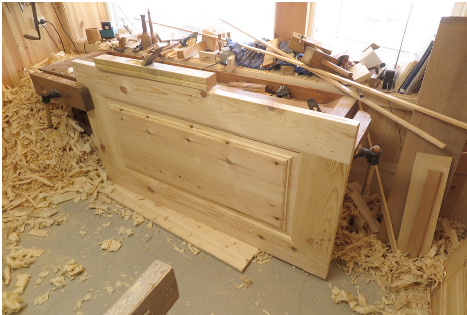
Figur 98. Pusshøvling/retting av kant og tappar. Foto:HTF
