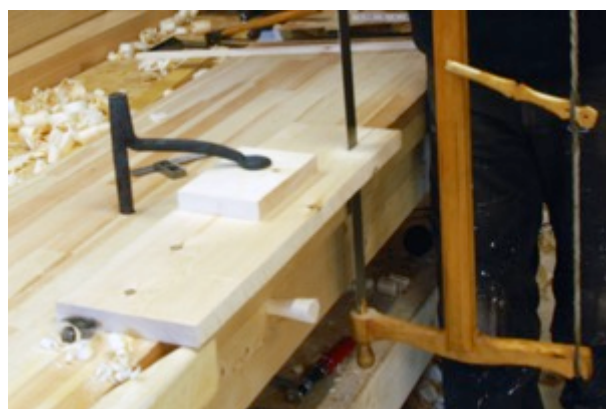
Figur 51 Ende brystning. Foto: PWB
