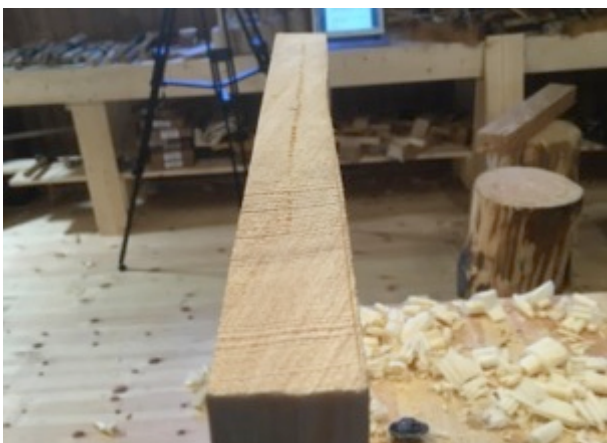
Figur 76 Merking med ripmott. Foto: PWB
