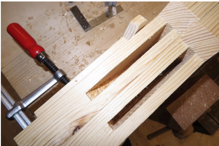
Figur 51. Hogging av tapphol. Foto:HTF
