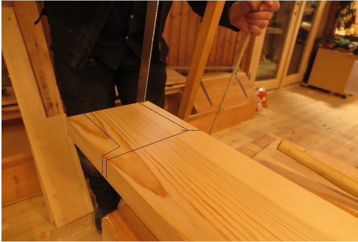
Figur 39. Grovskjering av tappbreidde. Foto:HTF
