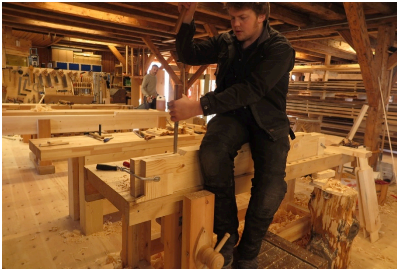
Figur 52. Sittestilling, hogging av tapphol. Foto:HTF
