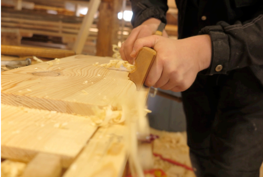
Figur 58. Profilhøvling av remtre. Foto:HTF
