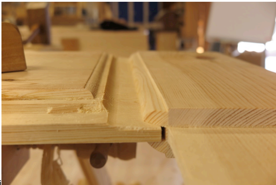
Figur 86. Prøving av ramtre mot fjøra på frisen. Foto:HTF
