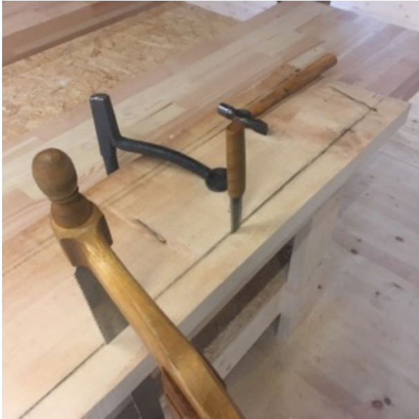
Figur 43 Kniv i sagsnitt. Foto: PWB
