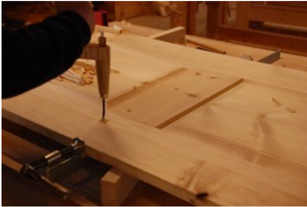
Figur 103 Boring av hol til nagle. Foto: PWB
