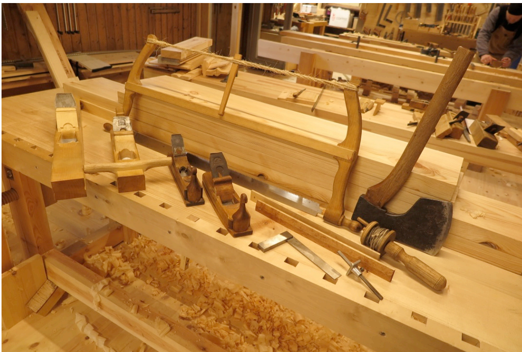
Figur 33. Verktøy nytta til retting og dimensjonering. Foto:HTF
