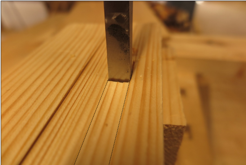
Figur 49. Hogging av tapphol. Foto:HTF
