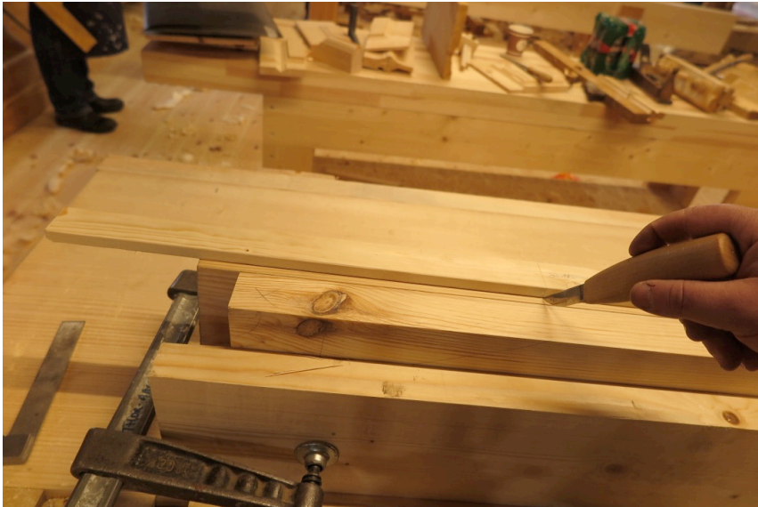
Figur 35. Oppmerking, ramtre. Foto:HTF
