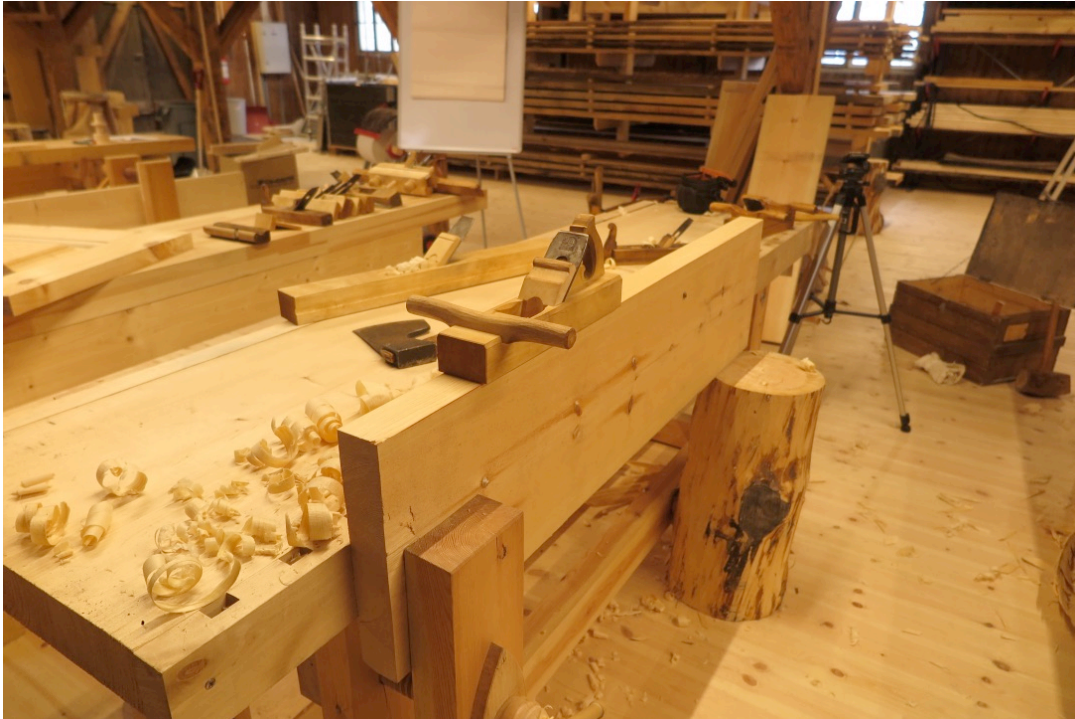
Figur 20. Retting av fyllingsemne, okshøvel. Foto:HTF
