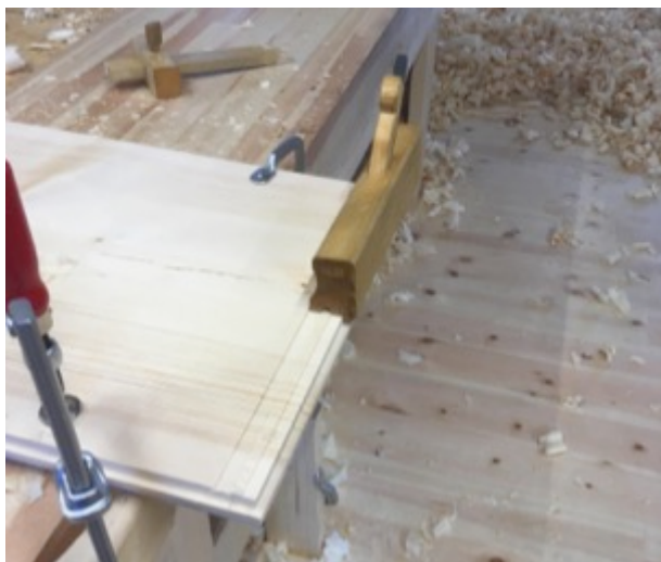
Figur 87 Falshøvling. Foto: PWB
