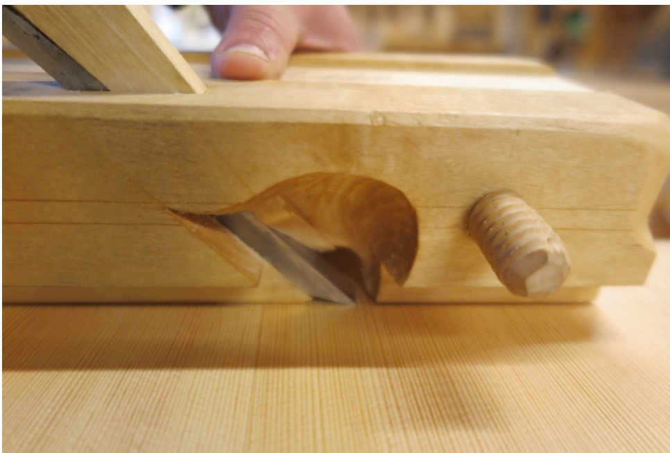
Figur 68. Rissing med nothøvel. Foto:HTF
