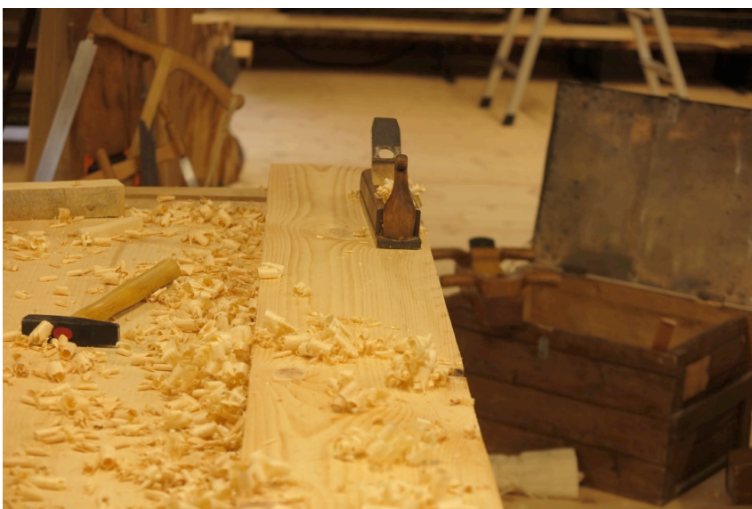
Figur 25. Retting av ramtre, skrubbhøvel. Foto:HTF
