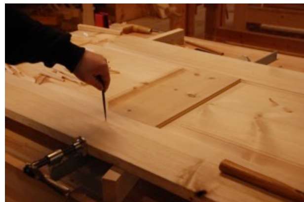
Figur 102 Plasing av naglar og navarbit. Foto: PWB
