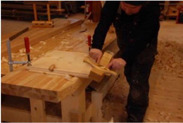
Figur 91 Fas fra fals til fjør. Foto: PWB
