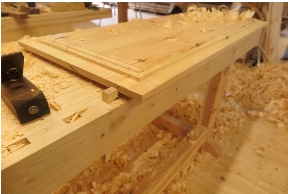
Figur 80. Styringskant for holkil. Foto:HTF
