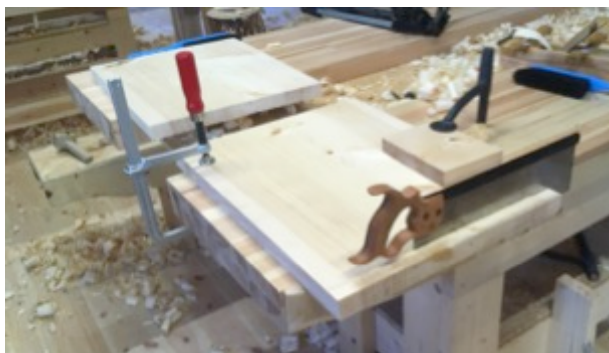
Figur 83 Endekapping med bakksag. Foto: PWB
