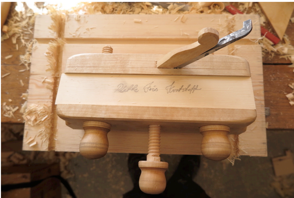
Figur 67. Stillbar nothøvel med fast avstandskloss for føringsspor. Foto:HTF
