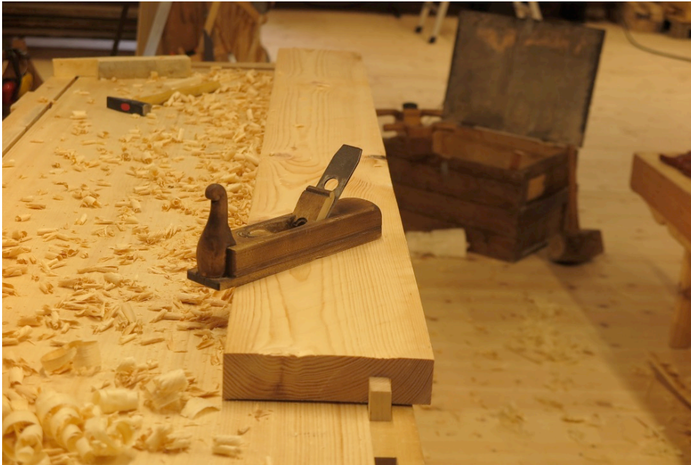
Figur 24. Retting av ramtre, skrubbhøvel. Foto:HTF
