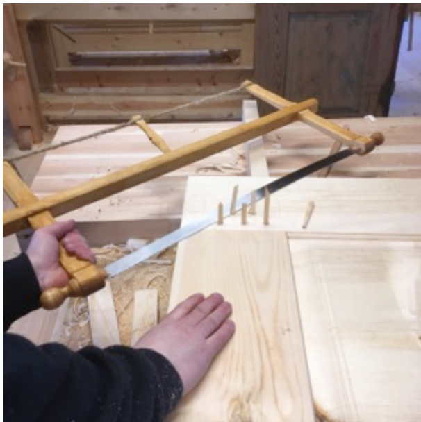
Figur 107. Kapping av naglar. Foto: PWB
