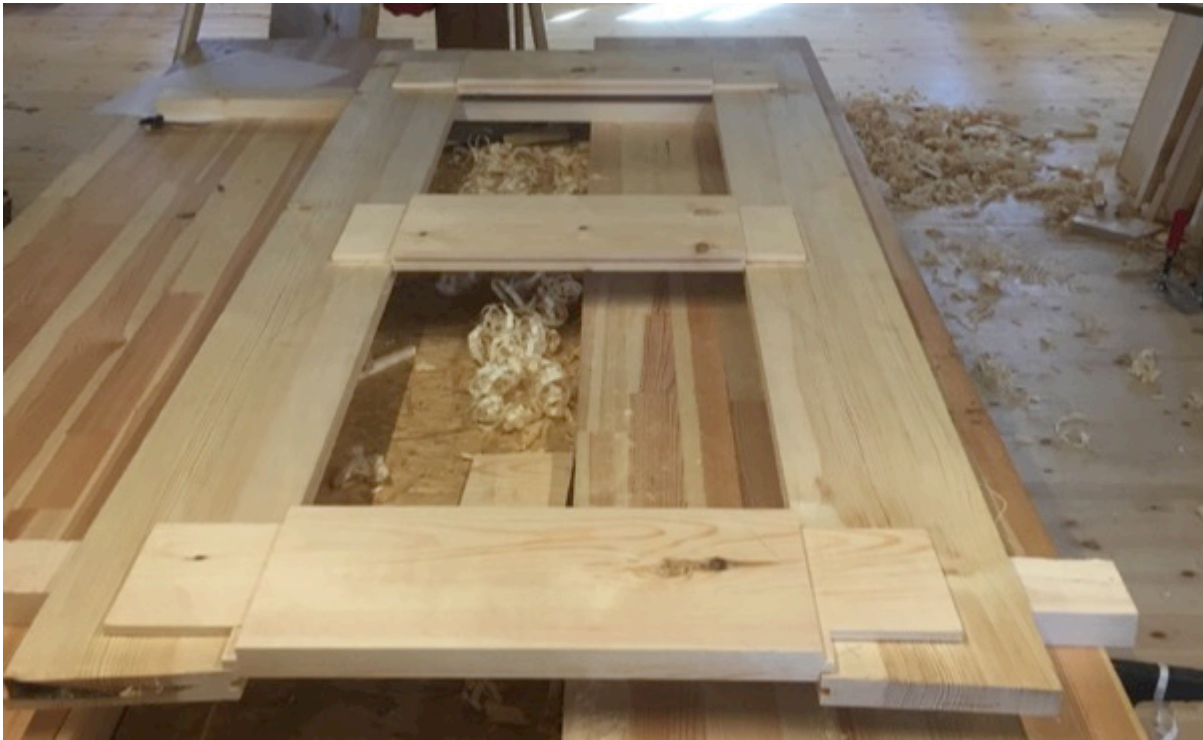
Figur 58. Plasering av ramtre. Foto: PWB
