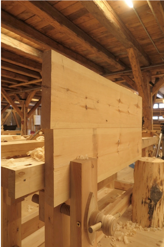
Figur 22. Justering av fyllingsemne før liming. Foto:HTF
