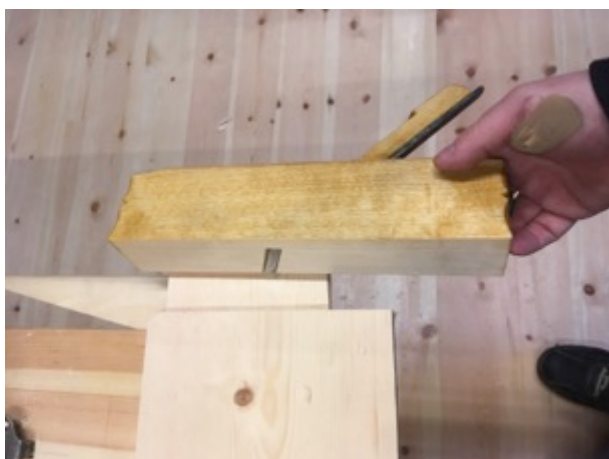
Figur 68 Tilpassing av tappskulder med høvel. Foto: PWB
