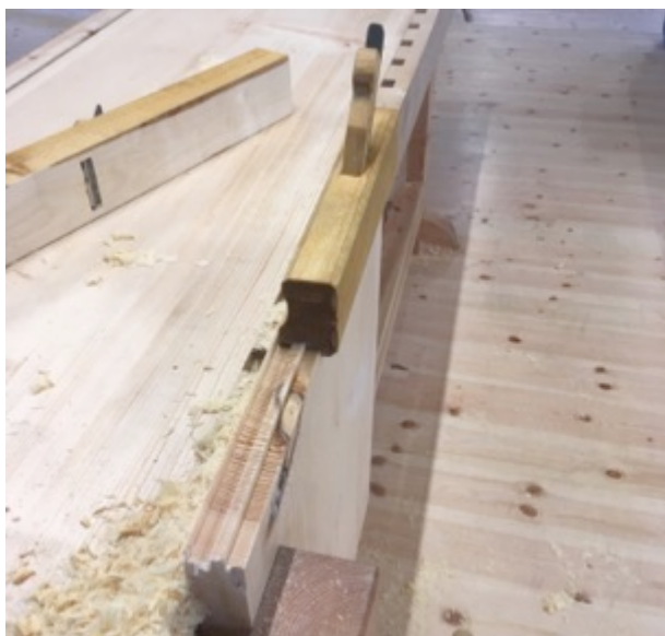
Figur 85 endevedshøvling Foto: PWB
