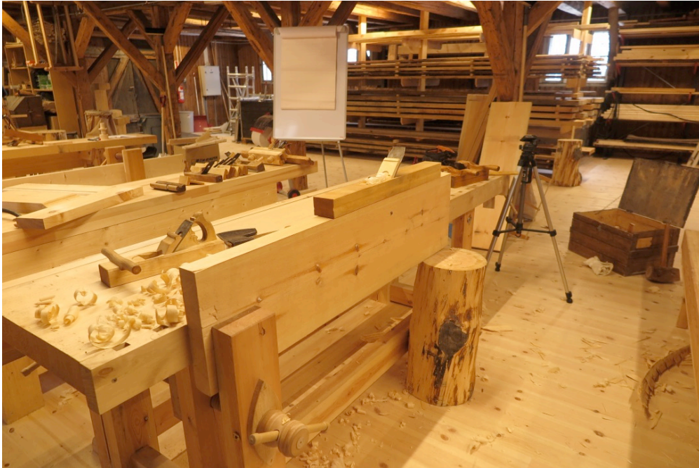
Figur 21. Retting av fyllingsemne, langhøvel. Foto:HTF
