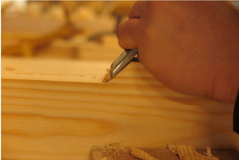
Figur 41. Stikking av gjæring etter riss. Foto:HTF
