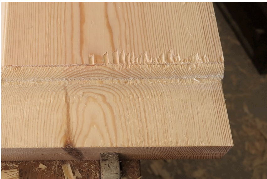
Figur 75. Utrifter ved høvling forbi forskjæret, kvantstaff fylling. Foto:HTF
