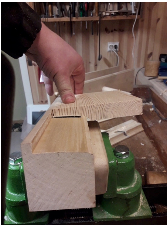
Figur 84. Justering av frishøvel for overgangen mellom holkil og fris. Foto:HTF
