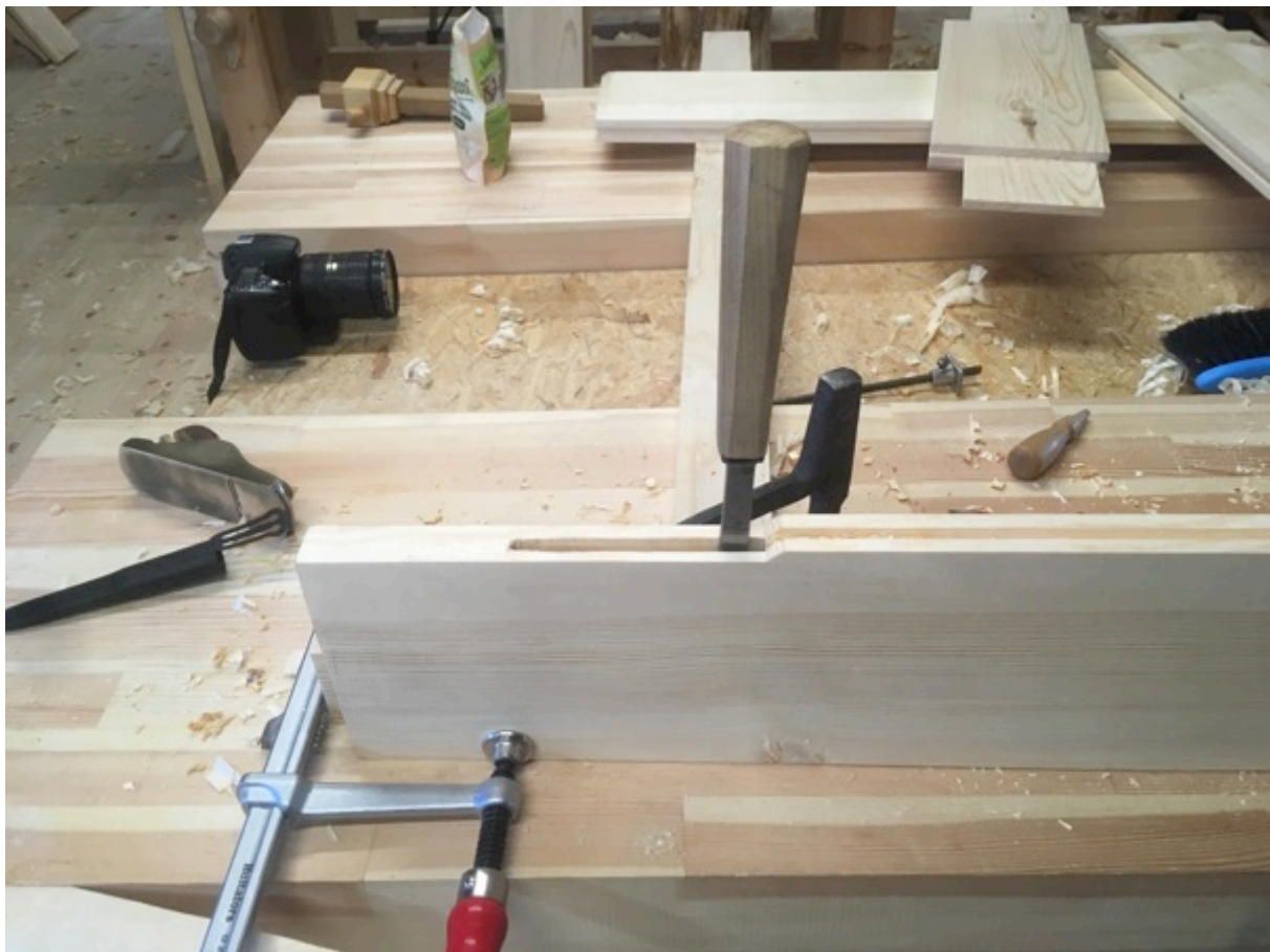
Figur 65 Lockbeitel i tapphol. Foto: PWB
