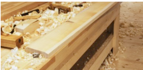
Figur 47 Fasa kant mot riss. Foto: PWB
