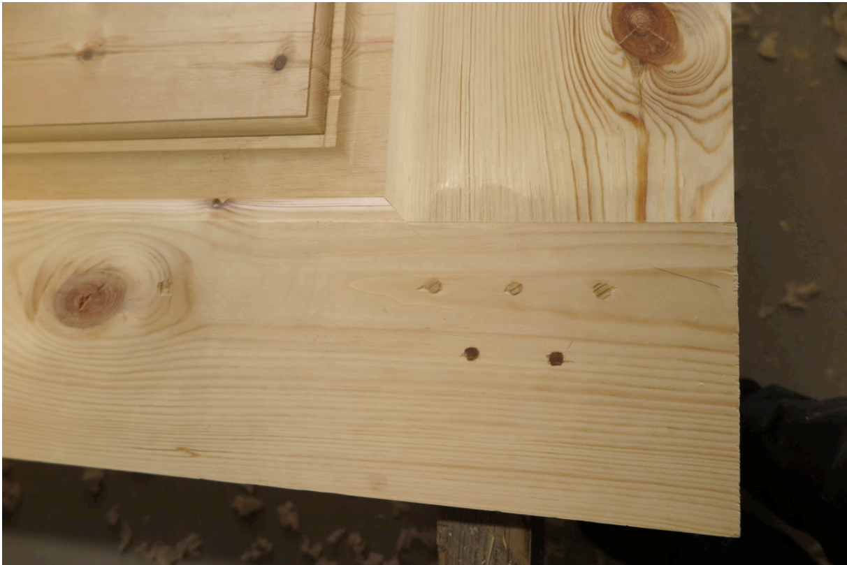
Figur 96. Ferdig kappd og pusshøvla naglar. Foto:HTF
