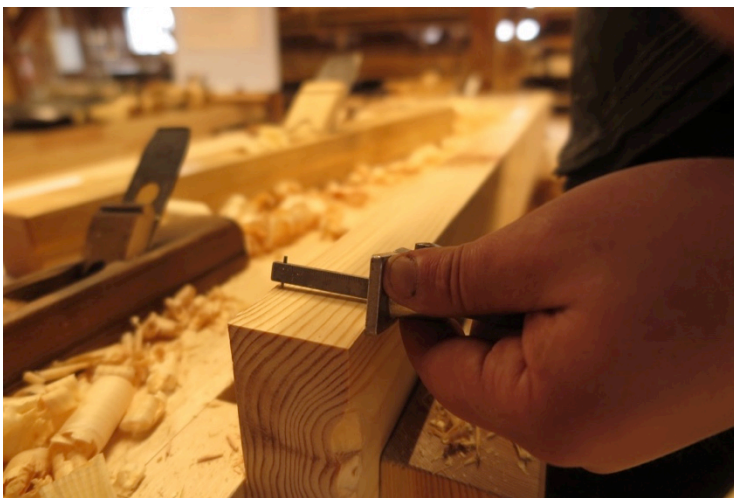
Figur 31. Oppmerking av dimensjon med ripmott. Foto:HTF
