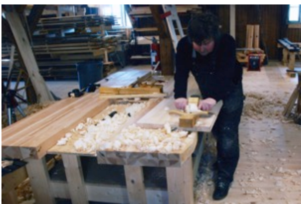
Figur 73.Okshøvling Foto: PWB
