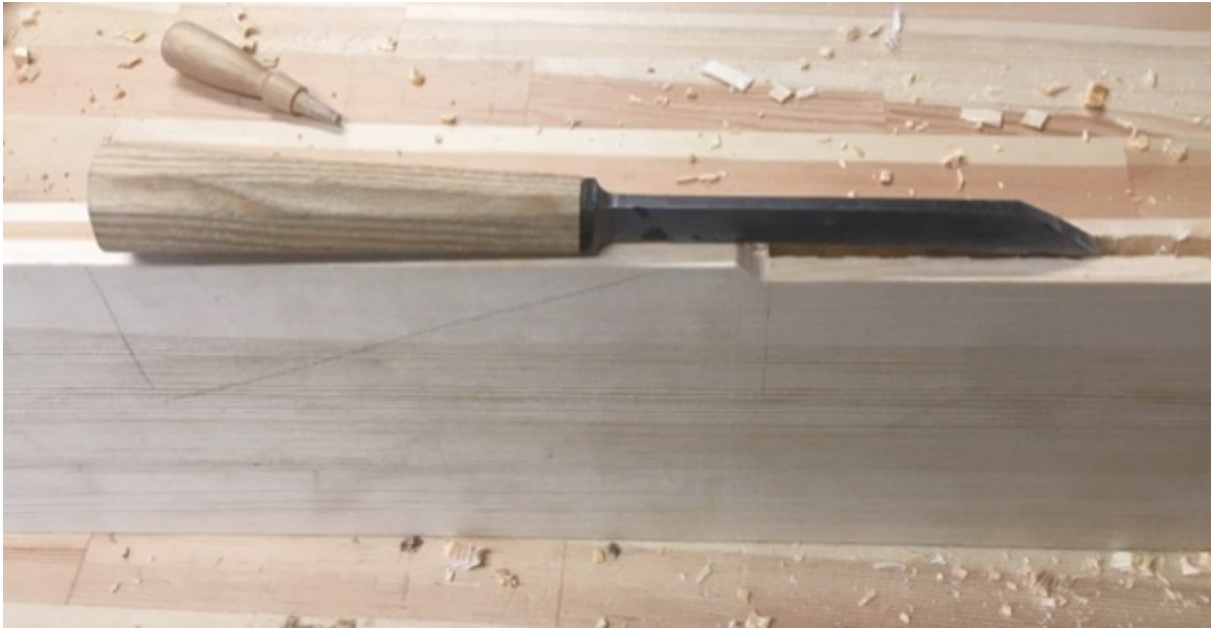
Figur 66 Lockbeitel smidd av Erling Ove Aas. Foto: PWB
