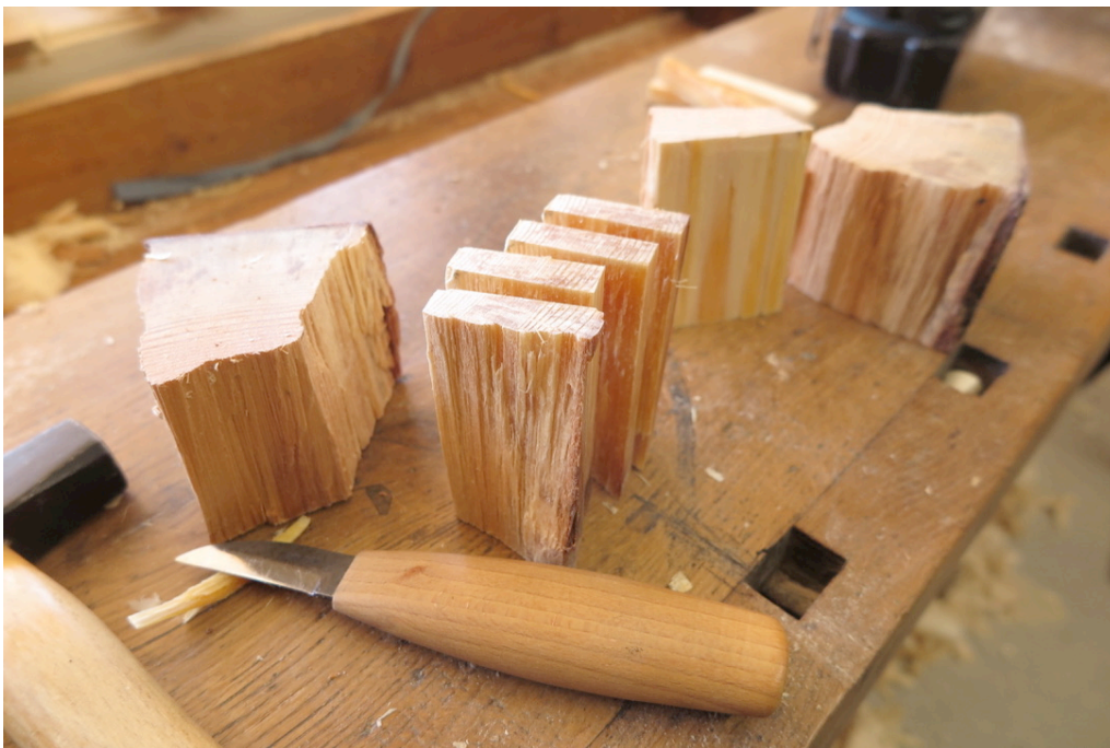
Figur 91. Kløyving av nagleemne. Foto:HTF
