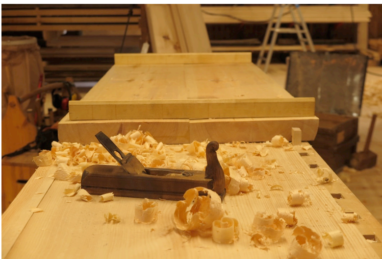
Figur 61. Retting av fylling. Siktestikker og skrubbhøvel. Foto:HTF
