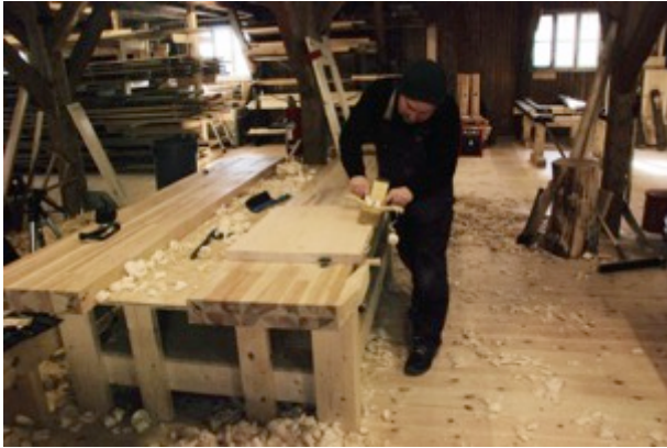
Figur 77 Fasing av kant. Foto: PWB
