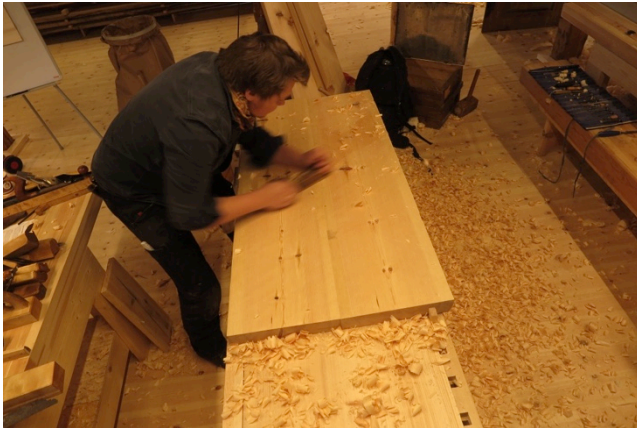
Figur 62. Grovretting av fylling med skrubbhøvel. Foto:HTF
