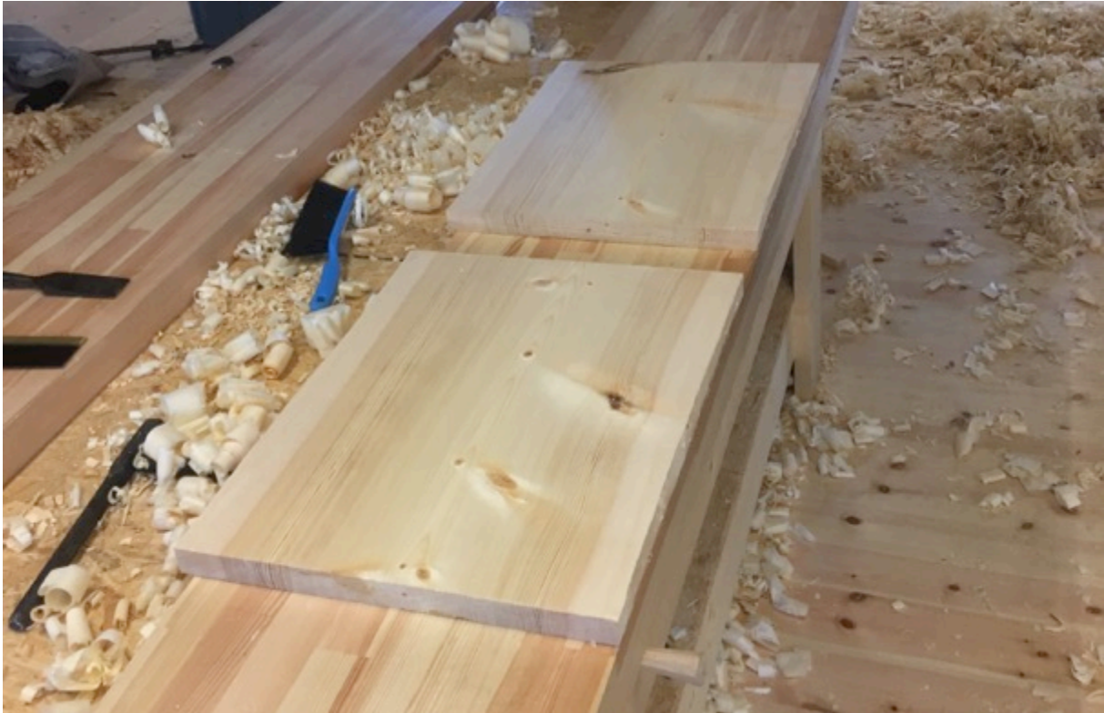
Figur 79 Retta og dimensjonerte fyllingar. Foto: PWB
