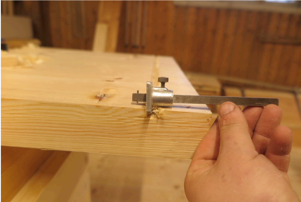
Figur 71. Rissing for forskjæring av kvartstaff i tverrved. Foto:HTF
