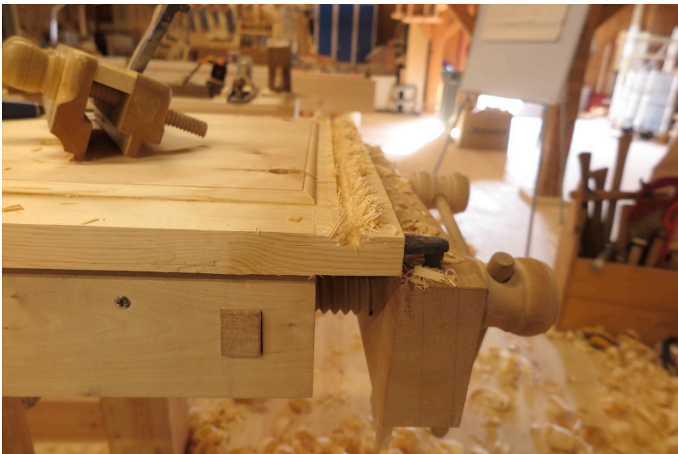
Figur 79. Føringsspor, holkil, fylling. Foto:HTF
