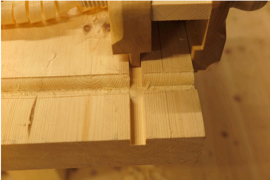
Figur 76. Høvling av platte, langved, fylling. Foto:HTF
