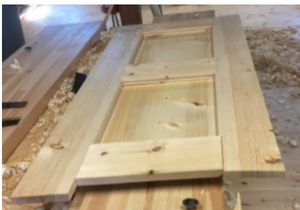
Figur 81 Avteikning av ramme på fylling. Foto: PWB
