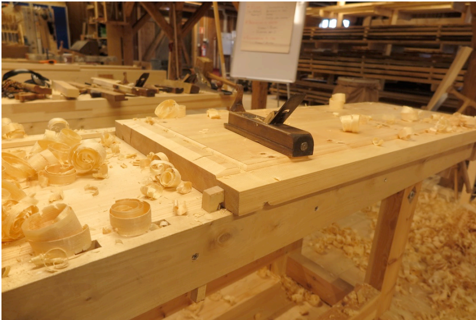
Figur 78. Fjerning av overflødig material med skrubbhøvel. Foto:HTF
