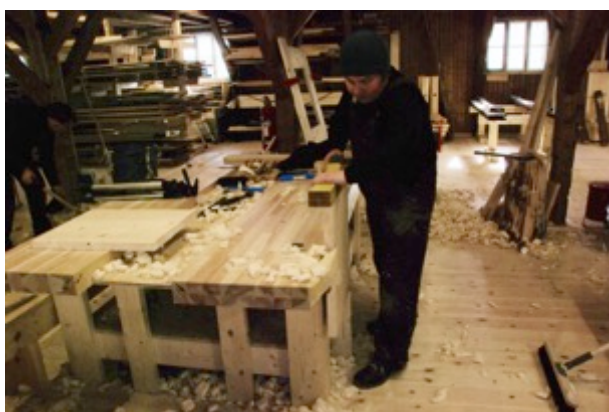
Figur 84 Kanthøvling. Foto: PWB
