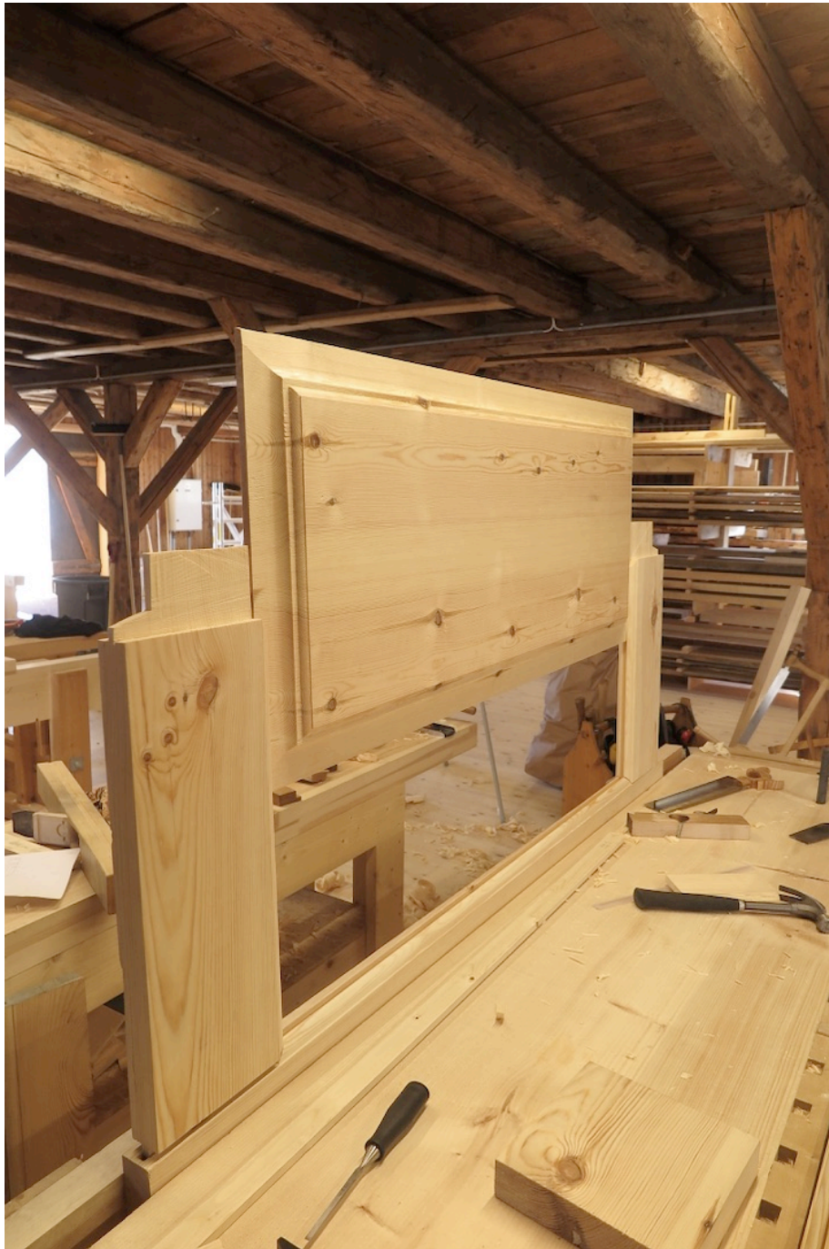
Figur 87. Samansetting av dør. Foto:HTF
