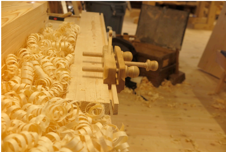
Figur 55. Framstilling av laus fjør. Foto:HTF
