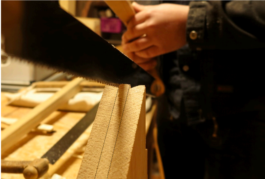
Figur 43. Startspor for saging av tapp. Foto:HTF
