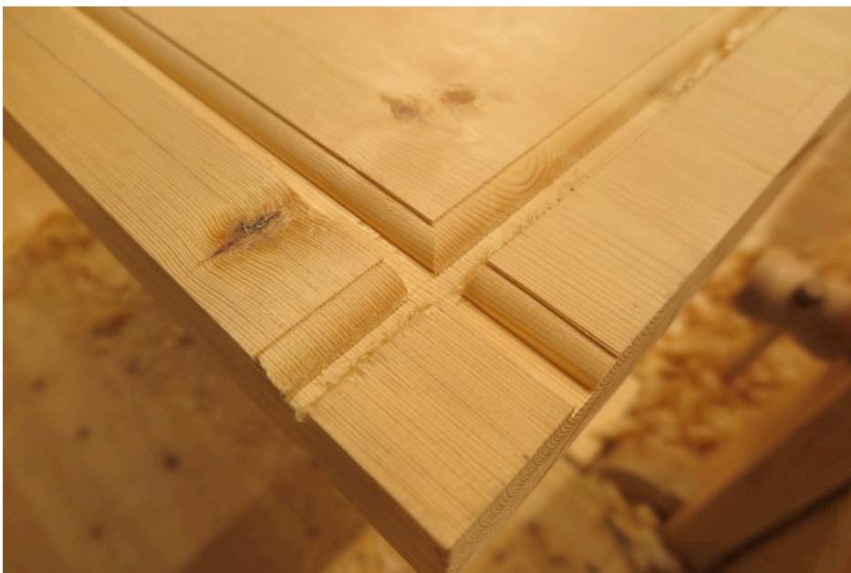
Figur 1.77. Kvantstaff og platte, fylling. Foto:HTF
