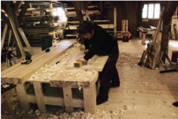
Figur 75 Pusshøvling med langhøvel. Foto: PWB
