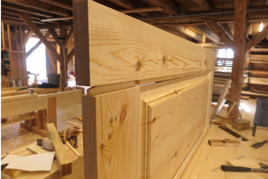
Figur 88. Montering av siste langramtre. Foto:HTF
