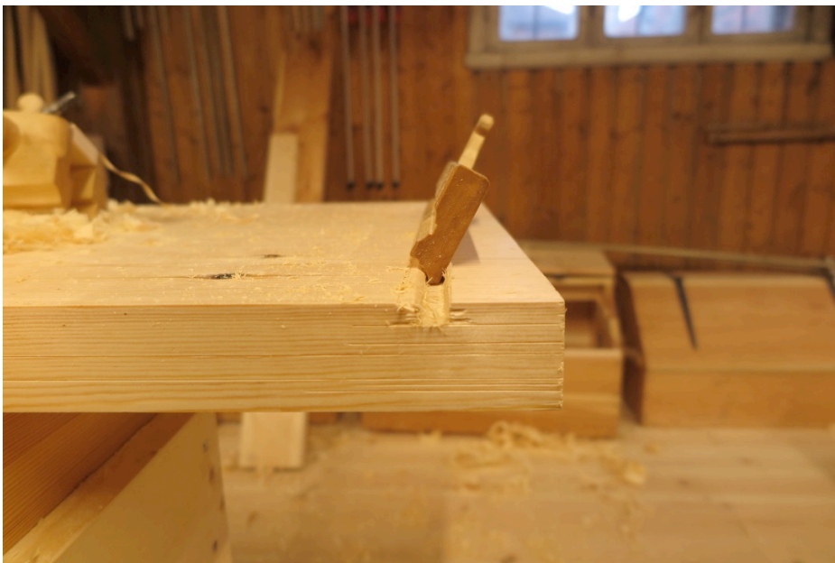
Figur 73. Høvling av kvartstaff på fylling. Foto:HTF
