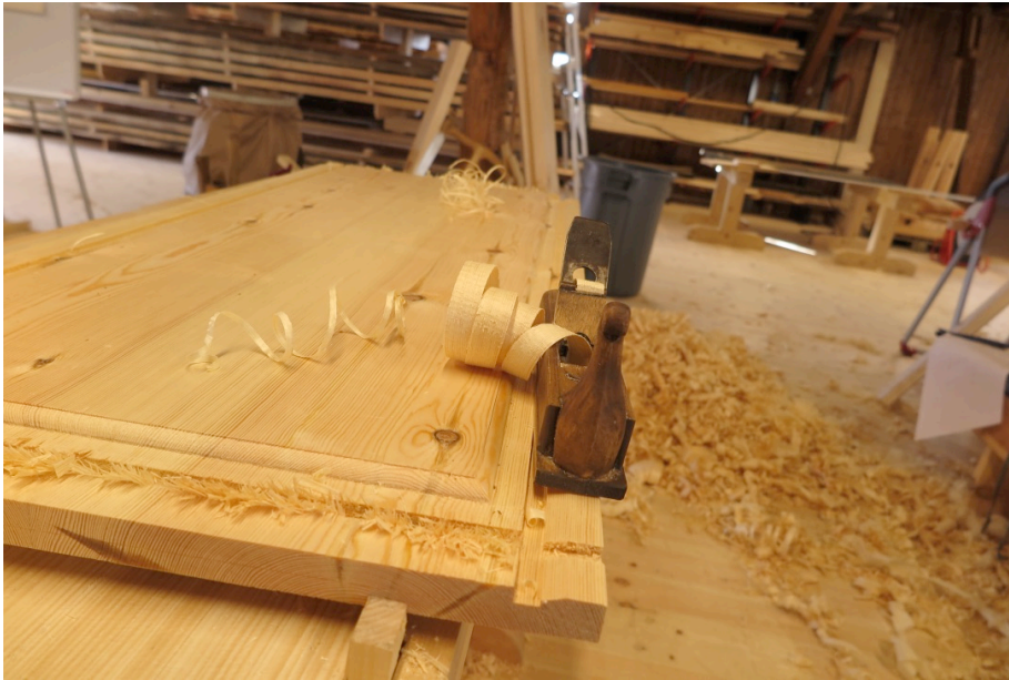
Figur 80. Fjerning av overflødig material med skrubbhøvel. Foto:HTF
