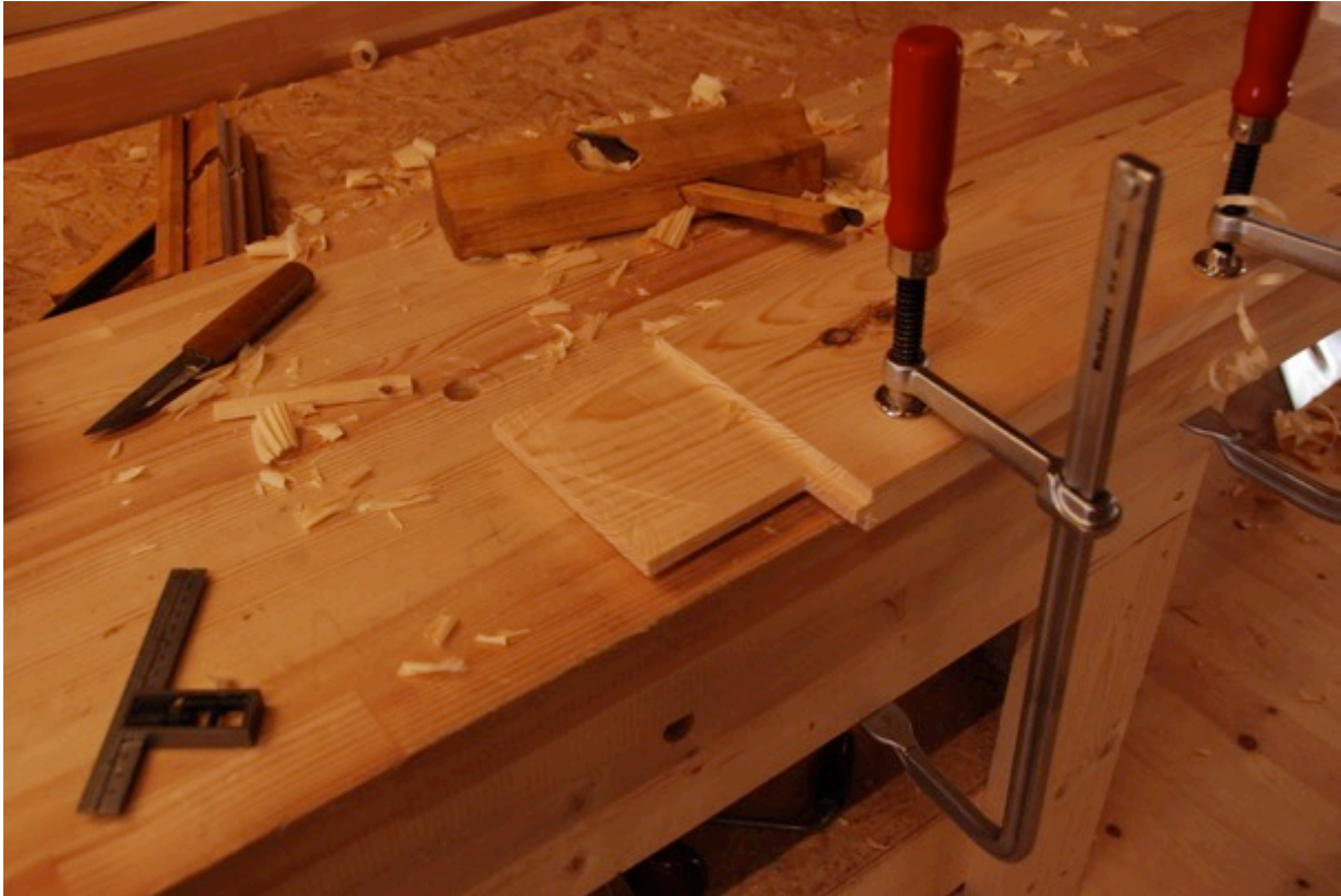
Figur 56 Høvling av tapp. Foto: PWB
