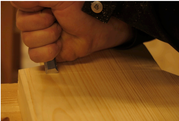
Figur 45. Forsterking av riss, tappskuldra. Foto:HTF
