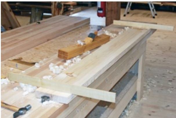
Figur 44 Orientering med siktepinningar. Foto: PWB
