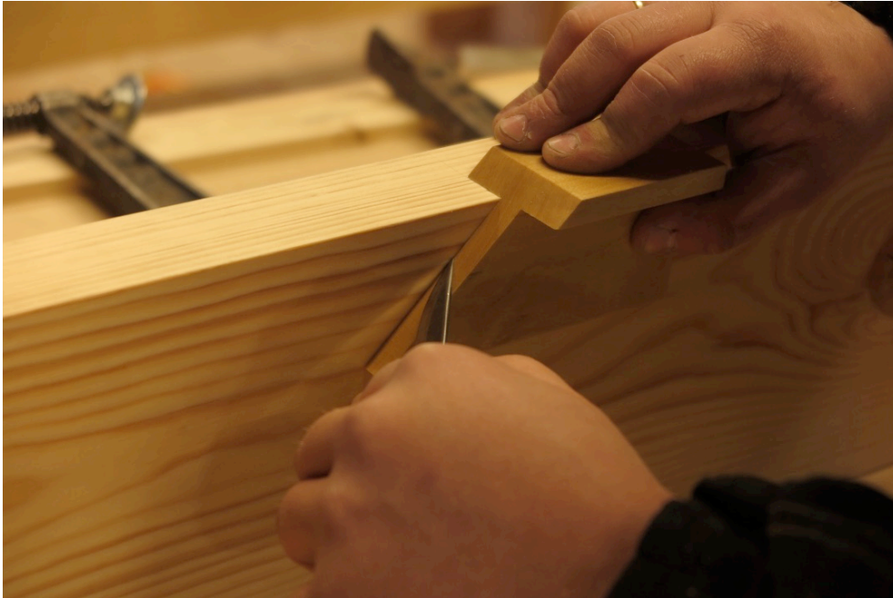
Figur 36. Oppmerking, gjæring, ramtre. Foto:HTF
