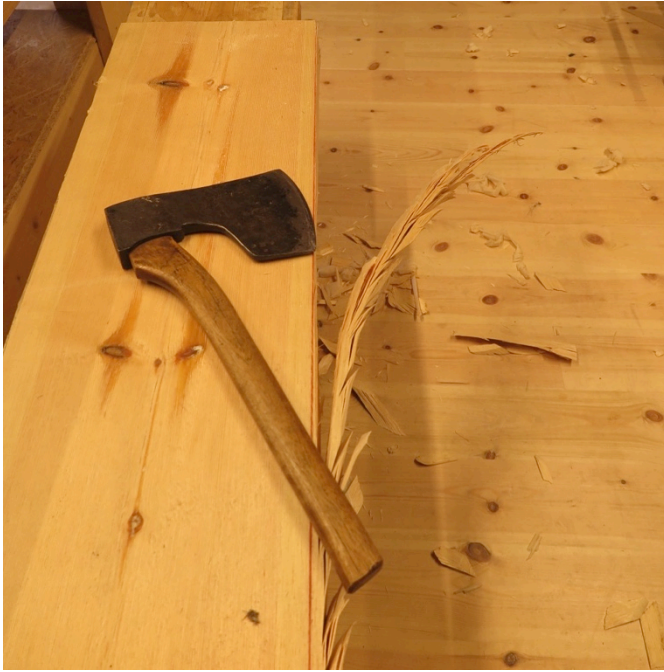
Figur 18. Grovretting av fyllingsemne med øks etter snorslag. Foto:HTF
