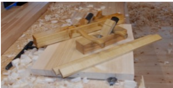
Figur 80 Langhøvel,okshøvel og siktepinnar. Foto: PWB
