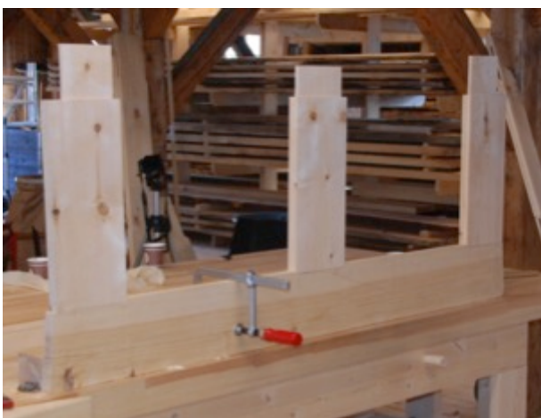
Figur 67 Prøving av tappar. Foto: PWB
