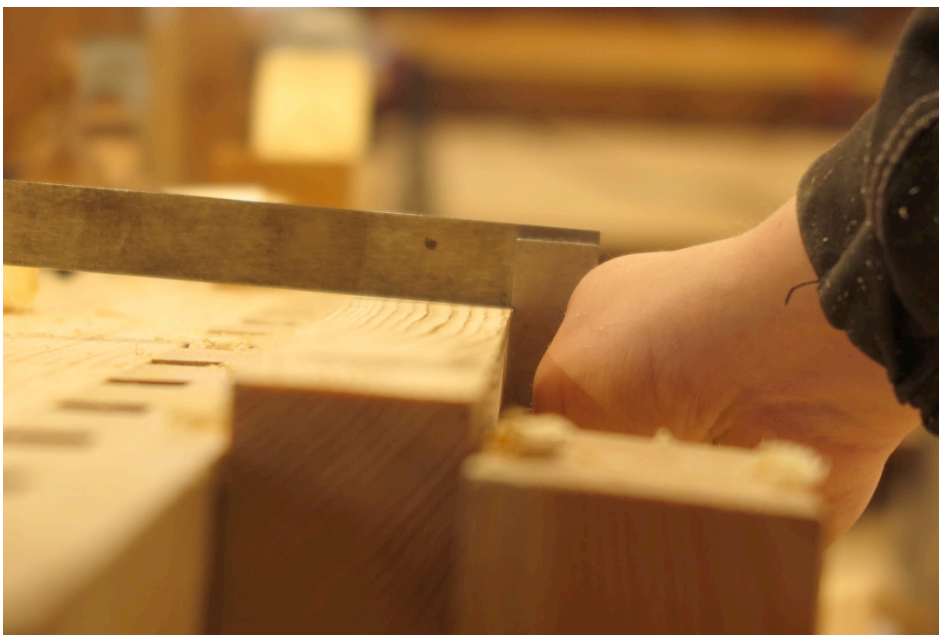
Figur 29. Vinkling av kant, ramtre. Foto:HTF
