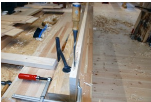
Figur 64 Stikking med tappjern. Foto: PWB
