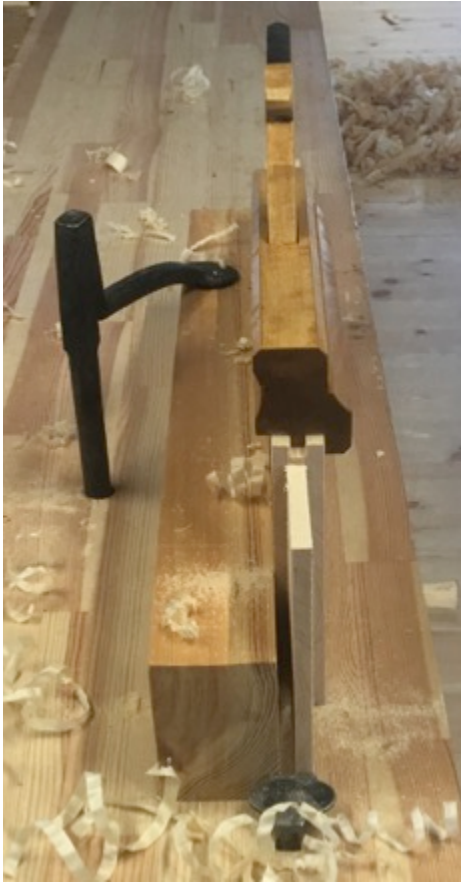
Figur 57 Høvling av notspor. Foto: PWB
