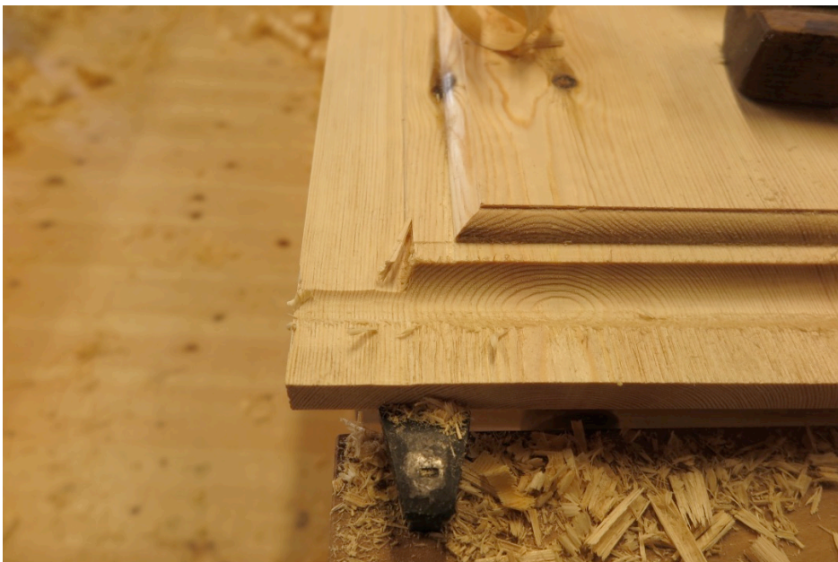
Figur 82. Ferdig holkil i tverrved. Foto:HTF
