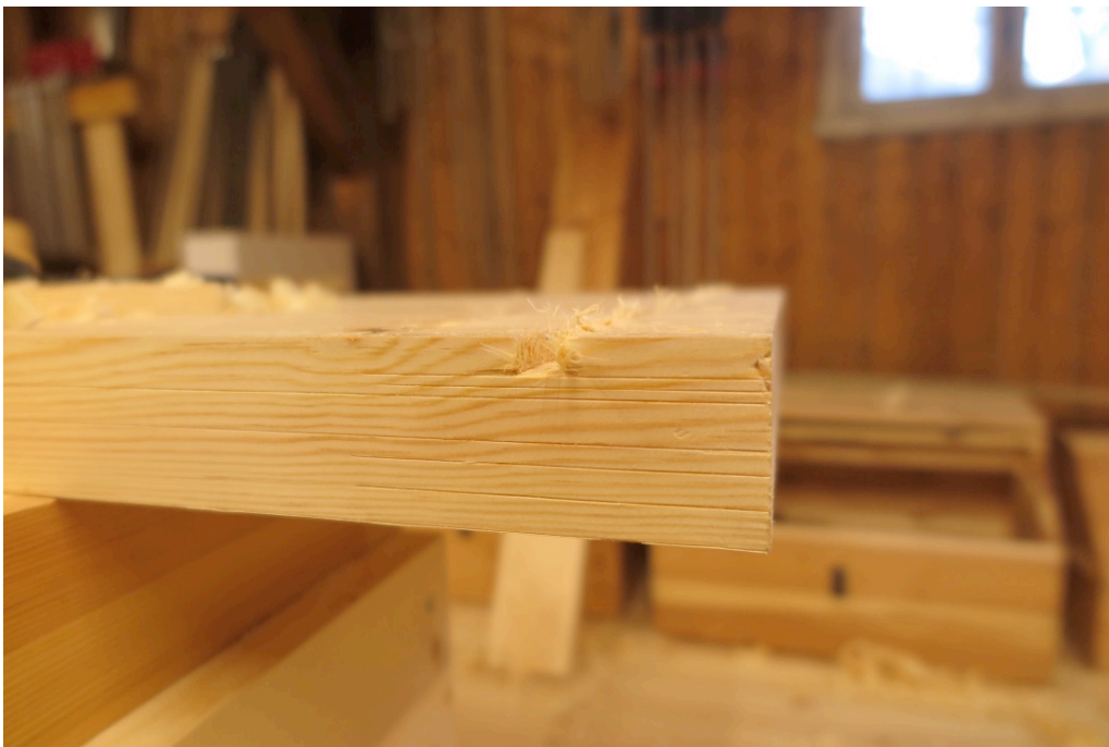
Figur 70. Høvling av platte. Foto:HTF
