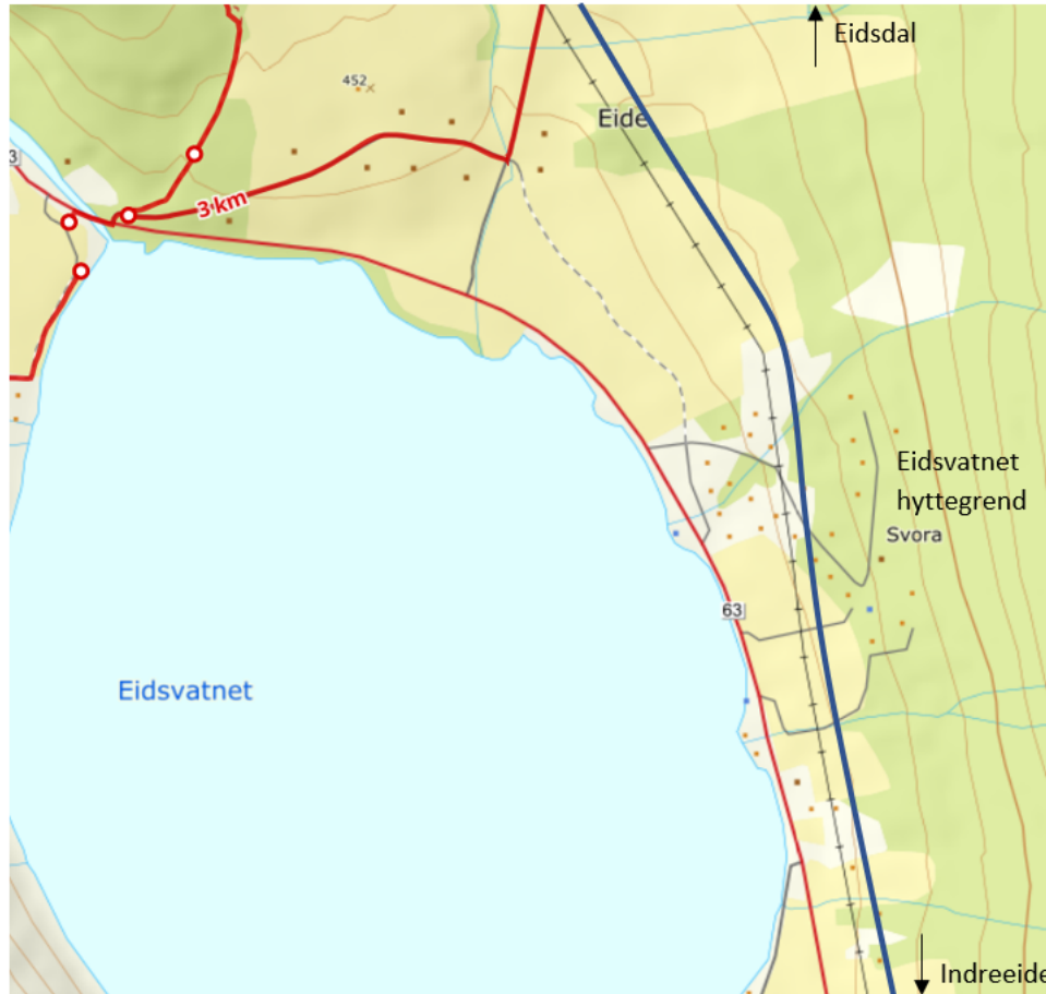
Figur 4.19: Kraftlinjetrasé gjennom hyttefelt ved Eidsvatnet. Den nye traseen er representert av den blå linjen
