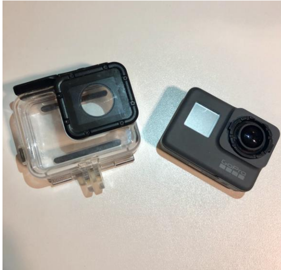
Figur 4 – GoPro HERO 5 kamera med vanntett deksel. Det måtte brukes et kamera med vanntett deksel for å kunne filme i merden. Dekselet har en festemekanisme på undersiden. Det er en lignende festemekanisme på stativet, man setter de inn i hverandre og låser det fast med en skru.
