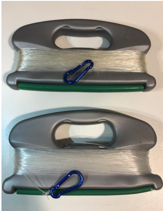
Figur 3 - De to dorgsenene som ble brukt til å drage konstruksjonen frem og tilbake i merden. Den ene sveiver inn mens den andre slipper ut.
