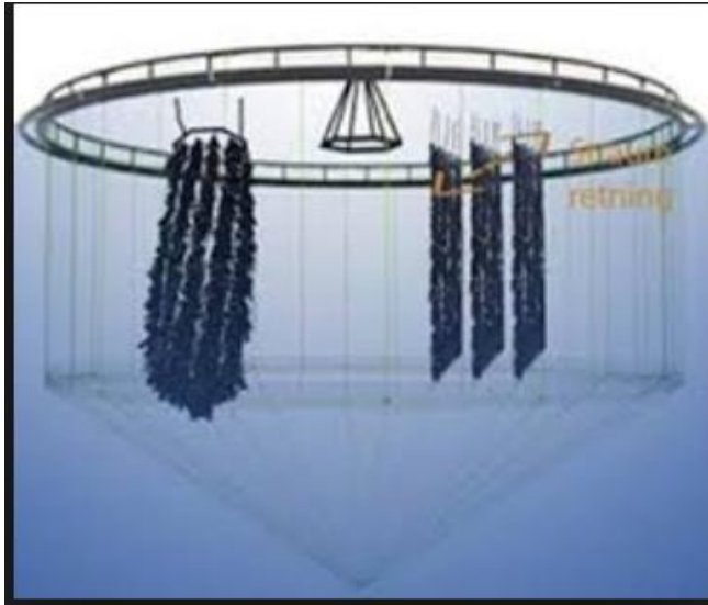
Figur 5. Forsøksmerden hadde hamsterhjul i midten for å holde opp fuglenett. Seks tau konstruert med seks remser tare dannet skjul for rensefisken. Flyteelement rundt merden tilrettelagt for båt og daglige rutiner. Dødfiskhåven var plassert nederst i noten. Hentet fra (22) s.3
