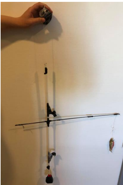
Figur 10. Rigger benyttet under forsøkene. Gummifisken var festet med snøre i den vannrette stangen, og rigger hvilte på loddet (som i figuren) når den var i vannet. Det var 6 meter snøre mellom lodd og trinse.
