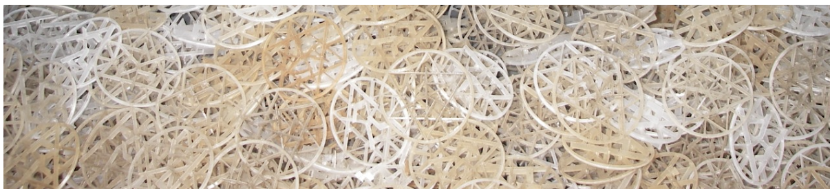
Figur 2.6: Utseendet til pakkematerialet av typen snowflakes som sjøvannstårnet i figur 2.5 er pakket med (Eggen, 2019).
