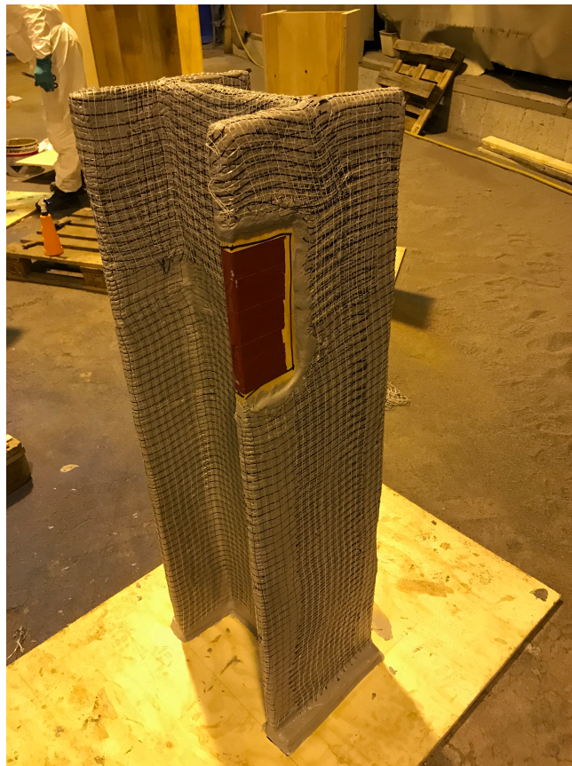
Figur 2: Bjelke påført fiberarmering [27]
