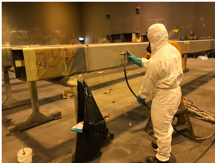
Figur 4: Illustrasjon av påførsel med spray [27]
