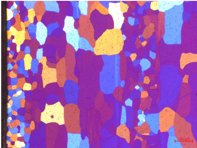
Figur 4: Kornstrukturen til legeringen kalt Al_5Mg . Det vises korn av forskjellige størrelser, noe som skyldes det som kalles kornvekst.
