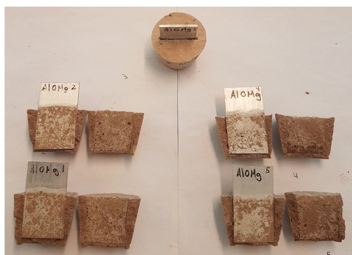
Figur 2: 5 av prøvene bestående av betong og ren aluminium. Bildet viser hvordan alle prøvene sprakk opp og delte seg. Den øverste prøven slapp taket i betongen uten at betongen sprakk opp.
