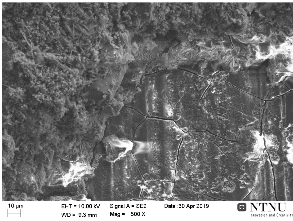
Figur 34: SEM-bilde tatt av legering 6082-530 etter uttrekkstest. Figuren viser både mørtel og aluminium.
