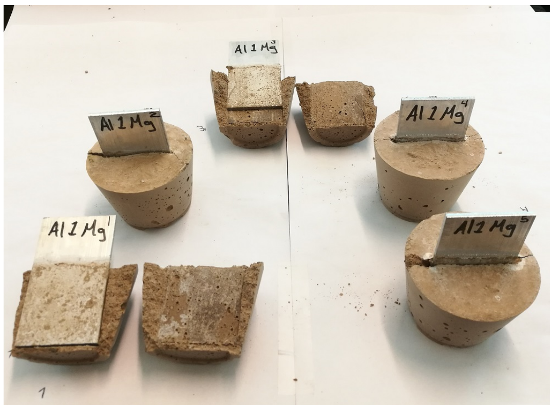
Figur 39: Bruddflatene til Al1Mg uten riller etter uttrekk.
