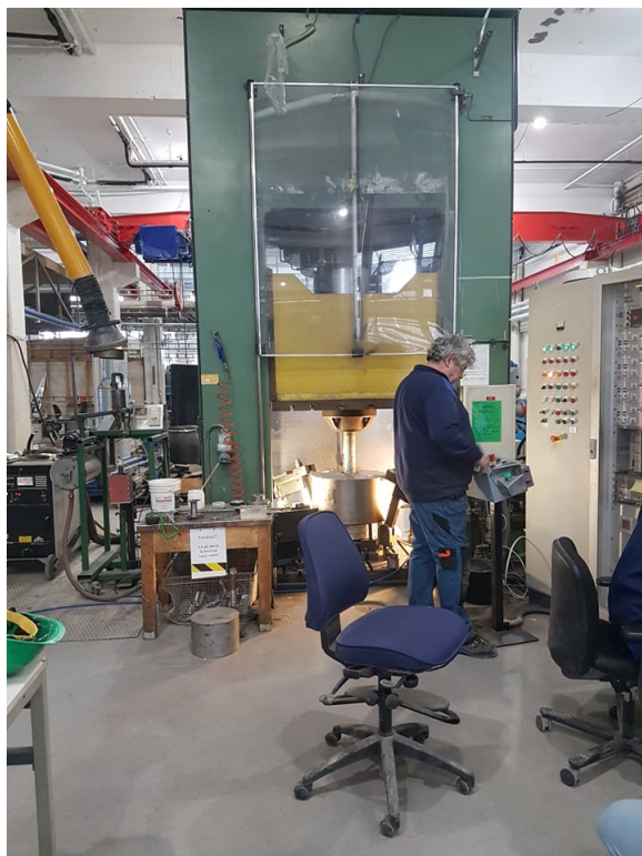
Figur 10: Ekstruderingspressen montert i øvre etasje.
