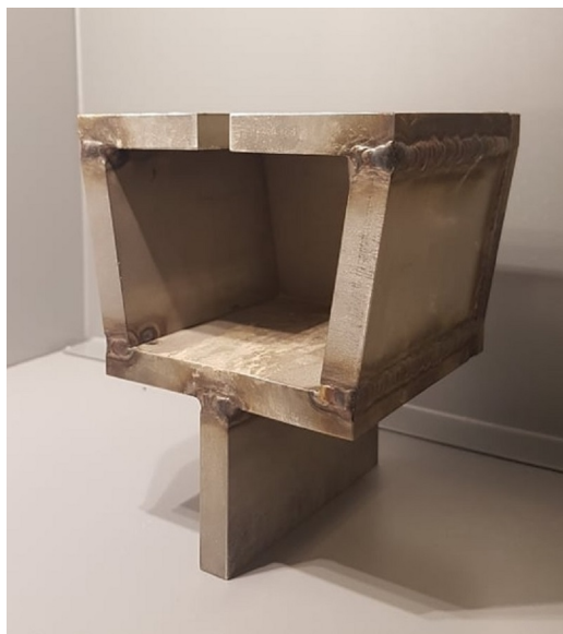
(a) Innretningen som ble konstruert for å holde prøven festet under uttrekkstest.
