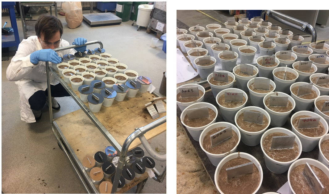
(a) Prøver med og uten lokk. Bildet er tatt ved innstøping. To lokk tredd på aluminiumsprøver kan observeres til høyre på brettet. (b) Prøver uten lokk. Bildet er tatt en dag etter innstøping.
