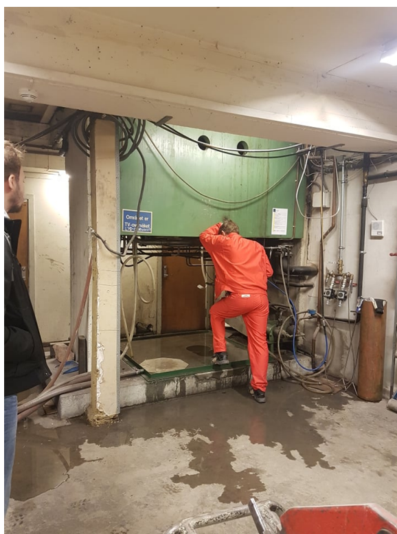
Figur 11: Profilen ble ekstrudert og kom ut i etasjen under. Profilen ble senket direkte ned i vann.
