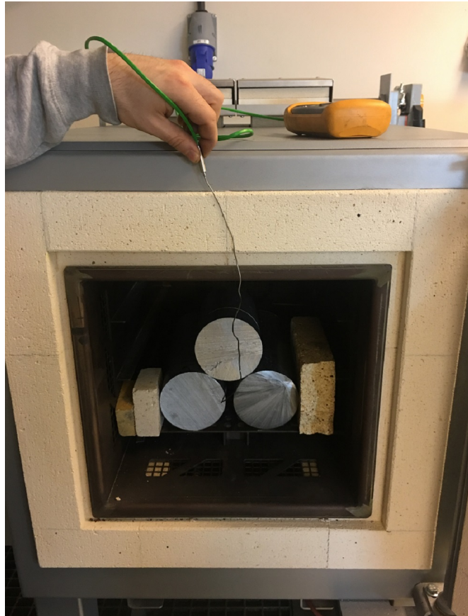
Figur 9: Bolter i ovn med termokobling i midten av de tre boltene.
