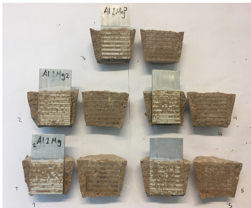
Figur 41: Bruddflatene til Al1Mg med riller etter uttrekk.
