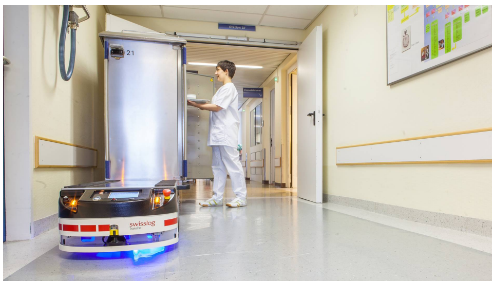
Figur 2.1: Illustrasjonsbilde av AGV (Swisslog, 2019)
