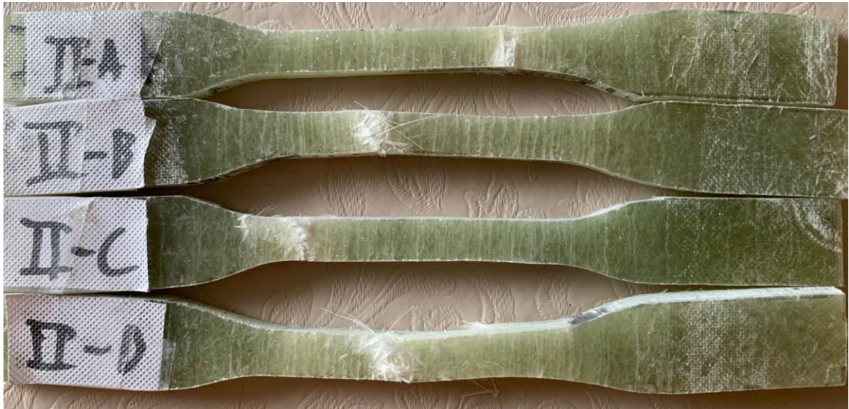
Figur 10-5: Bruddmønstre på prøvene II-A-D sett ovenfra. Foto: TS
