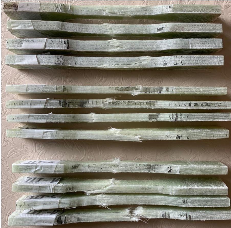
Figur 10-7: Bruddmønstre på prøvene I-III A-D sett fra siden. I-A er øverst i bilde, deretter I-B, I-C, I-D, II-A osv. Man kan se den samme tendensen som i de større prøvene omtalt tidligere i oppgaven: Prøve I har noe som minner om en slags glidning mens II og III er «renere» brudd. Det er allikavel mindre forskjell i bruddene i disse prøvene enn de større. Foto: TS
