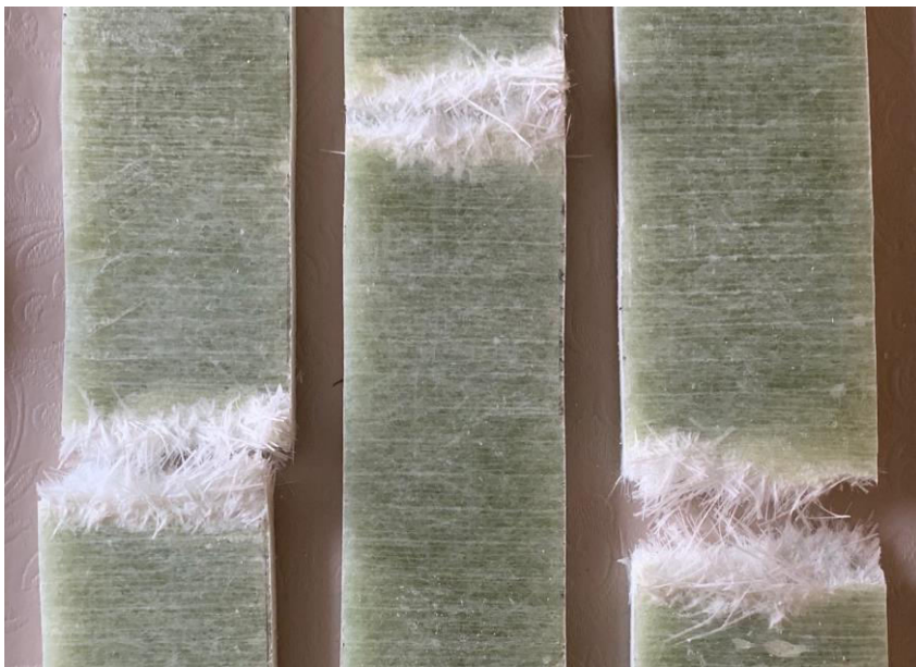
Figur 4-3: Session II-1-3 etter strekktest. Bruddene har gått på tvers av lengderetningen og fibrene er revet helt eller delvis av. Foto: TS
