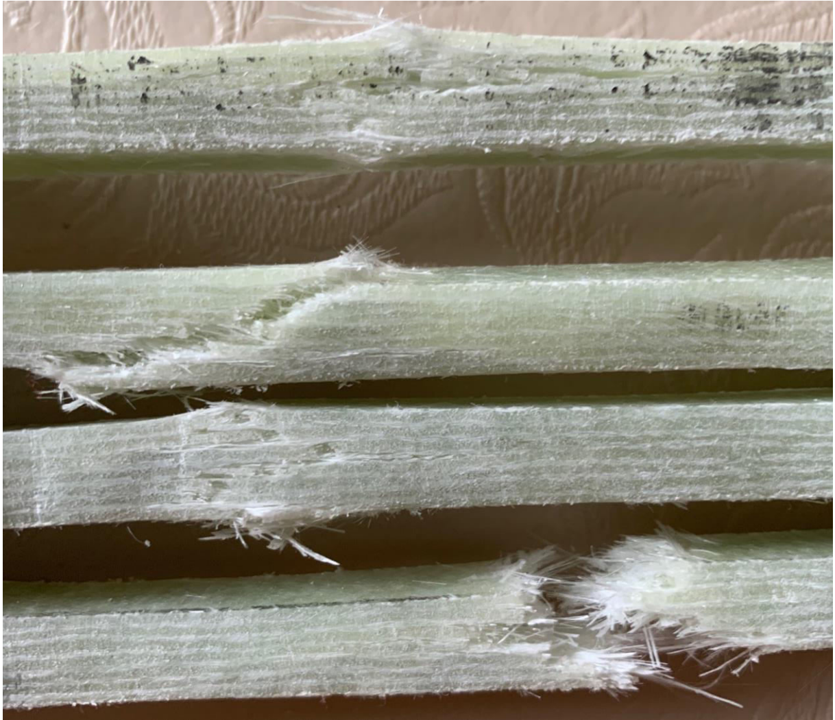
Figur 10-13: Nærbilde av bruddene på prøvene III-A-D sett fra siden. III-A er øverst i bildet, deretter III-B osv. Foto: TS
