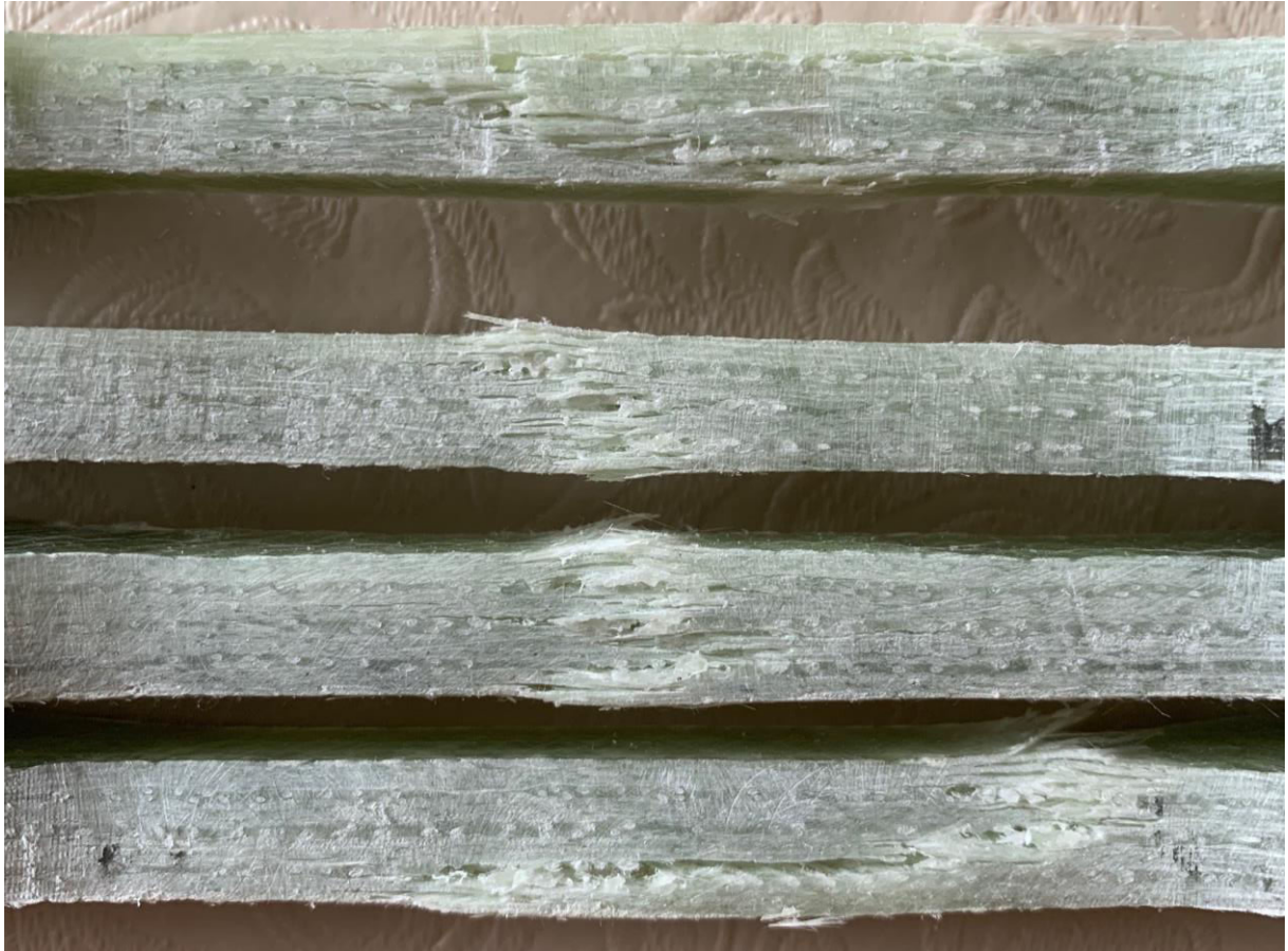
Figur 10-11: Nærbilde av bruddene på prøvene I-A-D sett fra siden. I-A er øverst i bildet, deretter I-B osv. Foto: TS
