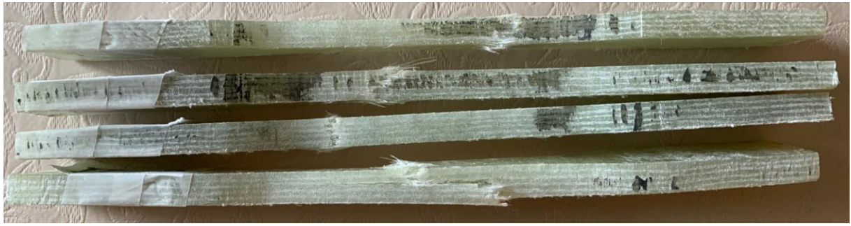
Figur 10-9: Bruddmønstre på prøvene II-A-D sett fra siden. II-A er øverst i bildet, deretter II-B osv. Foto: TS
