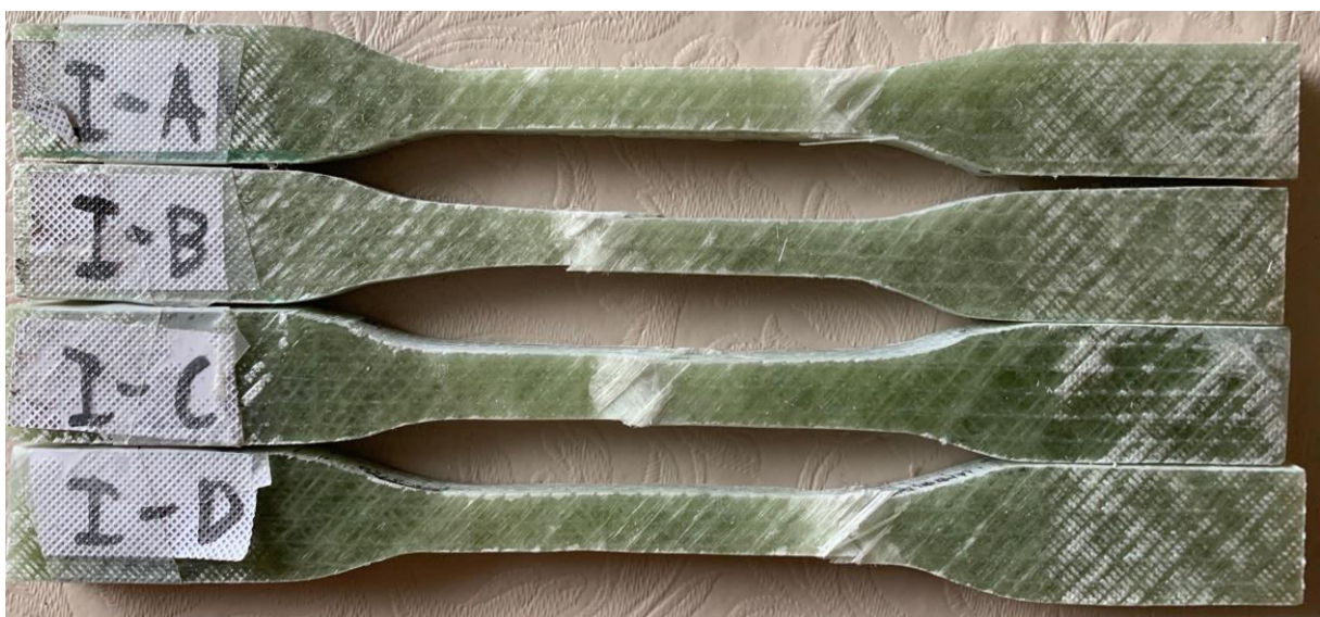
Figur 10-4: Bruddmønstre på prøvene I-A-D sett ovenfra. Foto: TS
