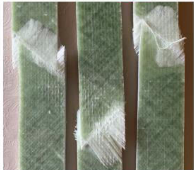
Figur 3: Tre prøver fra en plate. Her ser man tydelig fibrenes bidrag og lengde.
