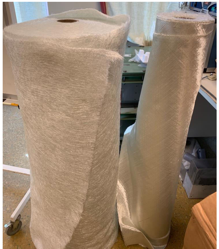
Figur 10-2: Ruller av glassfiber. Til høyre er fibre lengre og vevd sammen i et mønster. Til venstre er det kortere fibre tilfeldig orientert.
