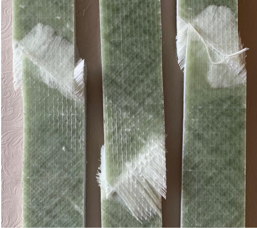
Figur 4-2: Session I-1-3 etter strekktest. Bruddene har gått langs fiberretningen. Fibrene er bortimot intakte og det har skjedd en slags glidning i materialet. Foto: TS
