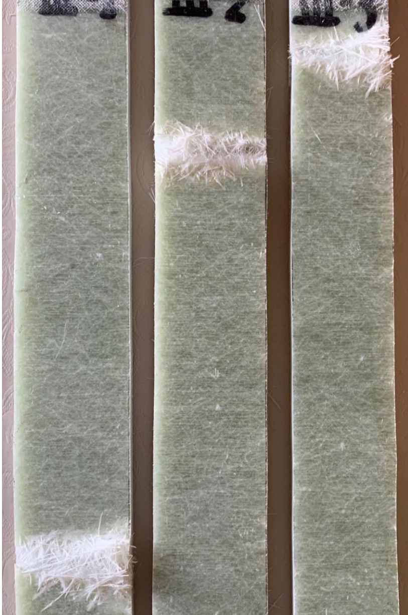
Figur 4-4: Session III-1-3 etter strekktest. Samme bruddmekanisme som session II med brudd på tvers av lengderetning og fibre er revet helt eller delvis av. Foto: TS
