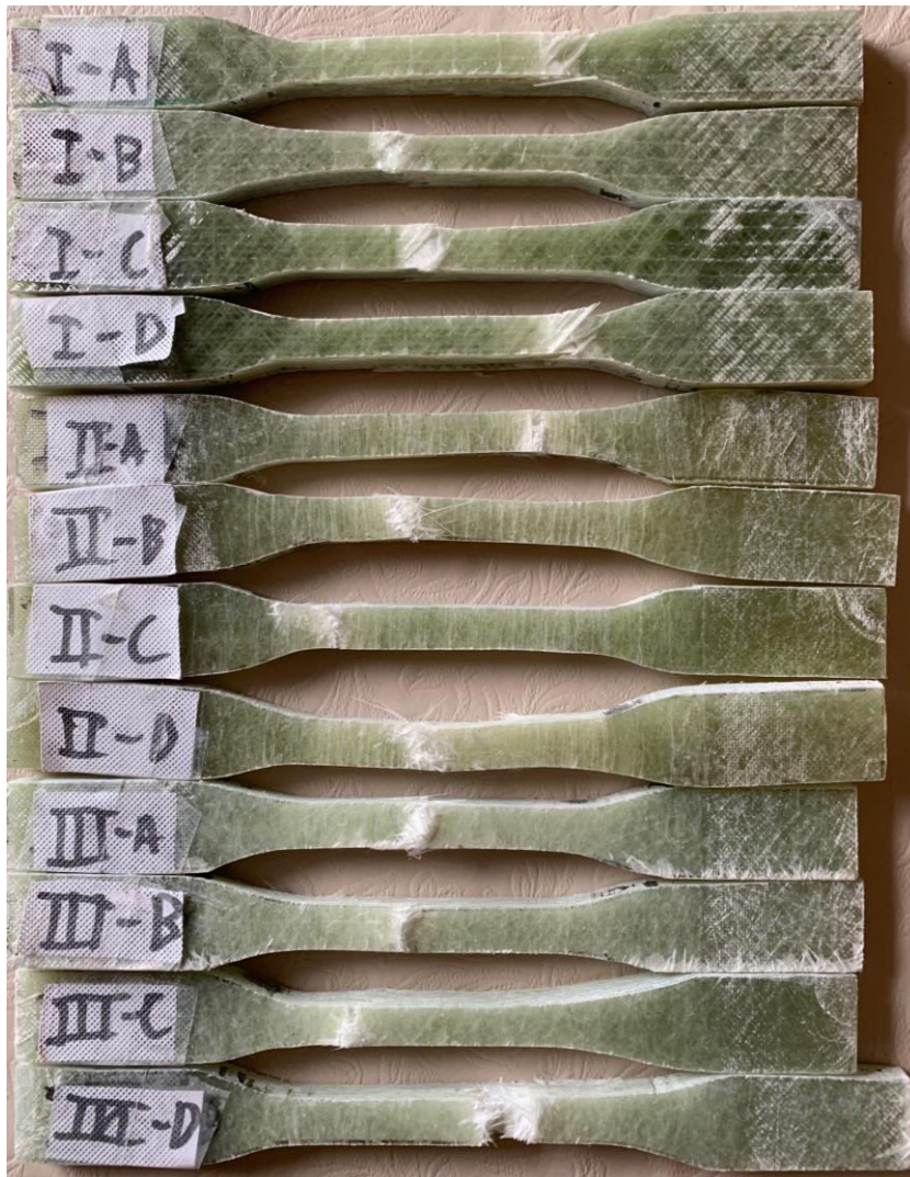
Figur 10-3: Bruddmønstre på prøvene I-III A-D. Foto: TS
