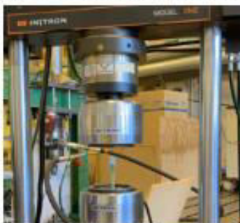
Figur 2: Strekkmaskin av typen Instron 1342, som har en kapasitet på 100 kN.
