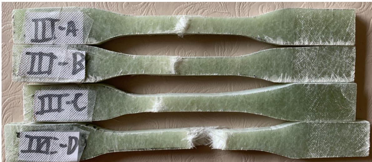
Figur 10-6: Bruddmønstre på prøvene III-A-D sett ovenfra. Foto: TS
