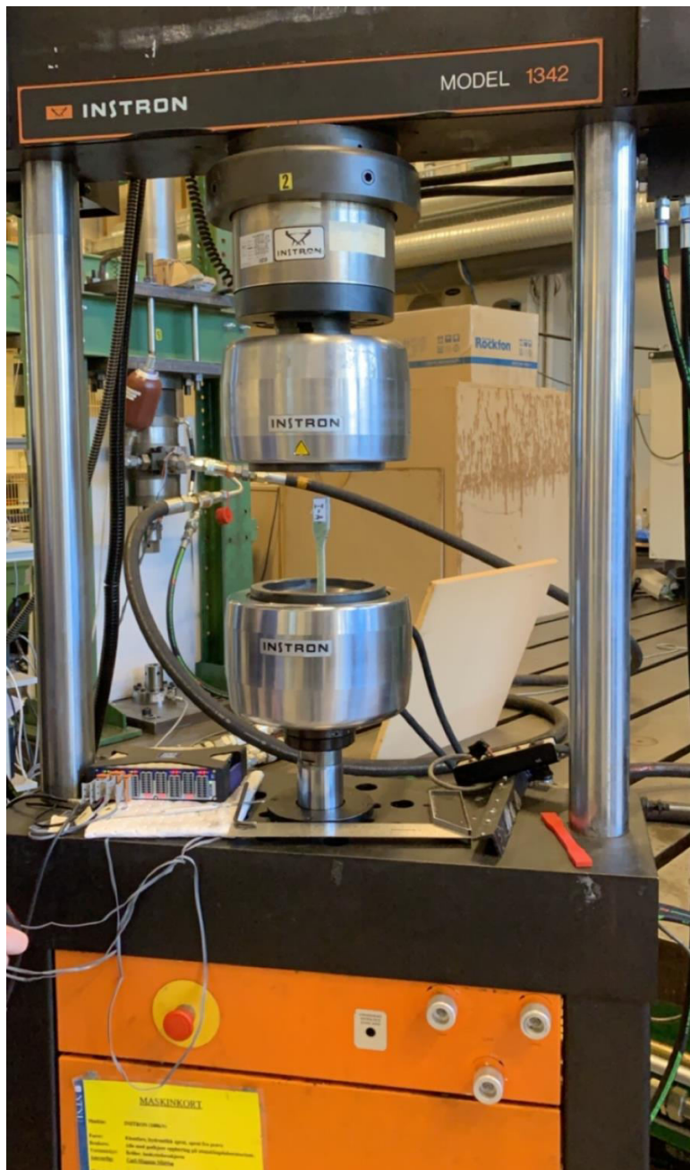
Figur 3-1: Strekkmaskinen Instron Model 1342 gjøres klar til bruk. Denne har en kapasitet på 100 kN. Foto: TS
