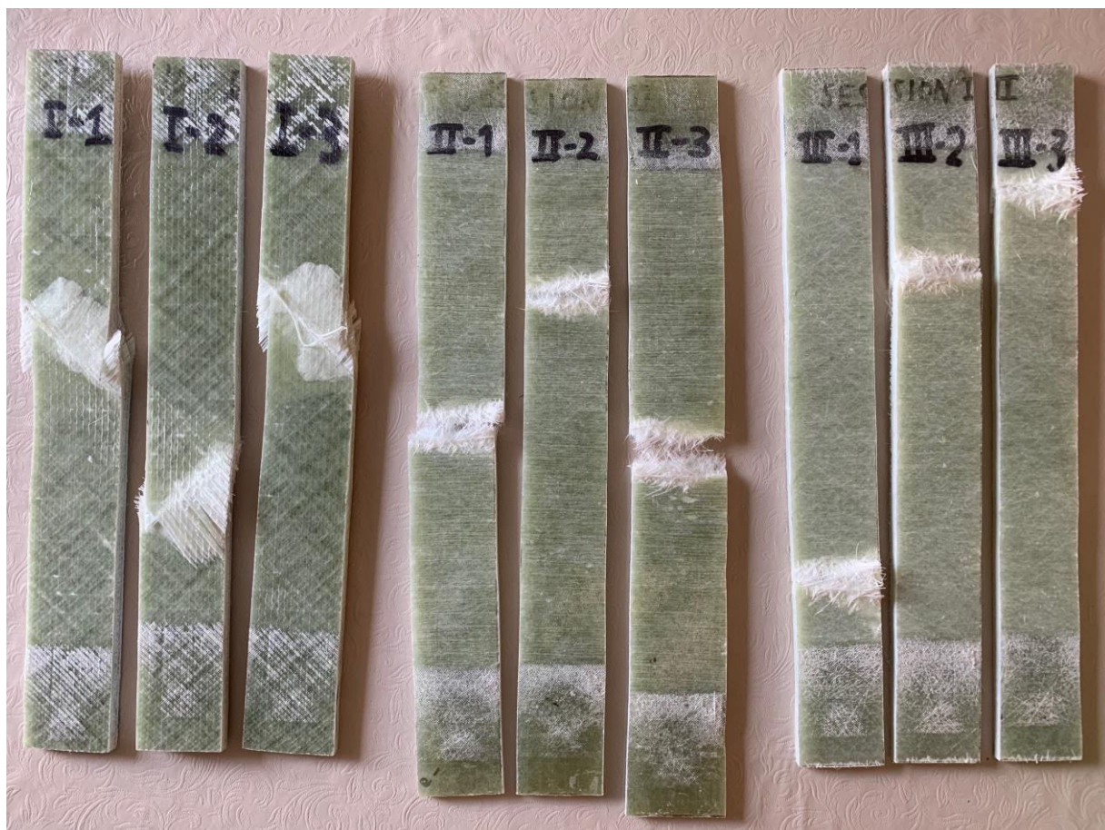
Figur 4-1: Slik så alle de større prøvene (1-3) ut etter testing. En kan se at det er forskjellige bruddmønstre: Session I har blitt deformert og en kan tydelig se at bruddet har gått langs fibreens retning, 45/45. Session II og III har gått til "renere" brudd i lengderetning og fibre er revet helt eller delvis av. Foto: TS
