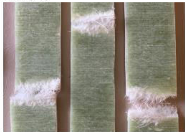
Figur 4: Kortere fibre, tilfeldig orientert etter strekkretning.
