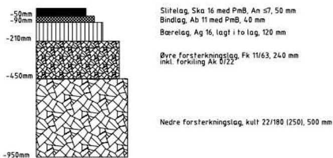
Figur 9: Planlagt vegoppbygning i tunnelen.
